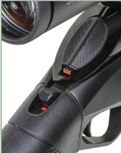
**DIE SICHERUNG** hat zwei Stellungen. In der hinteren sind der Abzug und die Kammer gesperrt. Die Kammer lässt sich auch gesichert mit einer separaten Entsperrtaste öffnen. Ein roter Schlagbolzenfortsatz zeigt den Spannzustand an.
