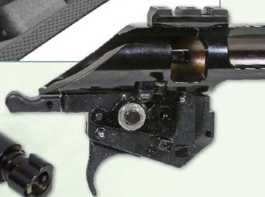
**DER ABZUG** ist als einstellbarer Feinabzug ausgeführt und löste ab Werk trocken bei 700 g Widerstand aus.
