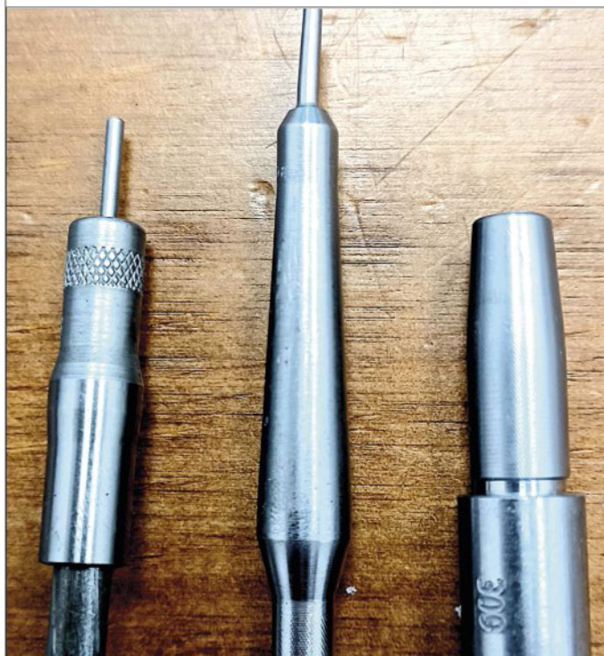
Voorbeelde van expander mandrels of expander buttons , soos dit in Engels bekend staan.
