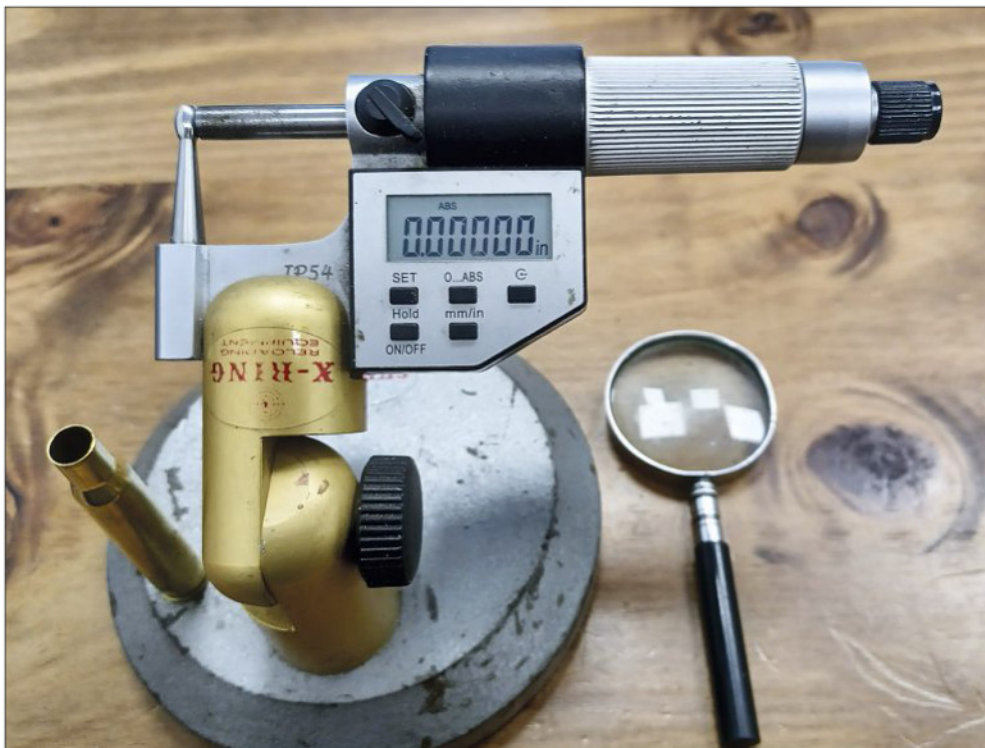
'n Elektroniese buismikrometer, ook bekend as 'n balmikrometer, wat gebruik word om doppies se wanddiktes te meet.
