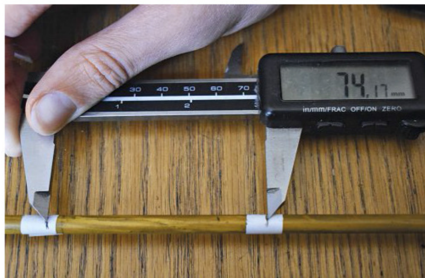
Meting van die maksimum lengte op die gemerkte skoonmaakstok.
