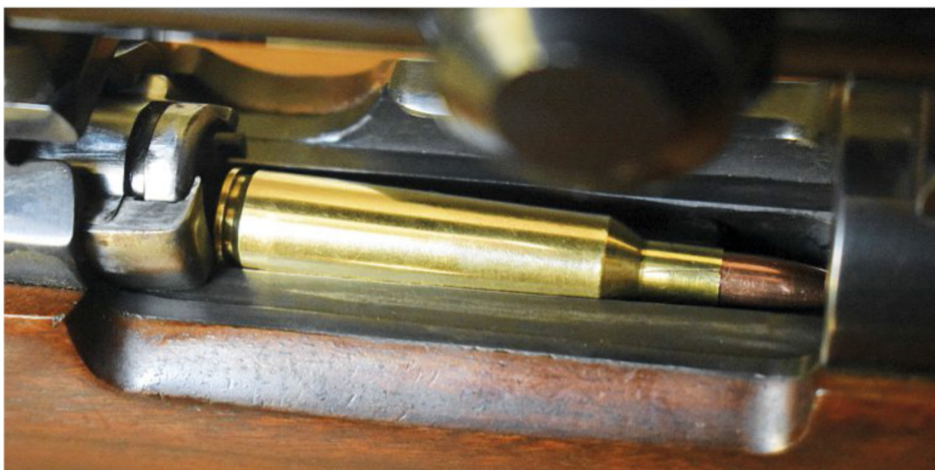
’n Voorbereide doppie met lospassende koeëlpunt, gereed om gekamer te word.
