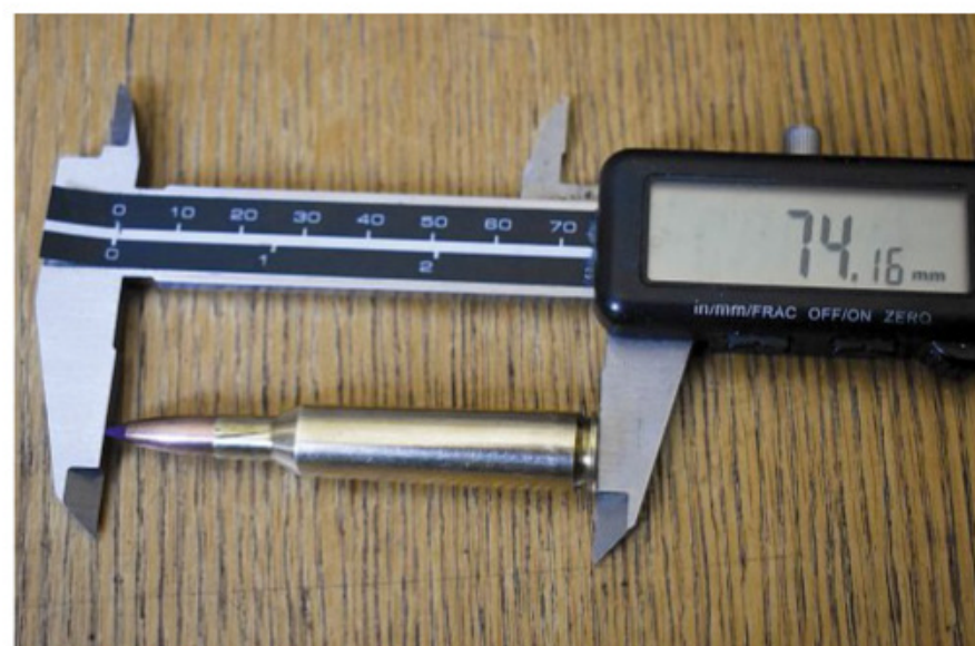
'n Patroon met 'n koeël wat teen die lande kamer, se maksimum totale lengte word gemeet – die "meesterpatroon".
