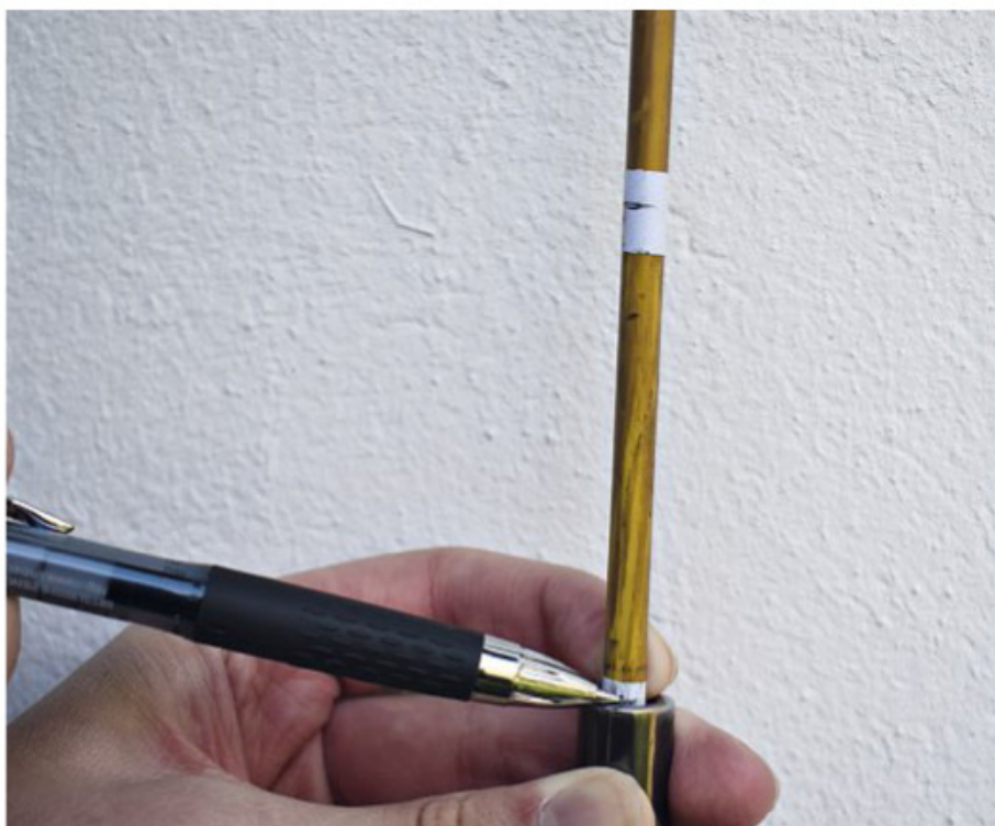
Maksimum patroonlengte gemerk vir meting met die skoonmaakstokmetode.
