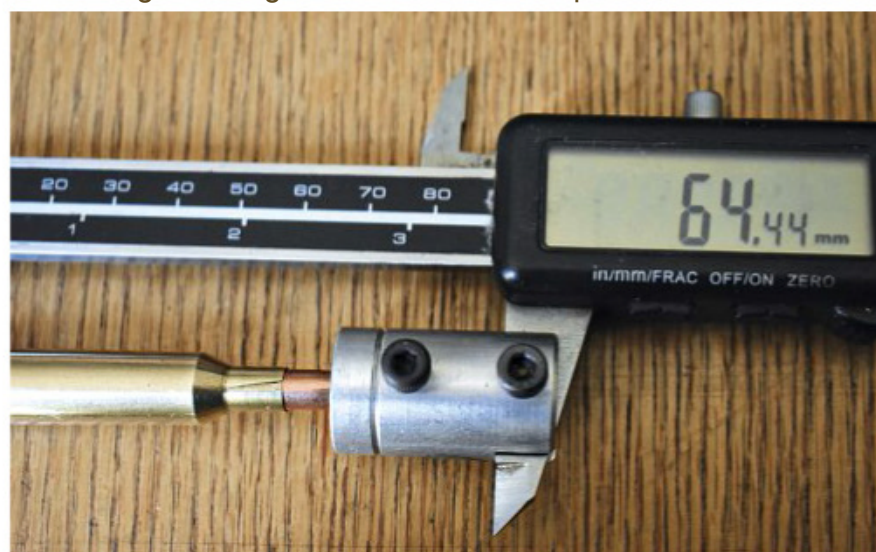
Die "meesterpatroon" se lengte van die ogief-raakvlak af gemeet (ogief-lengte waarde).
