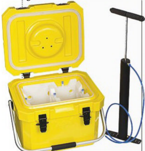
Die handpomp wat gebruik word met die pypie om die vakuum binne-in die koelhouer te vorm.
