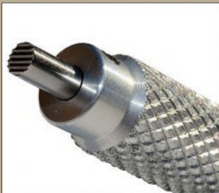
Dié toerusting word gebruik om residu op die bodem van die slagdopkamer skoon te maak.
