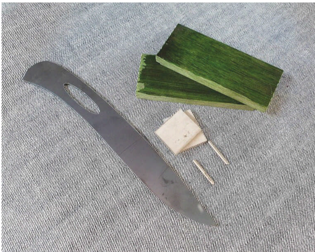
Die basiese komponente van hierdie tipe mes – vlekvrystaal- en bolsterblokkies, hout vir die handvatsel, en vlekvrystaal-penne.
