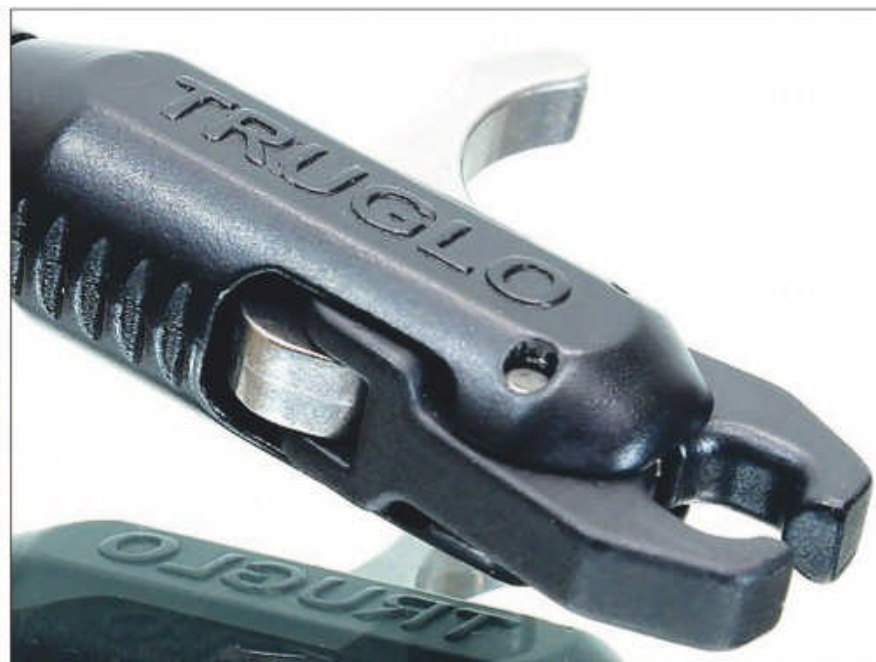
BO: Die voerpunt van die meganiese sneller wat aan die snaar haak, met die sneller wat gedruk word sodat die knipers oopmaak en die snaar loslaat. ONDER: 'n Stabiliseerder wat aan die voorkant van 'n boog vasgeskroef is
