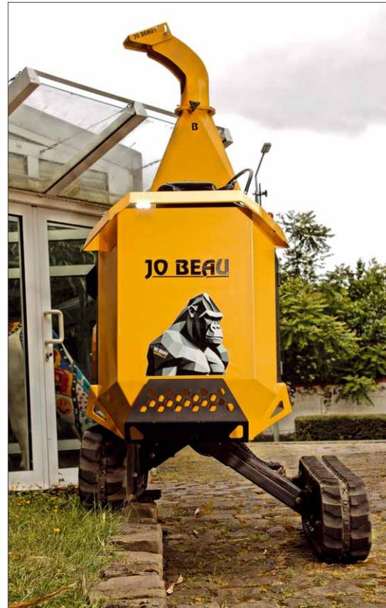
Und hoch das Bein! Höhenunterschiede im Gelände werden einfach per Hydraulik ausgeglichen
