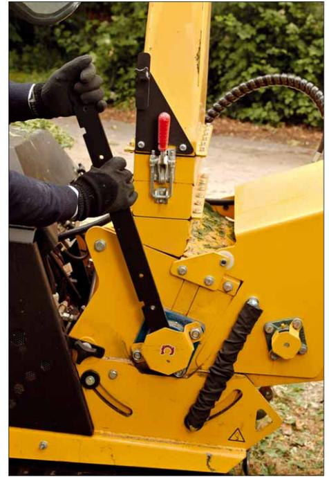
Wenn's wirklich mal klemmt kommt der Große Schraubenschlüssel zum manuellen Rückdrehen der Hacktrommel zum Einsatz
