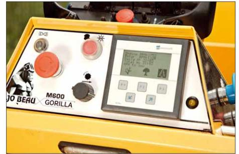
Hauptpanel mit Betriebsstundenzähler, Einschalter für die Hacktrommel und Geschwindigkeitsregelung der Einzugswalze
