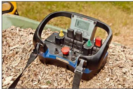
Die Funkfernbedienung kann bei der Nutzung um den Hals getragen werden. Wird sie nicht benötigt gibt es oben auf dem Einwurfschacht zwei Aufhängungen
