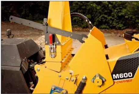
Zum scheiden von kleinem Schnittgut kann die Einzugswalze mit dem Bordwerkzeug hochgeklappt werden
