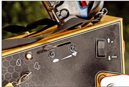
Ebenfalls seitlich befindet sich der Regler für die Motordrehzahl und das Heben und Senken des Einwurfs
