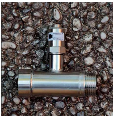
In diesem T-Stück wird der Eingangsdruck gemessen
