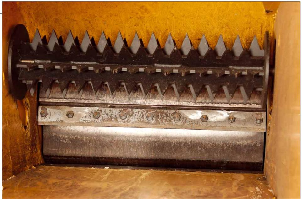
Hier ist die Action: Blick auf die Einzugswalze und die Hacktrommel mit einem der beiden Wendemesser
