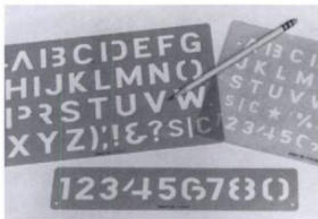
7-6. ▶ A stencil type of template.
