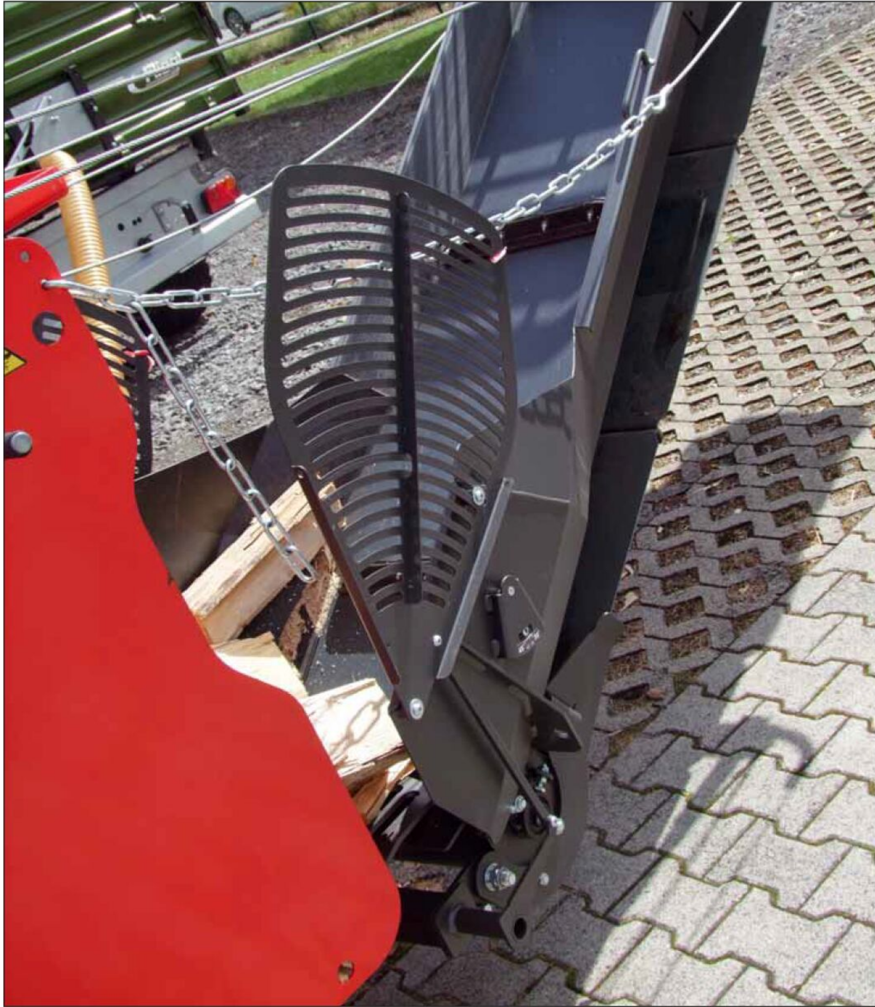
Über Seilzüge wird die Förderhöhe des Transportbandes eingestellt
