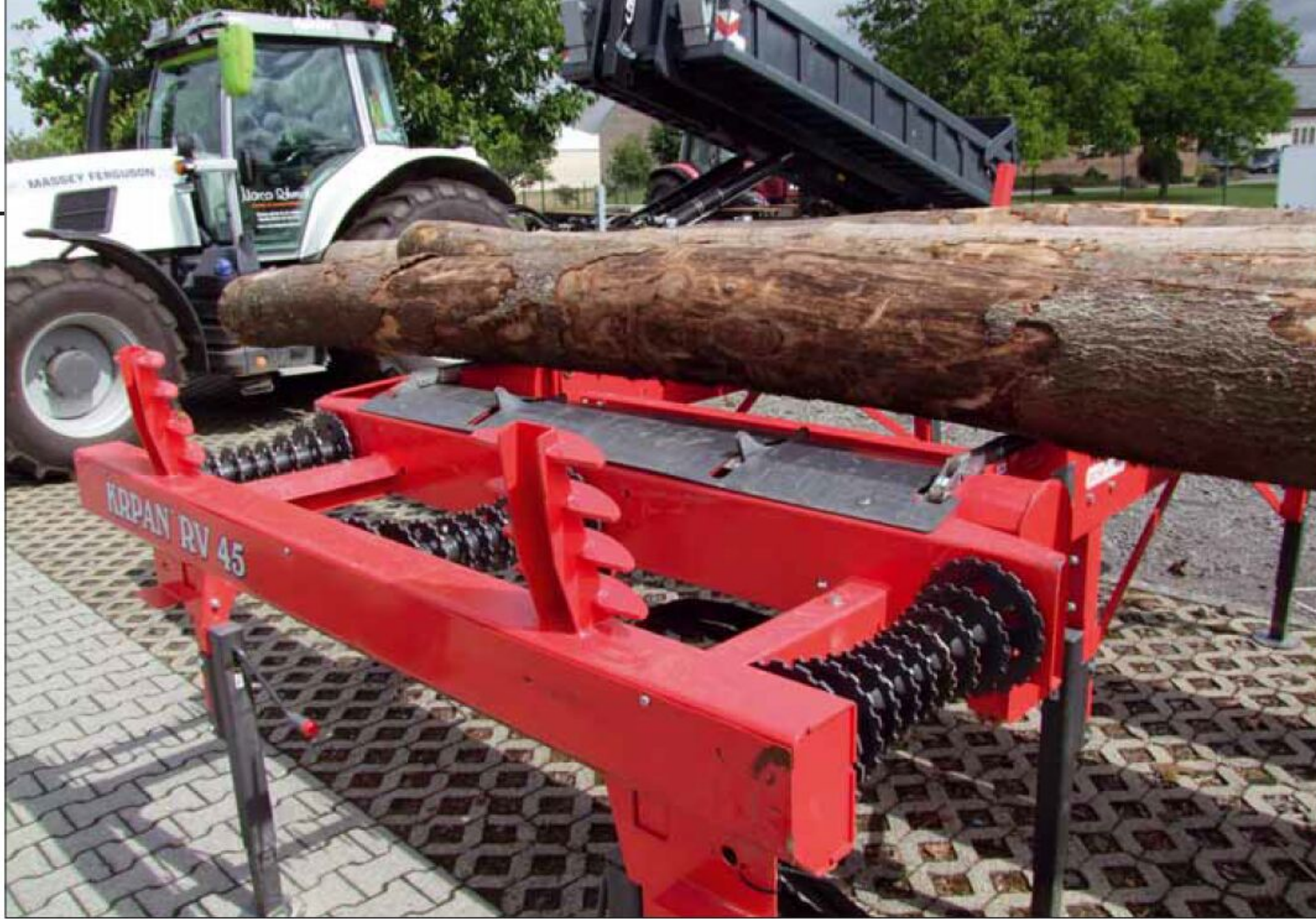
Die seitliche Bewegung des Stammholzes erfolgt durch Zahnräder
