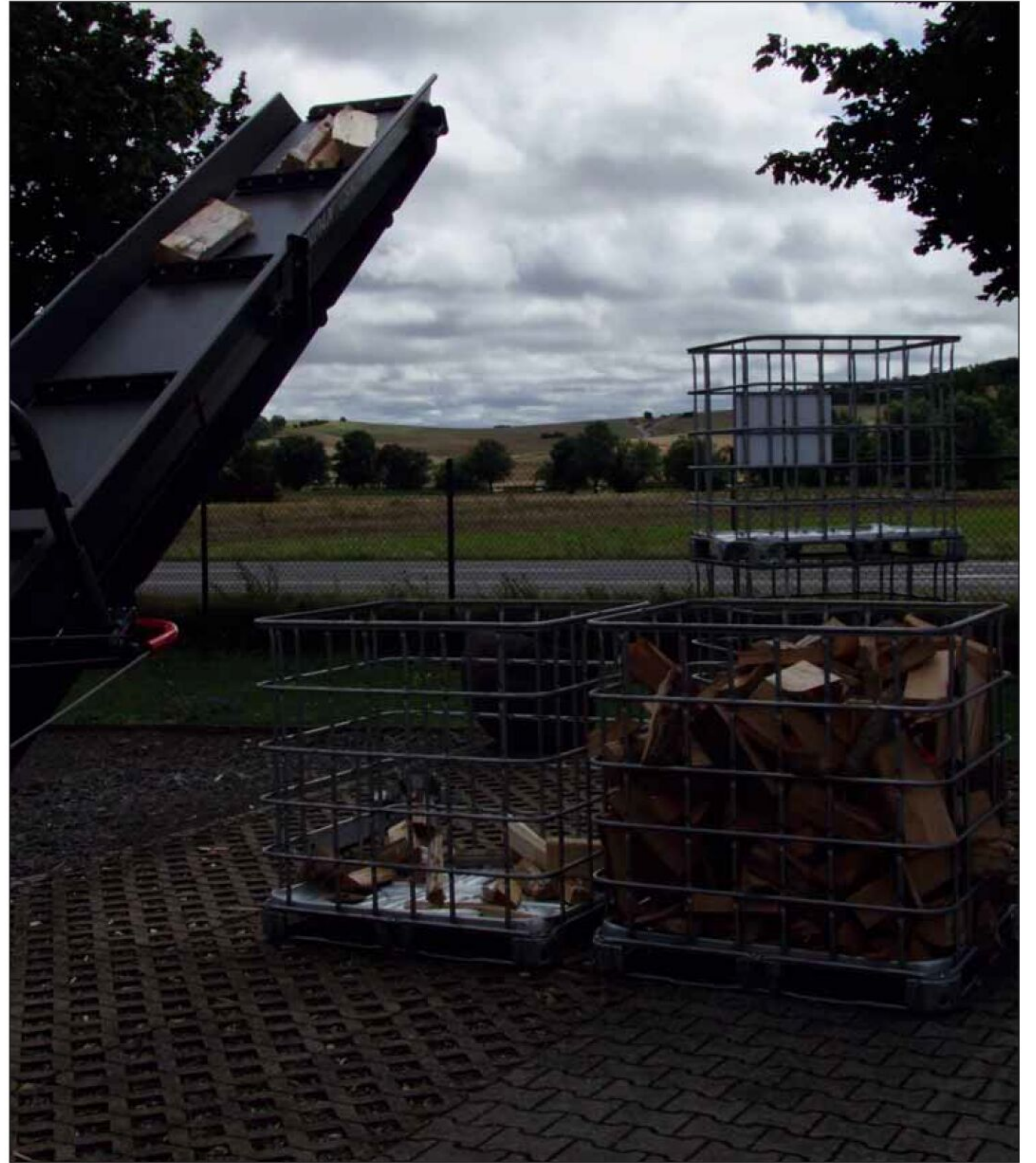
Das Transportband erreicht eine Geschwindigkeit von bis zu einem Meter pro Sekunde
