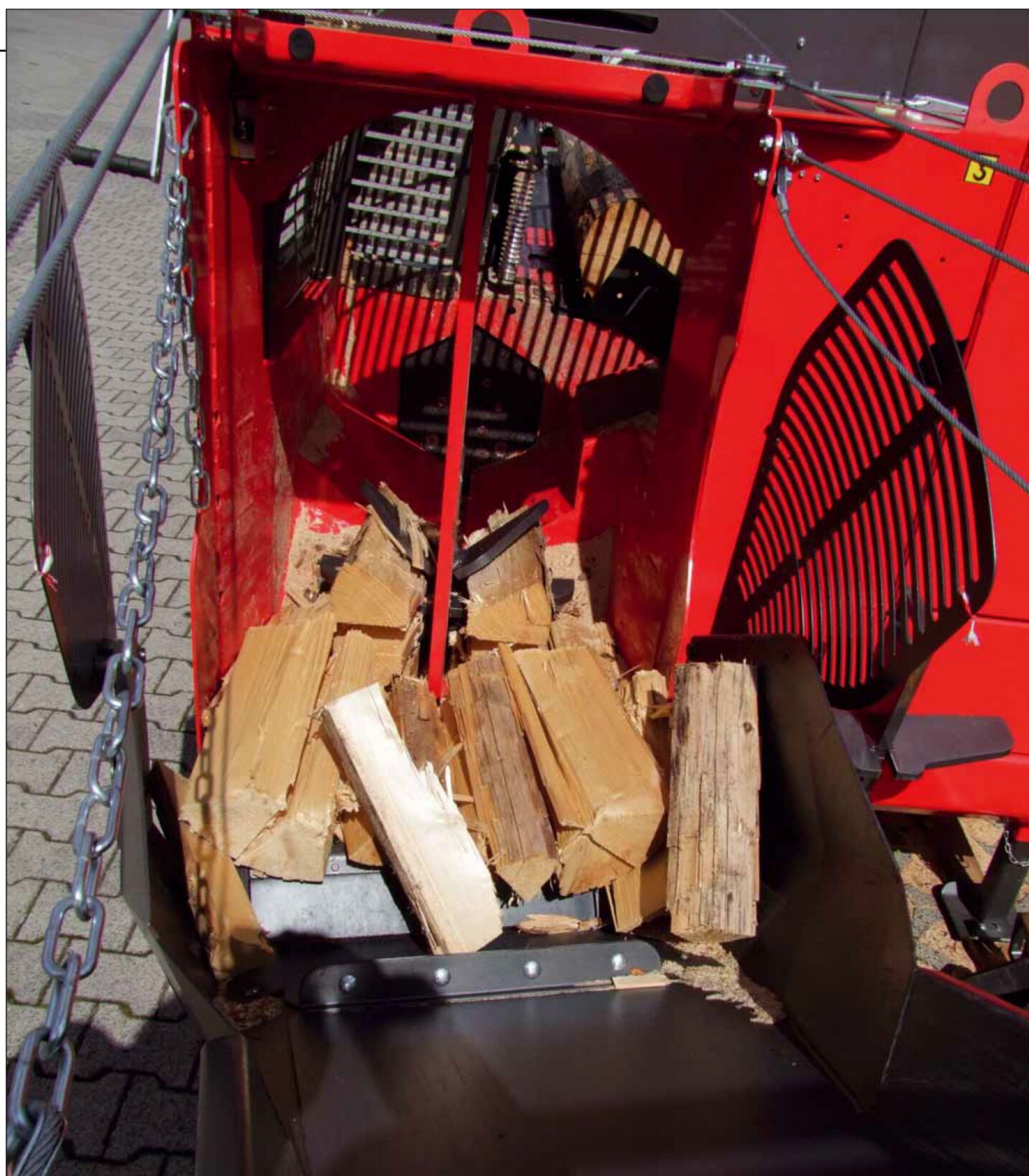
Das gespaltene Holz landet direkt zum Abtransport auf dem Förderband
