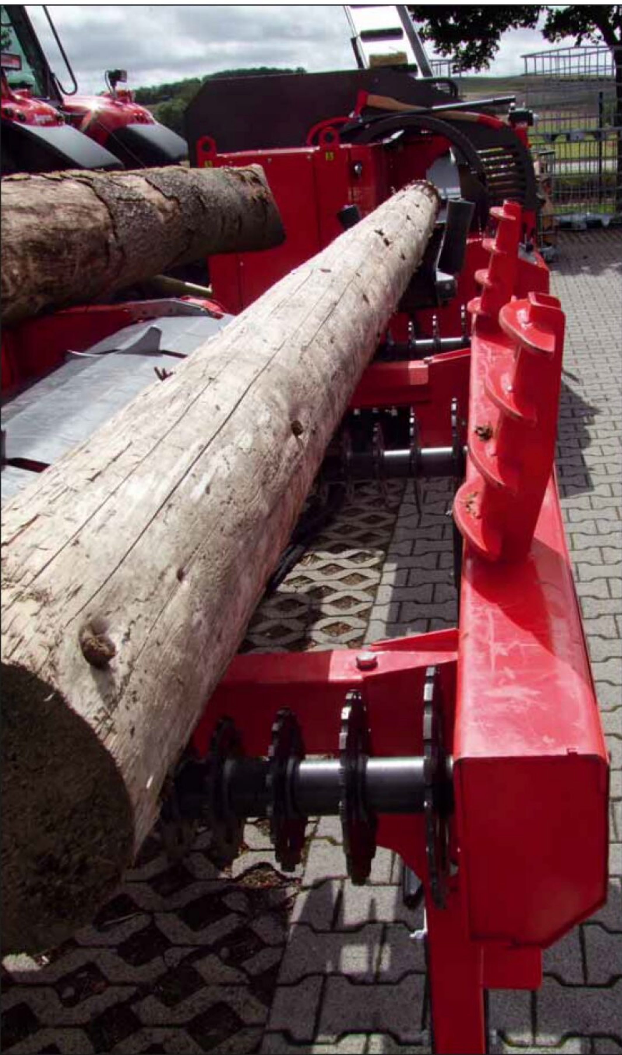
Der Zuführtisch kann Stammholz mit einem Gewicht von über vier Tonnen aufnehmen
