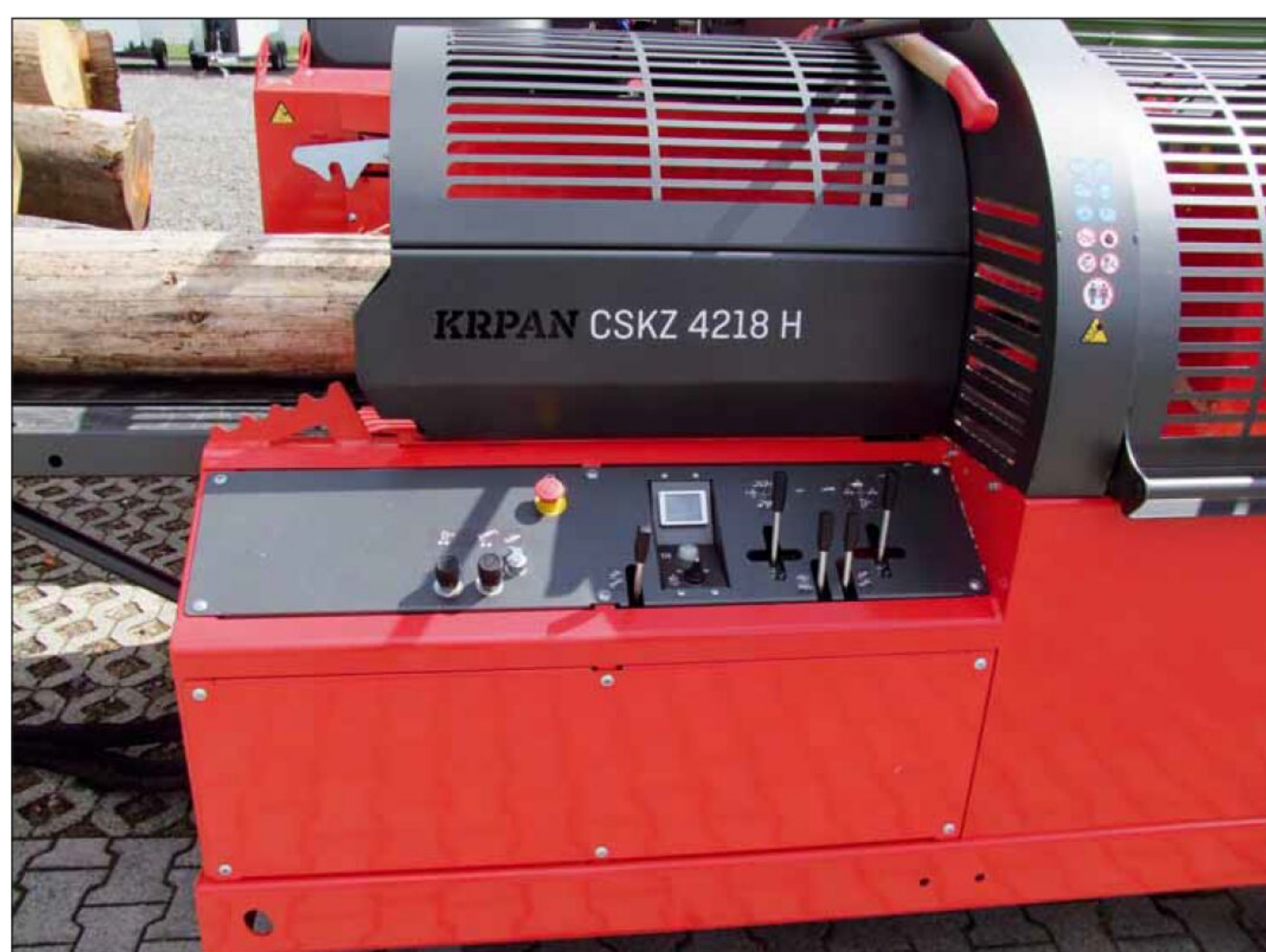
Bei der Bedienung hat der Anwender immer alle Funktionen des Sägespalters im Blick
