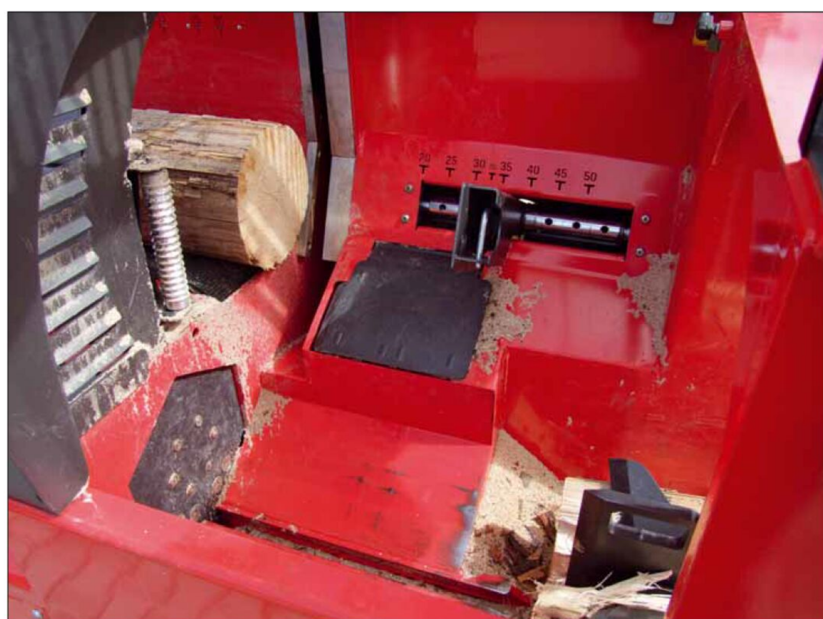
Hier sind die Längeneinstellung, der Spalt mit den (zurückgezogenen) Sägeblatt, sowie die Druckplatte (unten links) des Spalters gut zu erkennen
