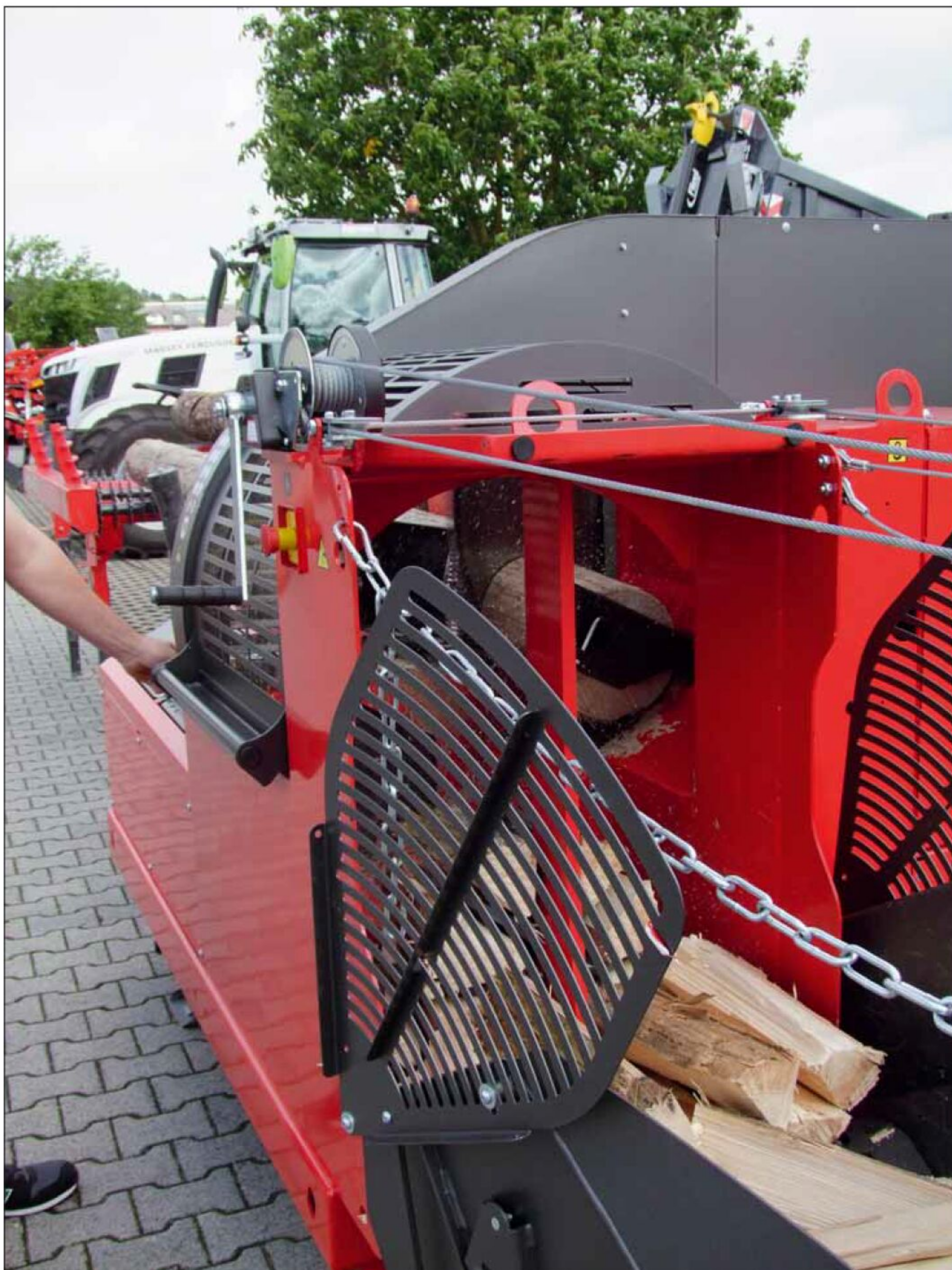
Über Seilzüge wird die Förderhöhe des Transportbandes eingestellt
