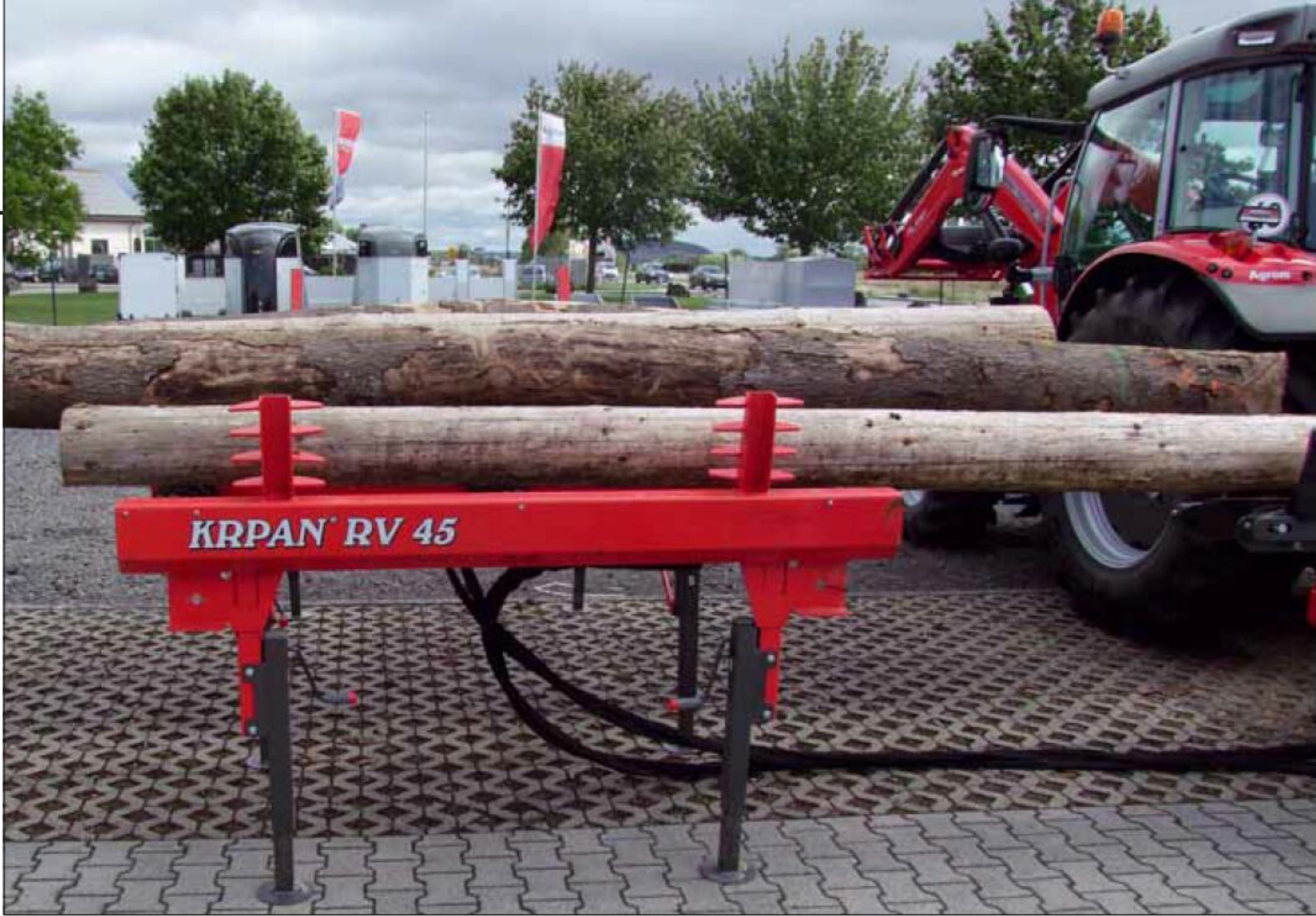
Der Zuführtisch kann Stammholz mit einem Gewicht von über vier Tonnen aufnehmen
