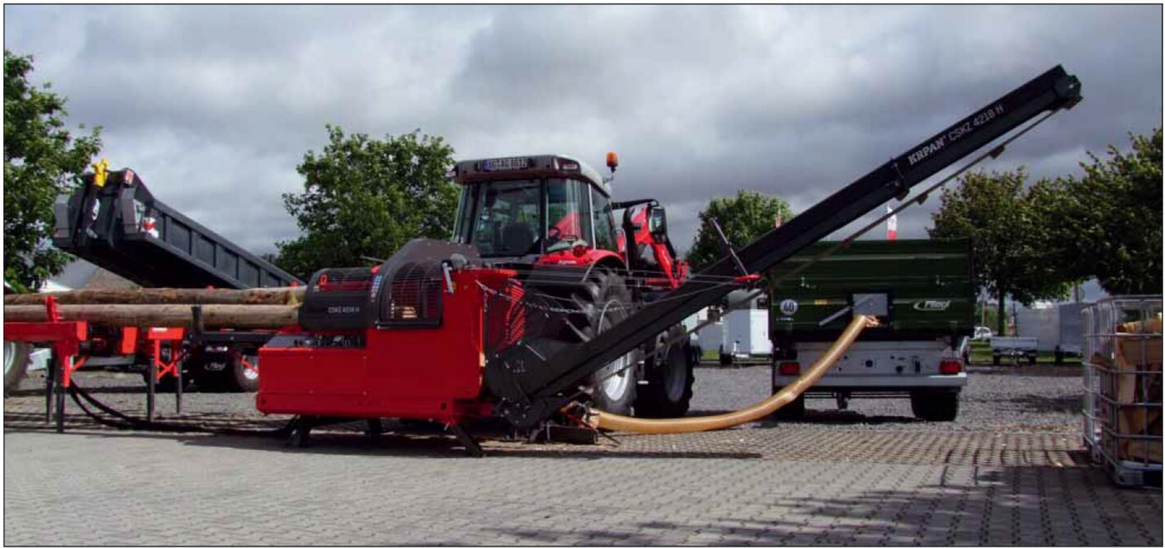
Die Sägespäne werden in unserem Test direkt auf einem Pritschenanhänger geblasen
