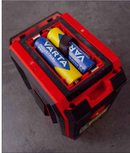
Die Batterien sind durch eine dicke umlaufende Dichtung vor Feuchtigkeit geschützt
