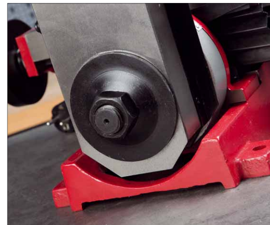
Um den Fräsmotor zur Seite zu neigen, wird die große Hauptmutter auf der Maschinenrückseite gelöst
