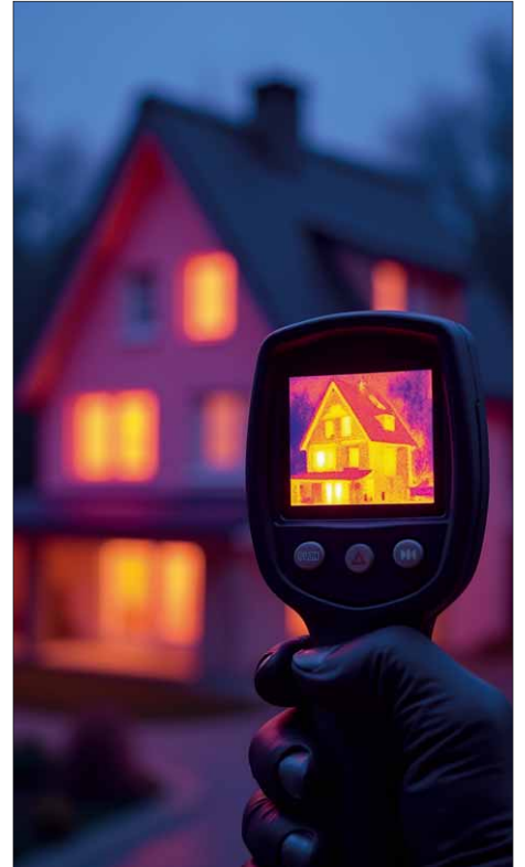
Mit Wärmebildkameras können Wärmebrücken an Gebäuden sehr einfach entdeckt werden
