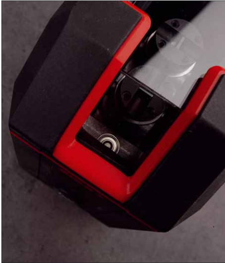
Das Präzisionslager der Pendelaufhängung ist leider nur halb zu erkennen
