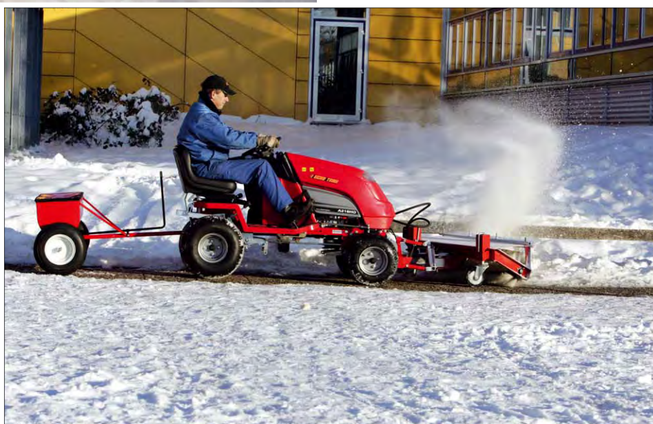
... oft können auch Aufsitzmäher zu Schneeräumern umgerüstet werden
