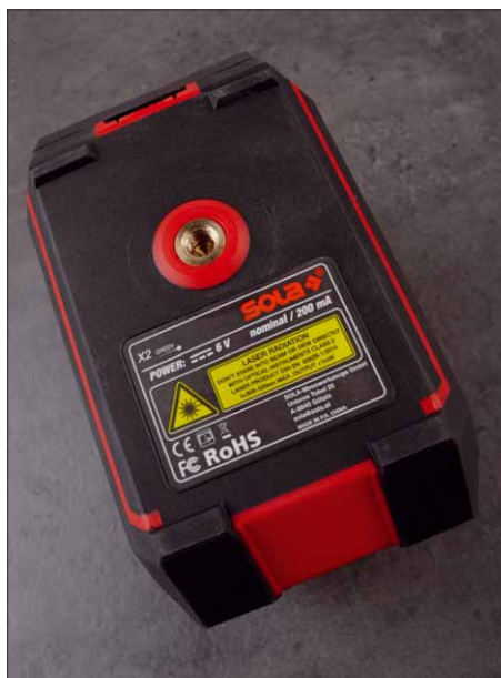
An der Geräte-Unterseite befindet sich eine Gewindehülse für die Stativbefestigung mit einem 1/4"-Gewinde
