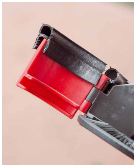
Die aufgesteckten Dichtungen lassen sich bei Bedarf schnell erneuern
