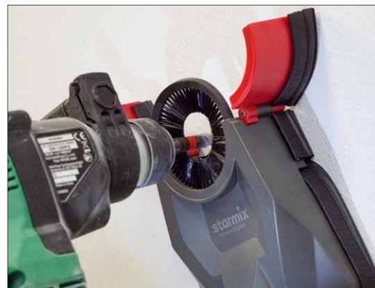
Geöffnete Flügel ermöglichen bessere Sicht auf den Bohrbereich, so können aber auch kleine Meißelarbeiten erledigt werden
