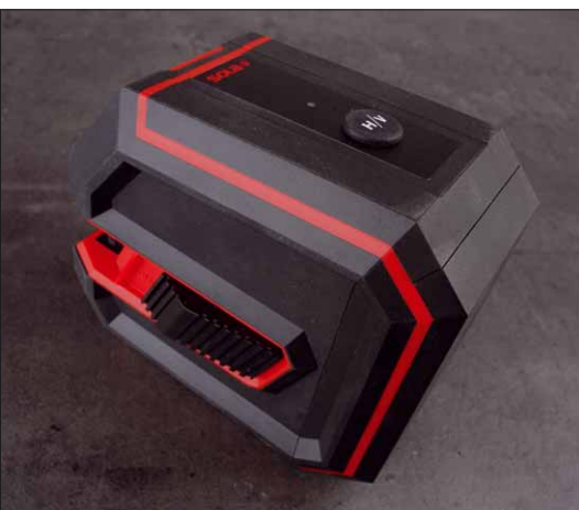
Mit dem seitlichen Schieber wird der Laser ein- und ausgeschaltet. Der Druckknopf oben schaltet die beiden Einzellaser nach Bedarf an oder aus
