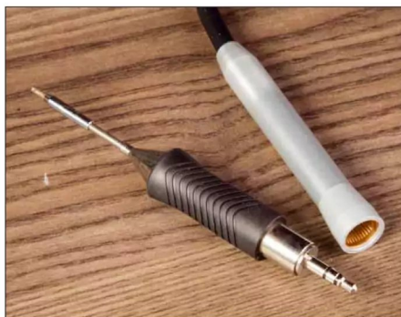
Die Lötspitzen werden über einen 3,5-mm-Klinkenstecker mit dem Griff verbunden
