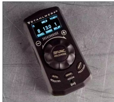
Mit der Fernbedienung können die Parameter des Helms bequem verändert werden
