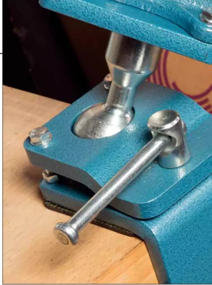
Über die beiden M6-Schrauben kann die Klemmung nachgestellt werden
