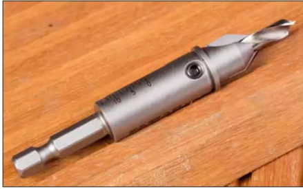
Im Set sind drei Senker, jeweils einer für den Einsatz mit 3-, 4- und 5-mm-Bohrer
