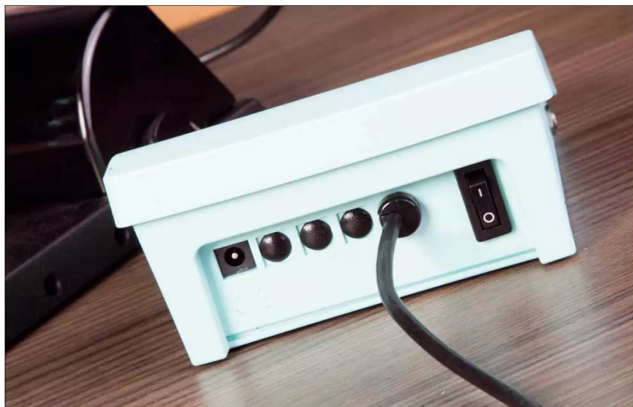
Auf der Geräterückseite befinden sich der Hauptschalter, Netzteil- und LötKolbenanschluss
