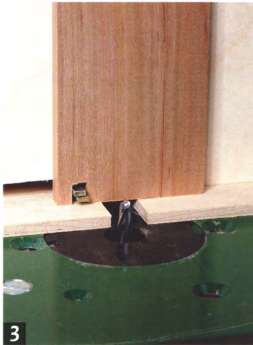
Stellen Sie die Fräserhöhe so ein, dass der Fräser ein wenig über dem Werkstück vorsteht.
