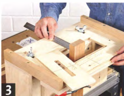
3 Spannen Sie das Werkstück ein und richten Sie den Schablonenträger ..
