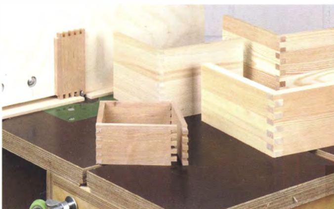
Fingerzinken sehen gut aus, sind stabil und gelingen mit Hilfe dieser Vorrichtung für den Frästisch auf Anhieb!
