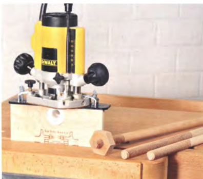
Der Fräser des Gewindefräsgerätes der Fa. Beall lässt sich nur in einer 1/4 Zoll Spann- zange betreiben.
