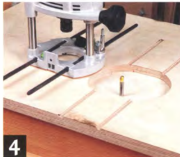
3 Mit der Anschlagschiene und einem Hohlkehlfräser fräsen Sie anschließend zwei Hohlkehlnuten für die Führungsstangen der Oberfräse.
