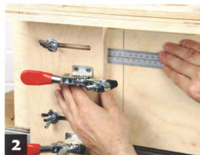
2 Danach richten Sie den Anschlag zur Mittellinie auf die halbe Holzbreite aus.
