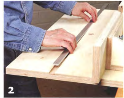
2 Die Alu-Flachstange muss sich spielfrei in der Nut hin- und herschieben lassen.
