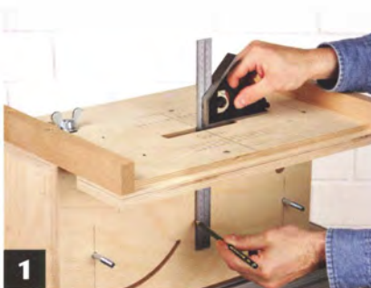
1 Zeichnen Sie sich zuerst eine präzise Mittellinie auf die Frontplatte.
