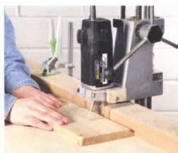
192 Stationäres Fräsen auf einem Bohrständer
