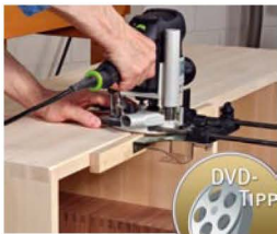
64 Arbeiten mit dem Parallelanschlag
