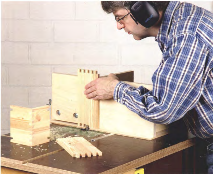
Fingerzinken sehen gut aus, sind stabil und gelingen mit Hilfe dieser Vorrichtung für den Frästisch auf Anhieb!
