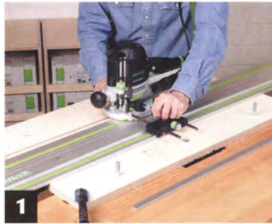
1 Fräsen Sie mithilfe einer Führungsschiene eine 20 mm breite und 6 mm tiefe Nut ein.
