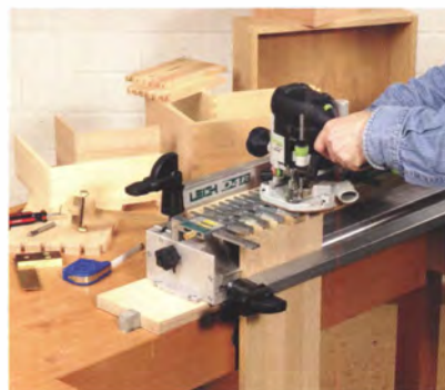
Für das Zinkenfräsgerät der Fa. Leigh benö- tigen Sie eine Kopierhülse mit 11,11 mm Durchmesser.
