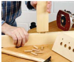
144 Runddübel mit der Oberfräse einbohren – die Dübelerschab- lone
