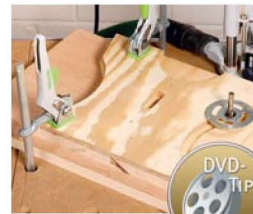
76 Fräsen nach Schablonen mit Kugellager und Kopierhülse
