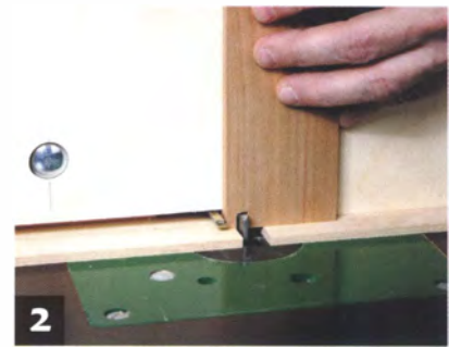
Zum Einstellen der Metallfinger fräsen Sie dann in ein Restholz einfach eine durchgehende Nut.
