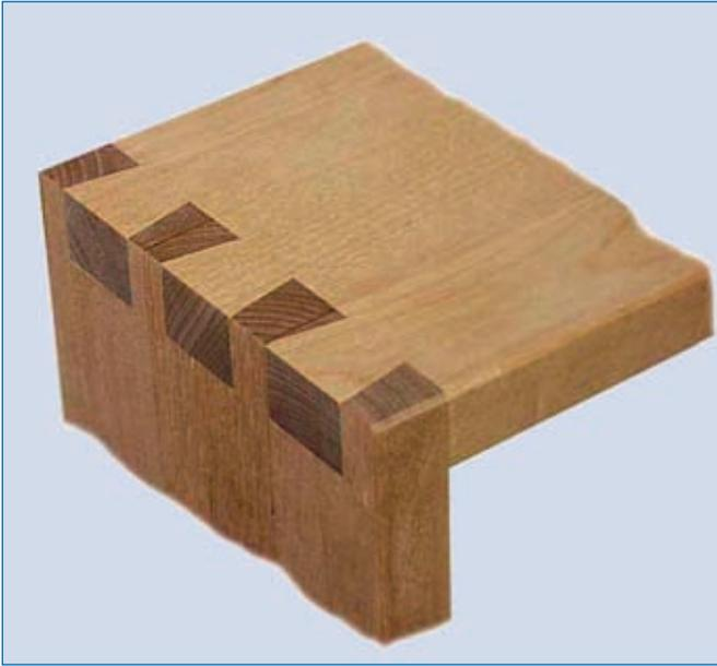
**Abb. 4.6.3:** Die offene Schwalbenschwanzverbindung – die Königsdisziplin in der Holzbearbeitung. Quelle [3]
