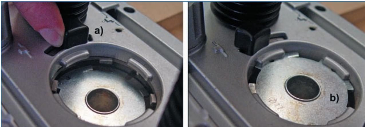
**Abb. 3.2.1:** Die *SDS*-Funktion der Oberfräse POF 1400 ACE von Bosch ermöglicht das mühelose Einsetzen und Entfernen der Kopierhülse: a) Wenn man den Entriegelungshebel betätigt, kann man die Kopierhülse einsetzen. Sobald man den Entriegelungshebel loslässt, sitzt die Kopierhülse da, wo sie hingehört – siehe b). Dank dieses Bajonettverschlusses ist keine weitere Zentrierung erforderlich.
