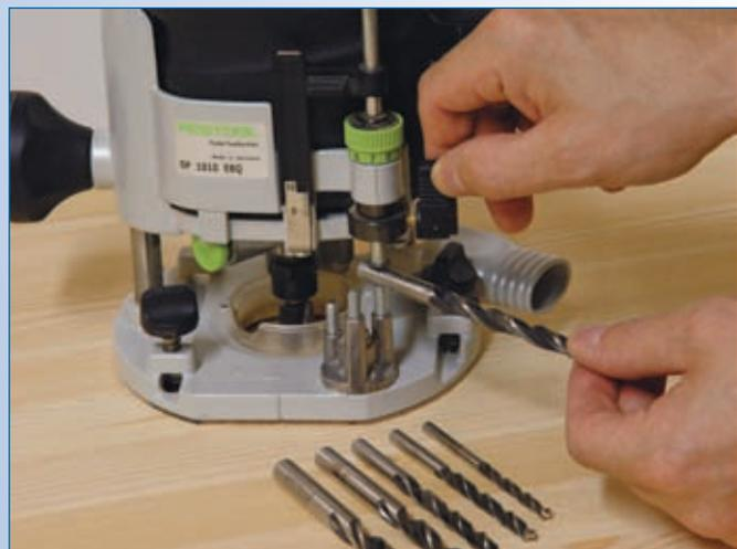
**Abb. 3.4.13:** Mit einem Bohrer einer bestimmten Stärke (= gewünschte Frästiefe) lässt sich jede Oberfräse millimetergenau einstellen. Quelle [3]
