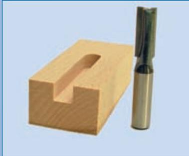
**Abb. 1.5.6:** Nutfräser in verschiedenen Durchmessern sind geeignet zum Fräsen von Nuten und Falzen. Nutfräser mit Stirnschniden können auch in ein Werkstück eintauchen.
