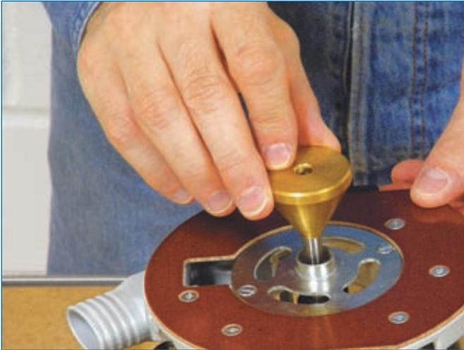
**Abb. 3.2.5:** Jetzt wird der Zentrierdorn in die Spannzange eingespannt. Zu diesem Zweck müssen Sie die Tiefenarretierung betätigen. Wenn der Zentrierdorn eingespannt ist, lösen Sie die Tiefenarretierung wieder. Der Zentrierdorn bringt die lose in die Fußplatte eingelegte Kopierhülse in eine exakte Position. Schrauben Sie die Kopierhülse nun fest – jetzt hat sie die gewünschte Ausrichtung. Entfernen Sie den Zentrierdorn wieder und setzen Sie den Fräser ein. Quelle [3]
