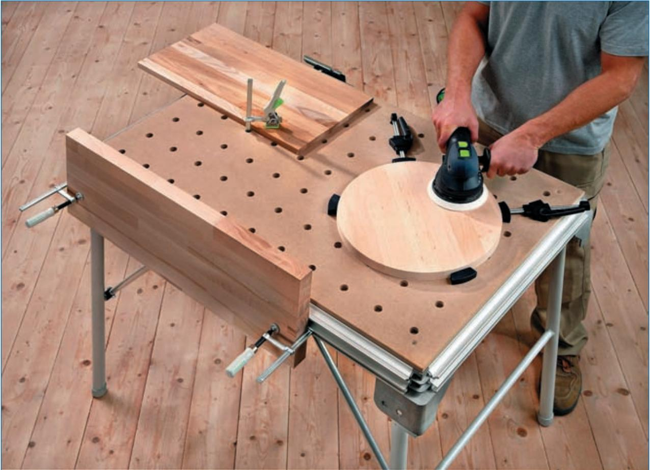
**Abb. 3.5.4:** Der Multifunktionstisch von Festool bietet fast unbegrenzte Möglichkeiten, um ein Werkstück sicher einzuspannen. Quelle [3]
