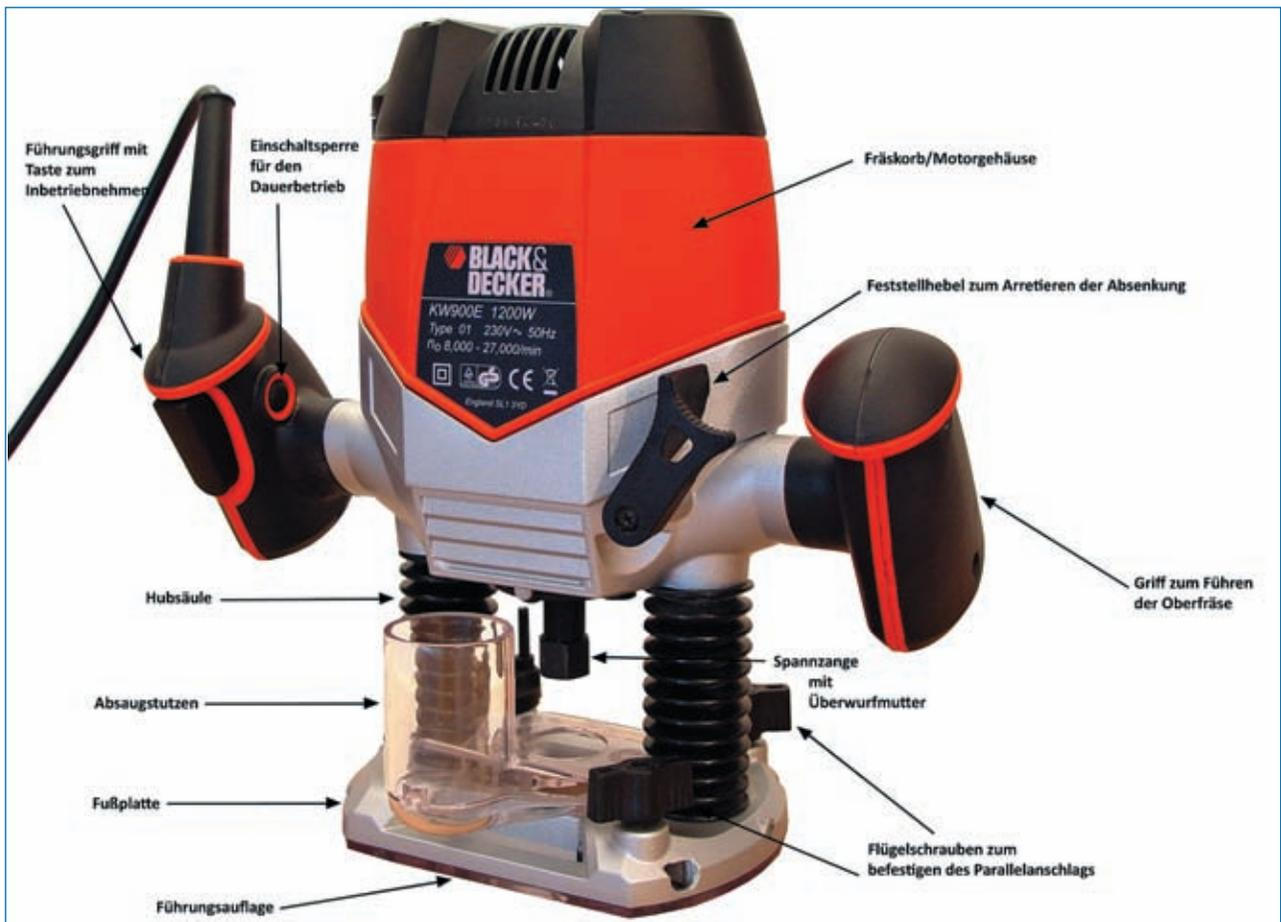
**Abb. 3.0.2:** Die Oberfräse und ihre Bedienelemente (Rückansicht)
