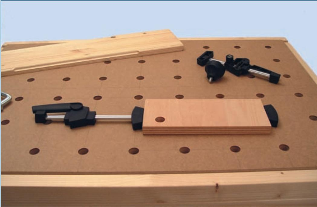
**Abb. 3.5.6:** Die Spannelemente der Firma Festool ergänzen den Multifunktions-tisch aus Abb. 3.5.4.
