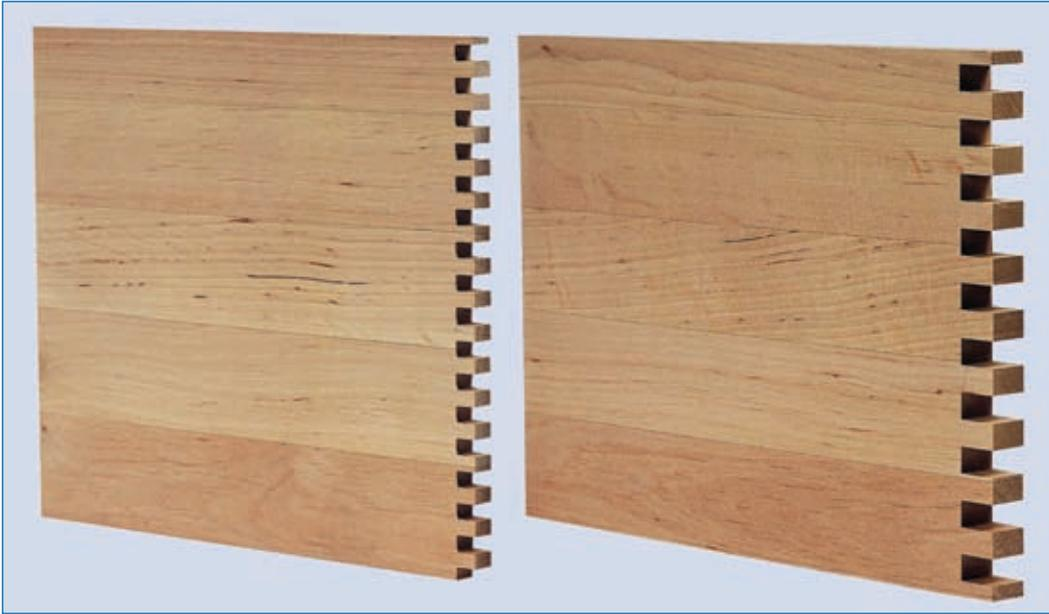
**Abb. 4.6.6:** Im Handel sind Frässhablonen mit unterschiedlicher Zinkenteilung erhältlich. Die hier gezeigten Zinken haben einen Abstand von 6 und 10 mm. Quelle [3]
