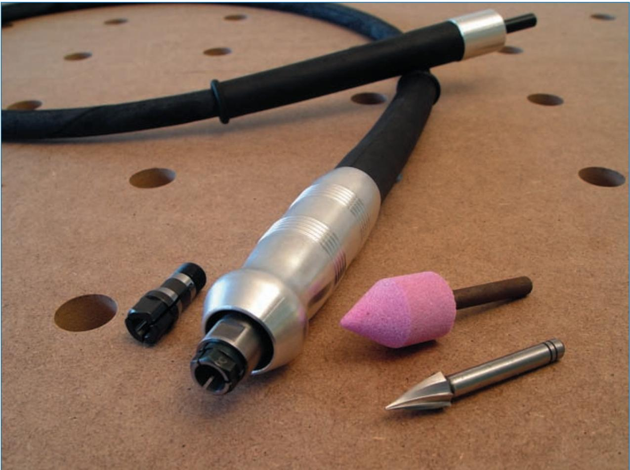
**Abb. 1.3.18:** Eine Biegewelle aus dem Hause metabo ist für Bohrmaschinen mit einer Spannanzengapazität von 6 oder 8 mm erhältlich.
