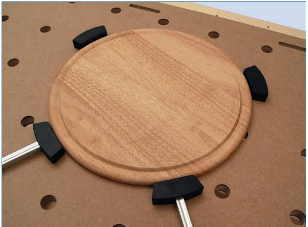
**Abb. 3.5.7:** Auch runde Werkstücke sind auf einem solchen Tisch sicher zu befestigen.
