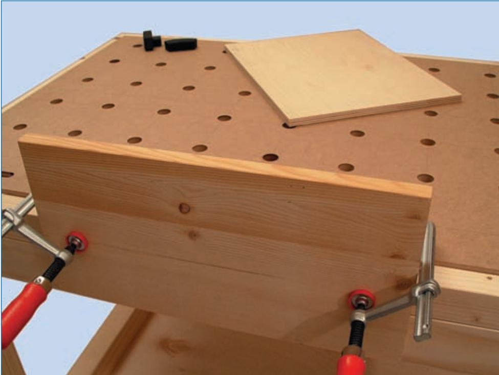
**Abb. 5.4.3:** Mithilfe von Schraubzwingen können Sie Werkstücke an der Langseite der Aufspannplatte hochkant fixieren.
