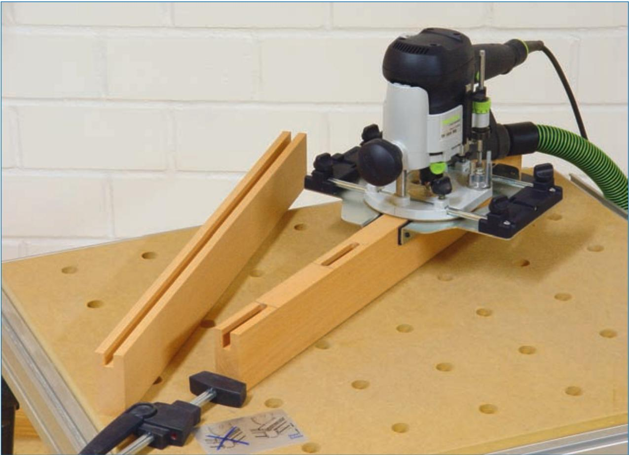
**Abb. 1.3.6:** Mit einem zweiten Parallelanschlag kann man komfortabel Schlitz für Flachdübel oder Nuten in den Kantenbereich fräsen. Quelle [3]
