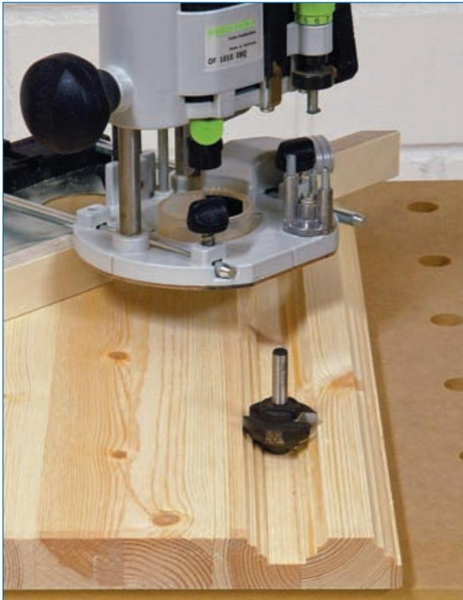
**Abb. 4.3.1:** Rechts die profilierte Kante, links ein Profil im Werkstück – beides mit demselben stirnschneidenden Profilfräser gefräst. Quelle [3]
