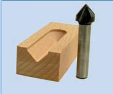
**Abb. 1.5.7:** V-Nutfräser werden zum Fräsen von Ziernuten und zum Gravieren von Schriften verwendet. Am Rand eines Werkstücks geführt, dienen sie auch zum Anfasen der Werkstückkante.
