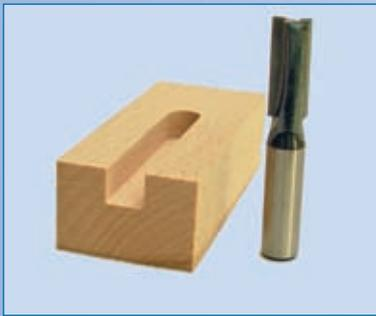
**Abb. 1.5.12:** Mit dem Grat- und Zinkenfräser werden Gratnuten und -zinken für Holzverbindungen gefräst, aber auch Zier- und Dichtungsnuten.
