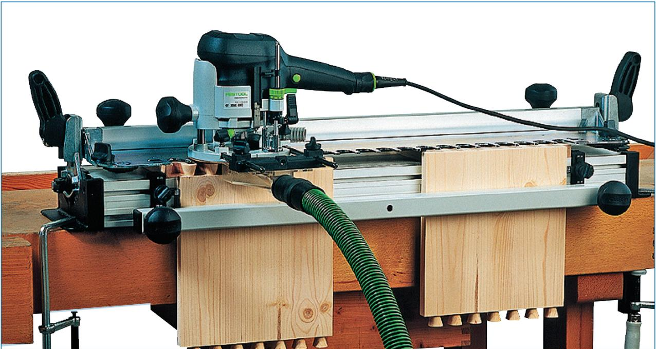
**Abb. 1.3.14:** Mit einer Zinkenfräsvorrichtung kann sich auch ein Heimwerker an die so schwierige wie optisch ansprechende Kunst der Schwalbenschwanzverbindung wagen. Quelle [3]
