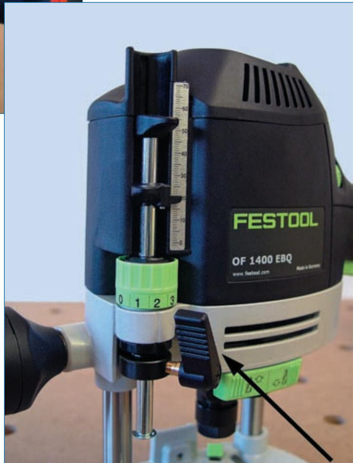
**Abb. 3.4.9:** Bei Festool arretiert man den Tiefenanschlag über einen Hebel.
