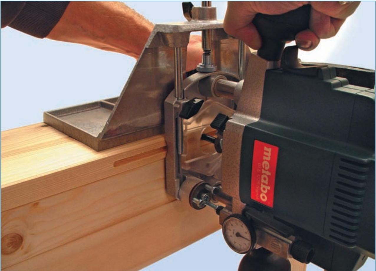
**Abb. 4.2.7:** Mithilfe eines Winkelanschlags kann man auch mit einem einfachen Nutfräser in die Holzkante fräsen.
