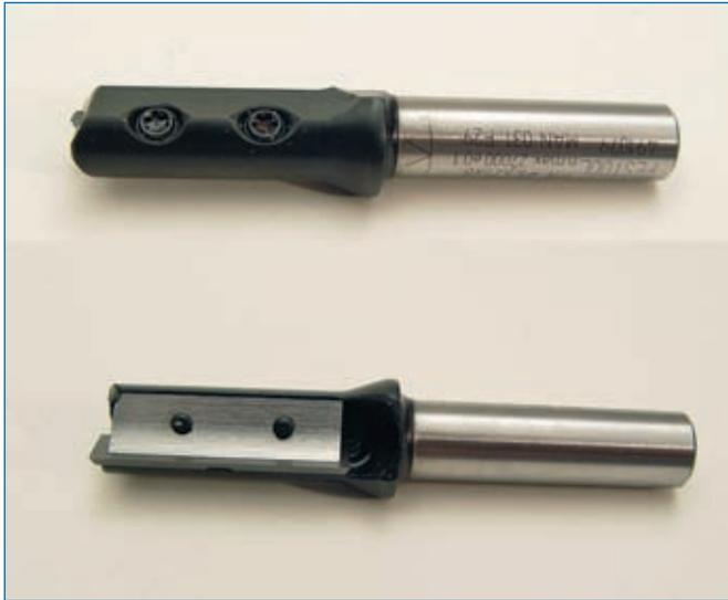
**Abb. 1.5.4:** Die Schneidplatte dieses Wendepplattenfräasers kann nach Lösen der beiden Schrauben um 180° gedreht werden, wenn eine Schneide der Schneidplatte stumpf ist. Sind beide Schneiden stumpf, muss die Schneidplatte ausgetauscht werden.
