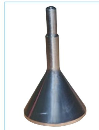
**Abb. 1.3.10:** Mithilfe des Zentrierdorns kann man die Kopierhülse auf zehntel Millimeter genau zentrieren. Quelle [3]
