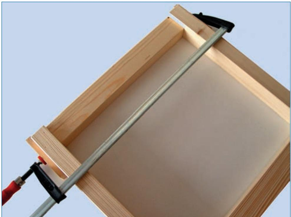
**Abb. 5.1.3:** Die Seitenteile werden mit Schraubzwingen verspannt, bis der Klebstoff vollständig getrocknet ist.
