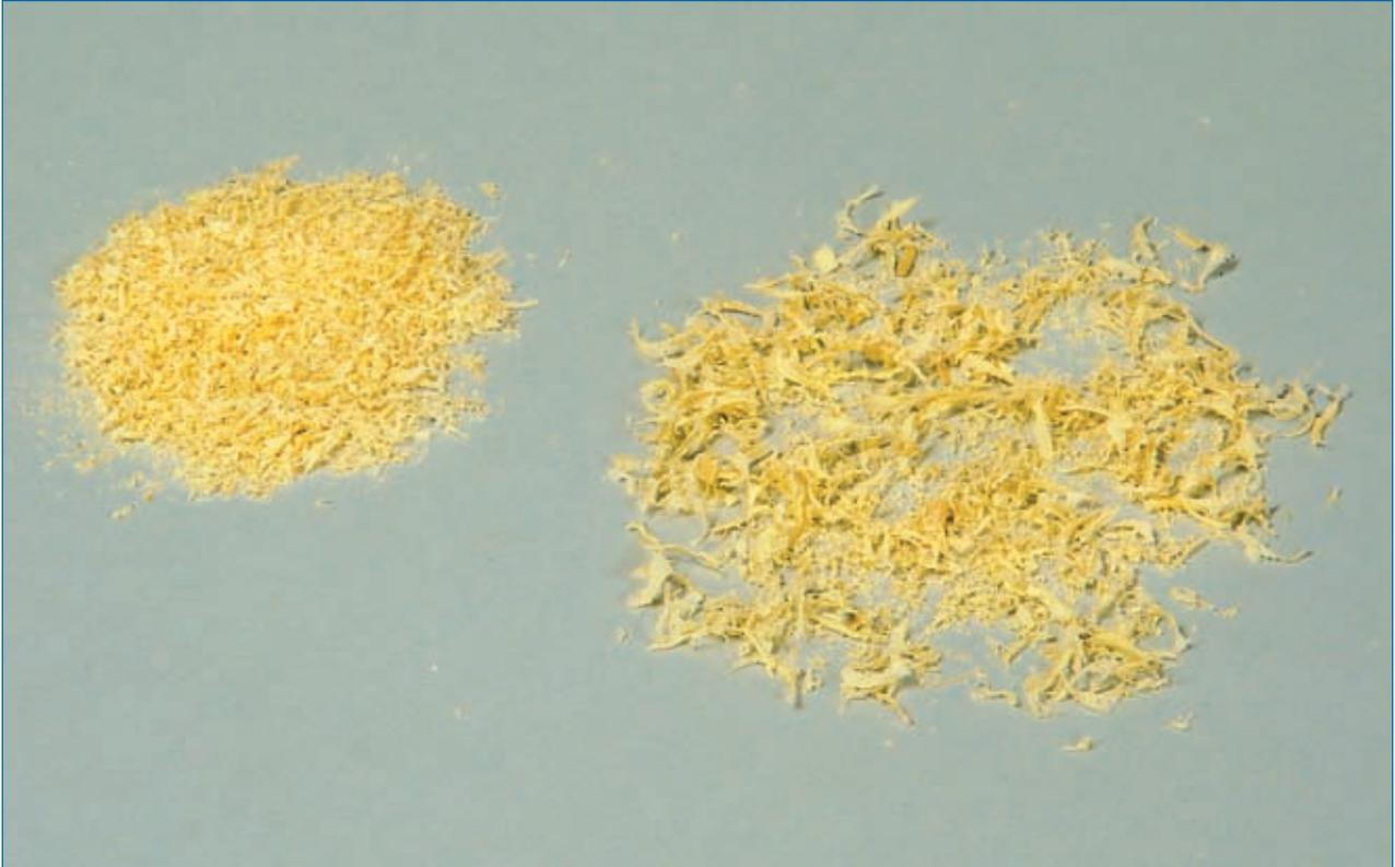
**Abb. 3.7.2:** Links hinten Späne, die bei zu langsamer Vorschubgeschwindigkeit entstanden sind, rechts vorn solche, wie sie bei optimaler Fräsung entstehen. Quelle [3]
