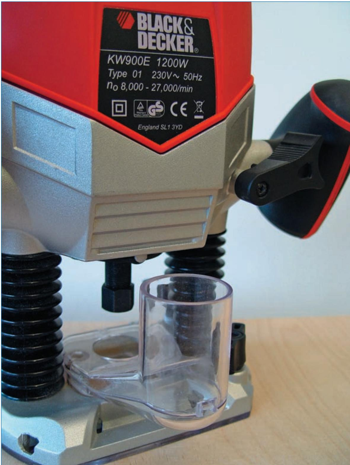
**Abb. 1.2.14:** Bei dieser Oberfräse befindet sich die Absaugvorrichtung unten. Dank seines 35-mm-Durchmessers kann man den Schlauch eines haushaltsüblichen Staubsaugers anschließen – dann darf man aber die Maske zum Schutz vor Feinstaub nicht vergessen.
