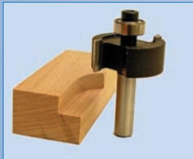
**Abb. 1.5.9:** Falzfräser mit Anlaufzapfen oder Kugellager fräsen Falze mit definierter Tiefe in Werkstückkanten. Mit austauschbaren Kugellagern kann die Tiefe des Falzes variiert werden.
