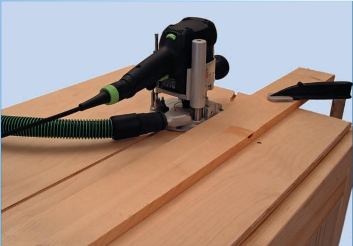
Abb. 4.2.1: Ganz ohne und doch wieder mit Führungsschiene. So lassen sich Profile und Nuten exakt setzen.
