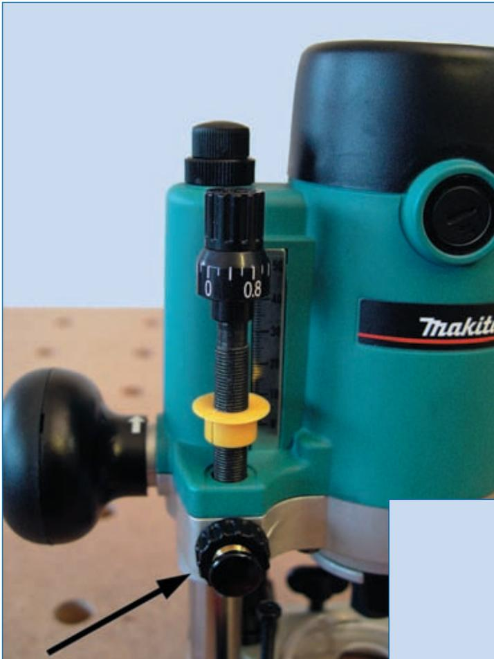
**Abb. 3.4.10:** Die Makita RP0910 verfügt über einen Dreh- und Druckknopf zum Feststellen und Lösen der Anschlagstange.
