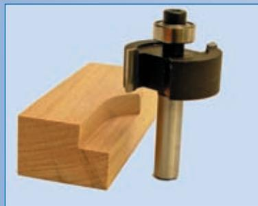
**Abb. 1.5.15:** Dank des großen Durchmessers und der hohen Umfangsgeschwindigkeit der Schneiden werden Schnitte mit dem Scheibennutfräser besonders sauber. Auf einem Aufspanndorn können verschiedene Scheiben für unterschiedlich breite Nuten montiert werden.
