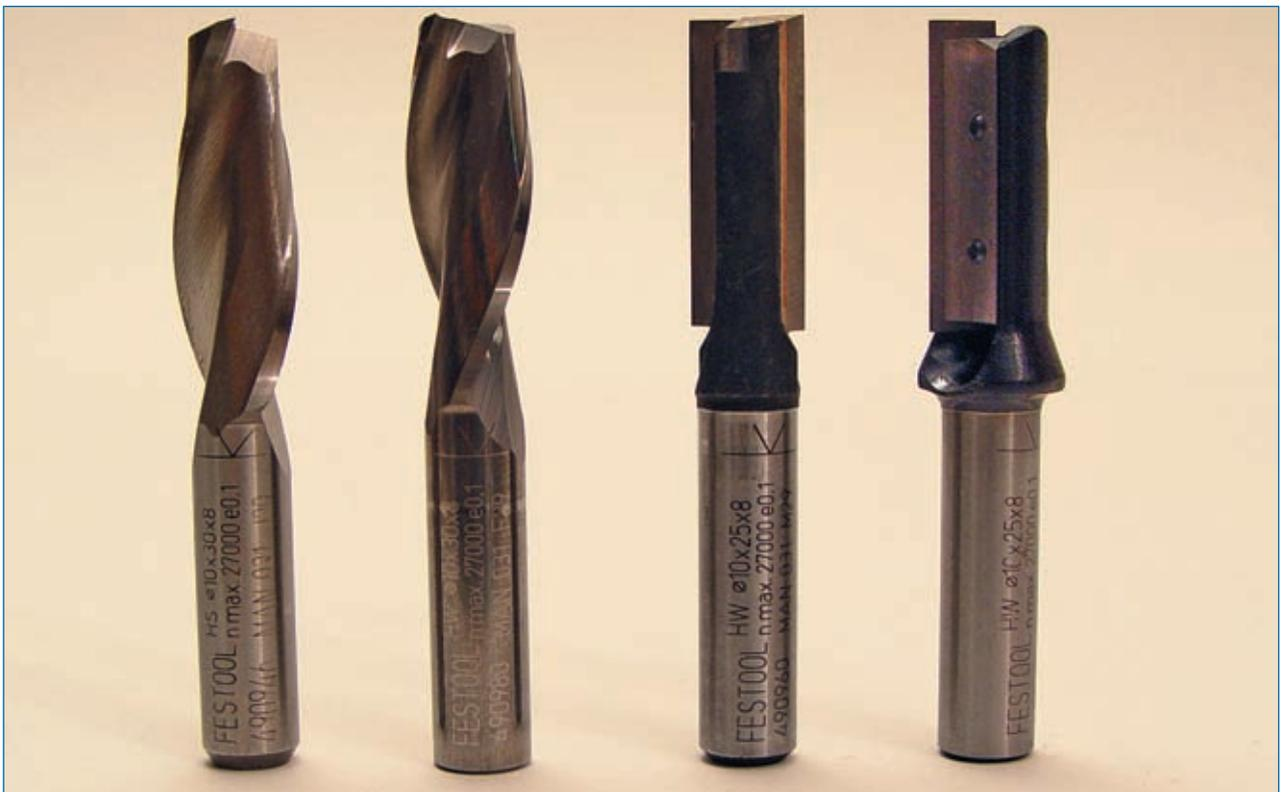
**Abb. 1.5.3:** HS-Spiralnutfräser, HW-Spiralnutfräser Voll-Hartmetall, HW-Nutfräser mit eingelöteten Hartmetallschneiden und HW-Nutfräser mit Wendepatte (von links nach rechts)
