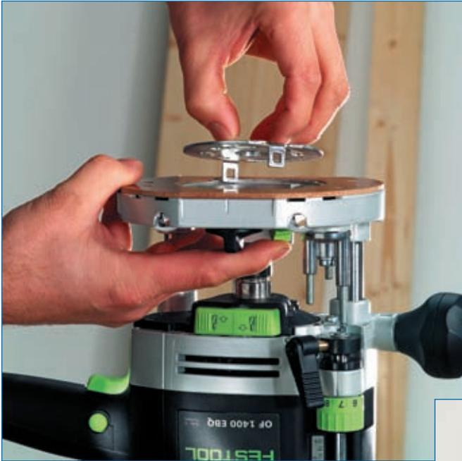
**Abb. 3.2.2:** Ebenso werkzeuglos, einfach und schnell ist das Setzen der Kopierhülse bei den Oberfräsen der höheren Leistungsklasse von Festool, z. B. der hier gezeigten OF 1400 EBQ, möglich. Quelle [3]
