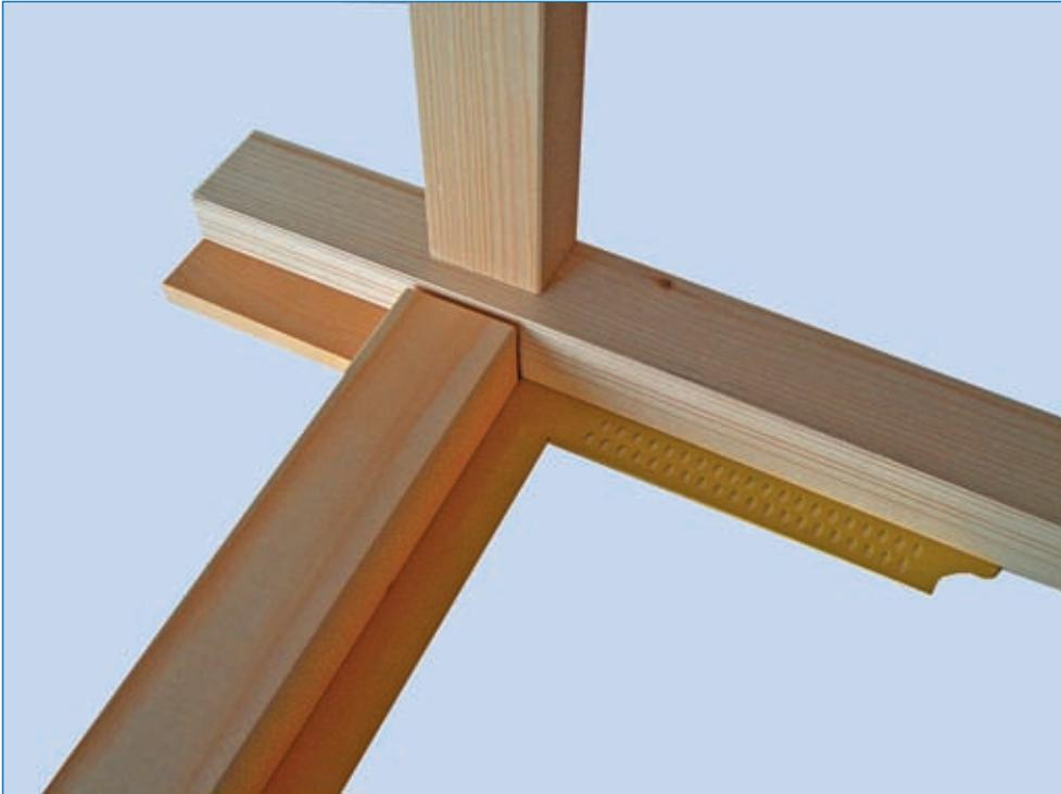
**Abb. 5.1.4:** Eine sichere Sache: Ein Metallwinkel und ein passend abgelängtes Holzklötzchen helfen bei der exakten Positionierung der unteren Zargen.
