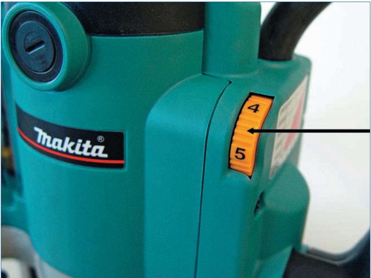
Abb. 1.2.4: Über ein solches Rad lässt sich die Drehzahl regeln.
