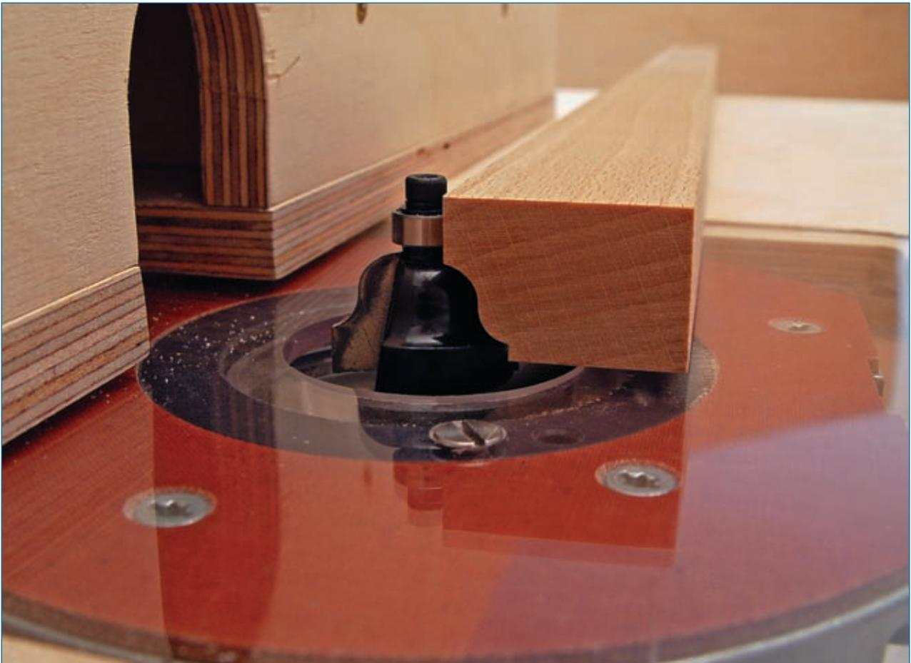
**Abb. 4.3.8:** Wenn man die Oberfräse unter einen dafür vorgesehenen Frästisch montiert, kann man die Leiste an ihr vorbeiführen.
