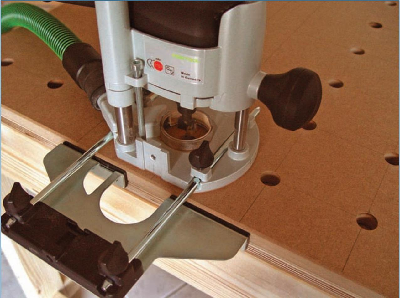
**Abb. 5.4.2:** Am Rand der Aufspannplatte können die Bohrungen mithilfe des Parallelanschlags gesetzt werden. Dank der Markierung an der Grundplatte der Oberfräse ist das exakte Positionieren kein Problem.
