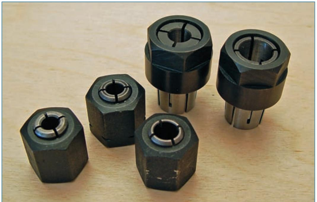
**Abb. 1.2.6:** Mithilfe unterschiedlicher Spannzangen lässt sich das Spektrum der verwendbaren Fräser erweitern.
