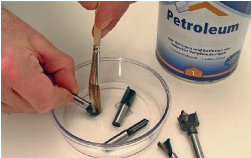
**Abb. 1.5.16:** Legen Sie die Fräser zur Reinigung einige Zeit in ein Petroleumbad. Die Verschmutzungen lassen sich dann gut mit einem Pinsel oder einer alten Zahnbürste entfernen.
