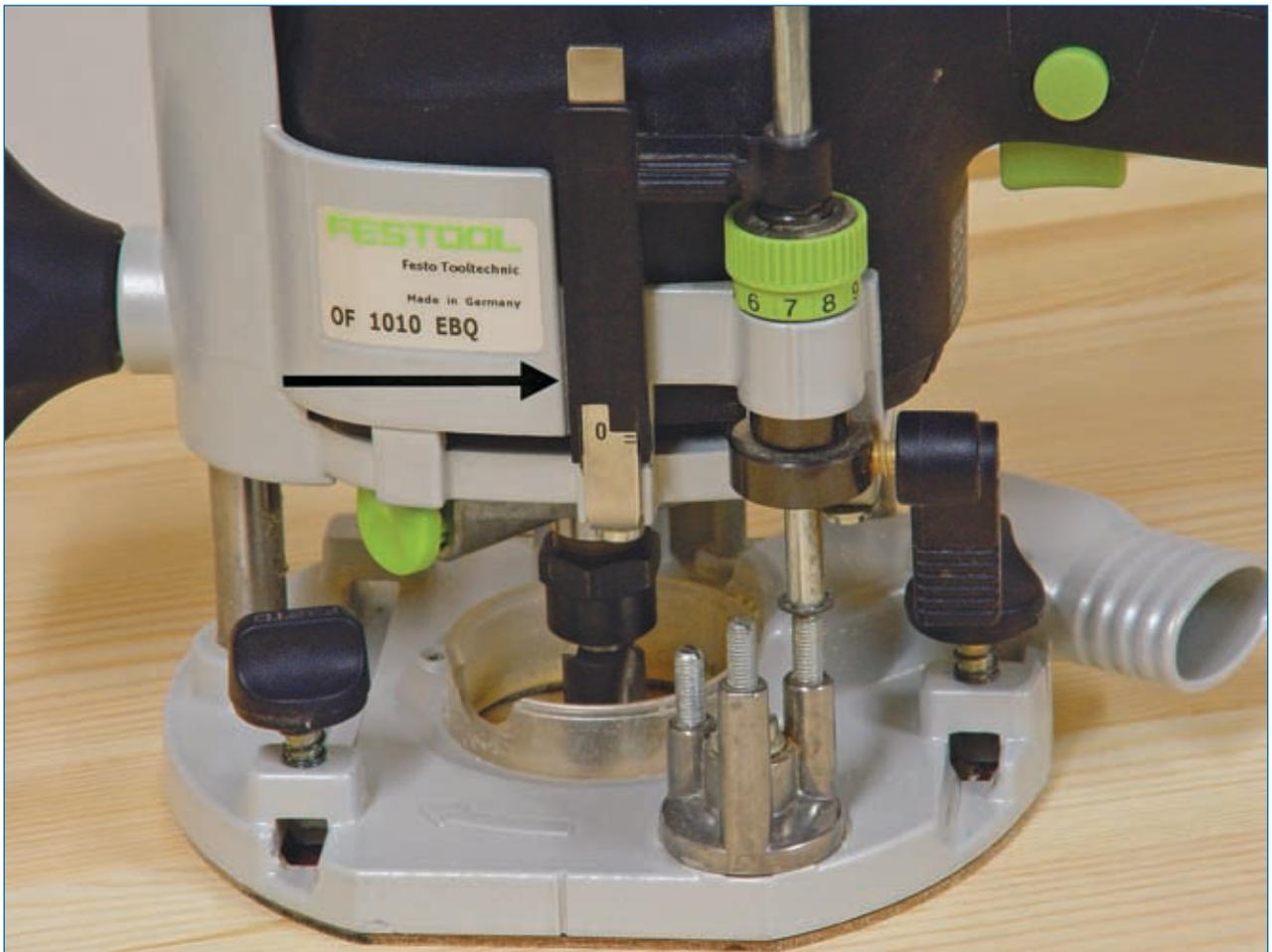
**Abb. 1.2.10:** Mithilfe des schwarzen Kunststoffschiebers lässt sich die Nullposition festlegen. Nun kann man die Frästiefe millimetergenau einstellen. Quelle [3]
