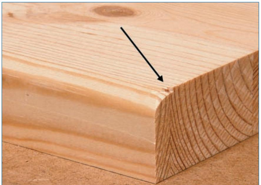
**Abb. 4.3.5:** Eine kleine Einkerbung, wie sie hier am Ende des Werkstücks zu sehen ist, ist ärgerlich, aber vermeidbar. Quelle [3]
