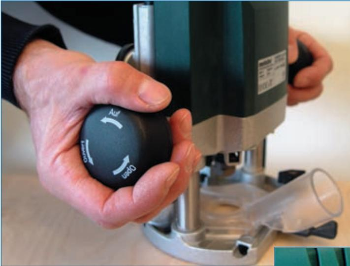
**Abb. 3.4.3:** Bei manchen Geräten lässt sich das Motorgehäuse mittels eines Drehknopfs arretieren und lösen ...
