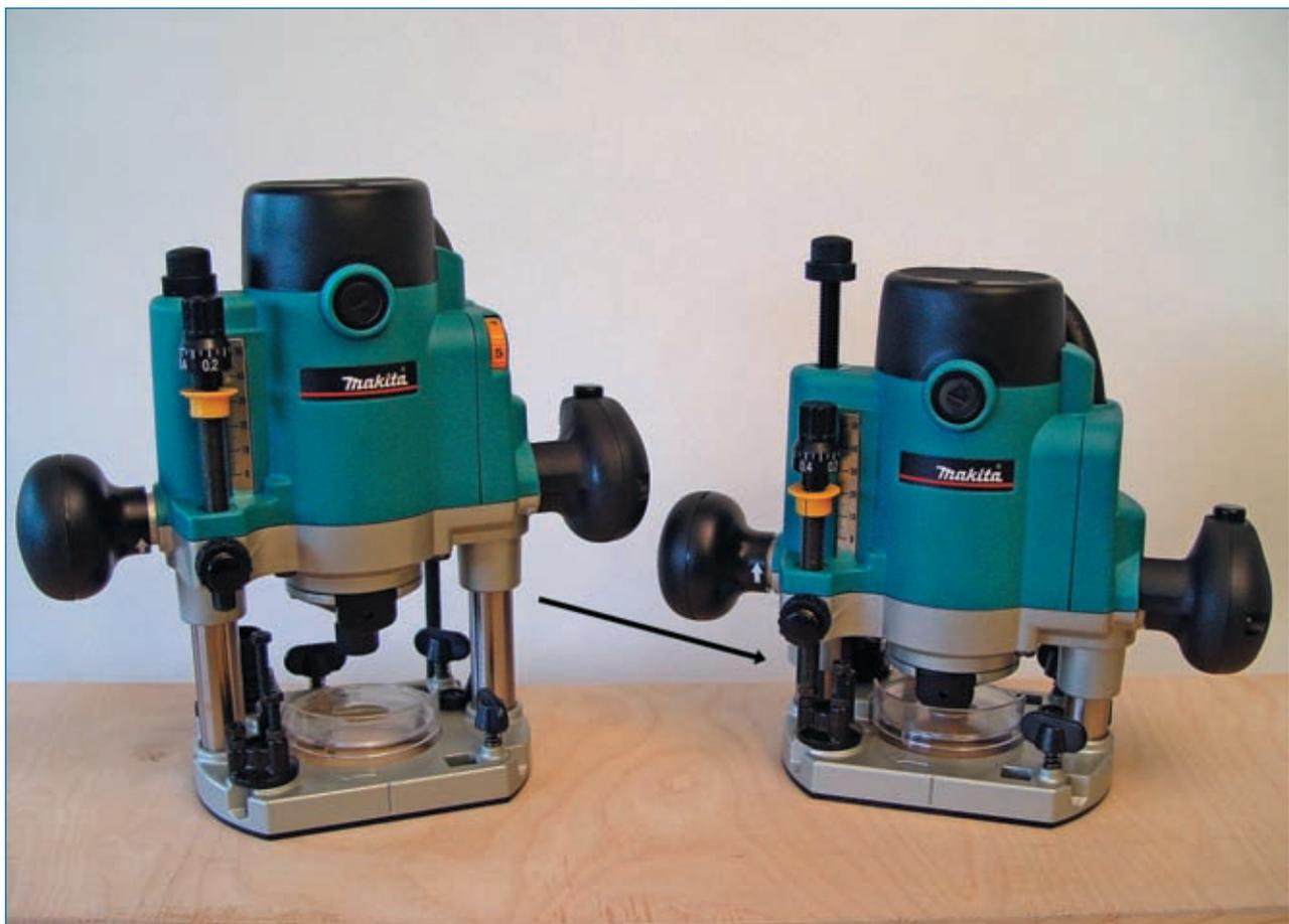
**Abb. 1.2.7:** Die maximal mögliche Absenkung der Oberfräse nennt man *Hubhöhe*, *Fräskorbhub* oder *Fräshub*.
