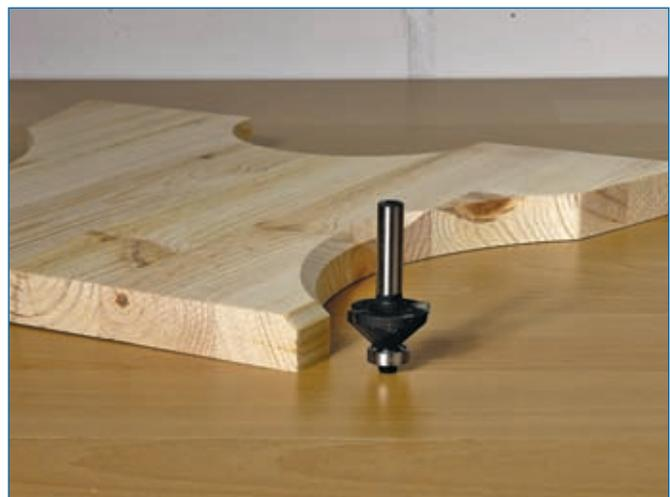
**Abb. 4.3.3:** Eine mit einem Fasefräser bearbeitete Kante. Quelle [3]
