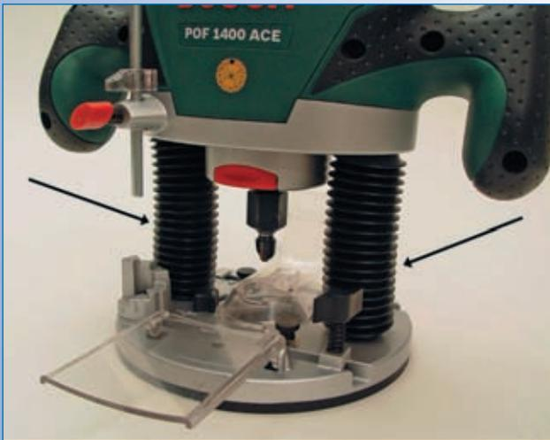
**Abb. 1.4.2:** Bei den Oberfräsen einiger Hersteller schützen Manschetten die Führungssäulen vor Verunreinigung.
