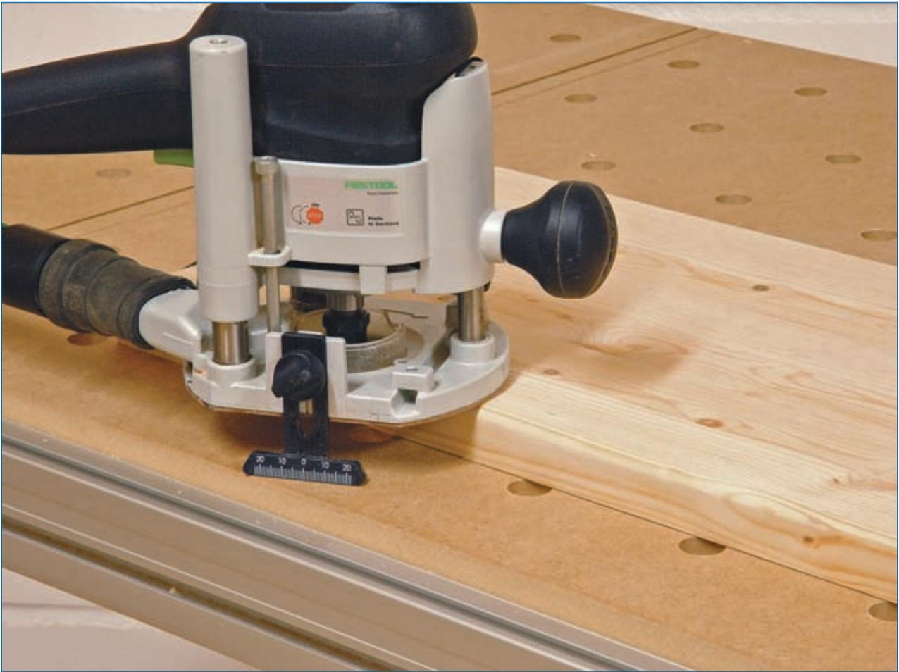
**Abb. 4.3.6:** Die Festool OF 1010 verfügt über eine T-förmige, verstellbare Vorrichtung, mit der man die Oberfräse „auf Niveau“ halten kann. Quelle [3]
