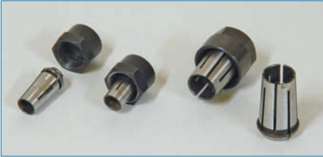
**Abb. 1.3.2:** Spannzangen unterschiedlicher Größen und die dazugehörigen Überwurfmutter machen es möglich, Fräser verschiedener Schaftgröße einzusetzen. Der Hersteller gibt im Zubehörcatalog an, mit welchen Spannzangen Sie Ihre Oberfräse bestücken können. Quelle [3]
