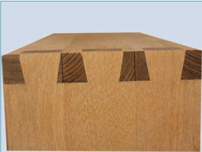
**Abb. 4.6.4:** Optimal ist es, wenn an den Enden des Werkstücks jeweils ein halber Zinken vorhanden ist. Quelle [3]
