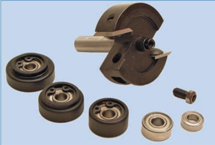
**Abb. 4.4.1:** Bei dem hier gezeigten Falzfräser kann man nur durch den Austausch des Kugellagers bis zu sechs verschiedene Falztiefen erzielen.
