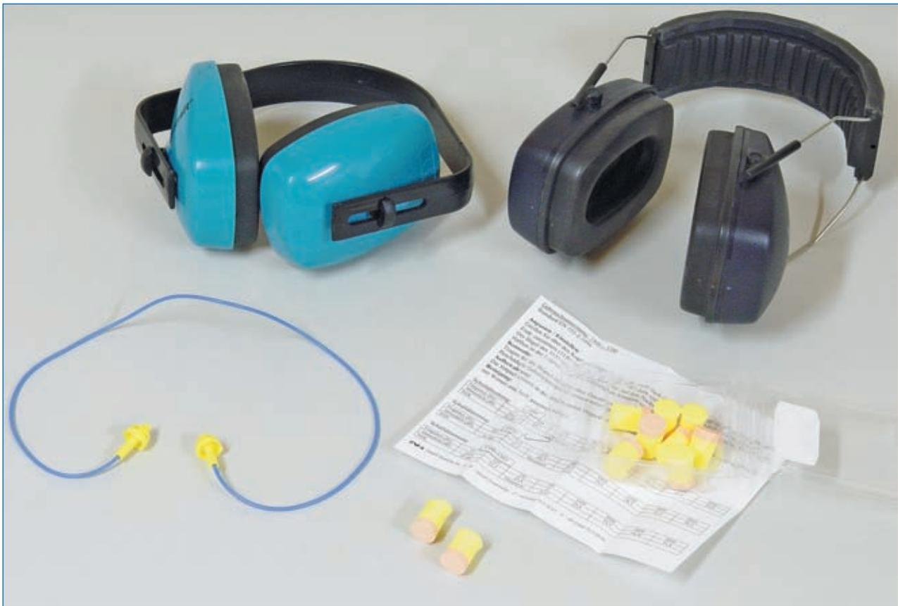
**Abb. 2.1.1:** Den besten Schutz bietet der Kapselgehörschutz (hinten). Aber auch mit Einweg- oder wiederverwendbaren Ohrstöpseln (vorn) tut man seinen Ohren Gutes. Quelle [3]
