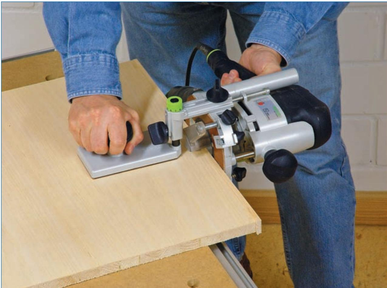
**Abb. 4.1.15:** Diese Abbildung zeigt einen Winkelarm in Verbindung mit einer Umleimerplatte. Hier wird eine aufgeleimte und überstehende Leiste bündig gefräst. Quelle [3]
