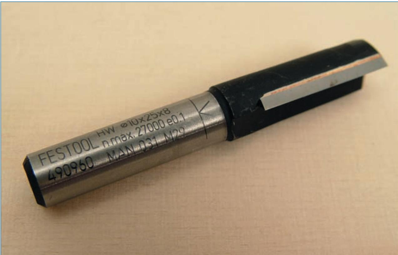
**Abb. 1.5.2:** Daten auf dem Schaft eines Fräasers von Festool: Material (HS oder HW), Schneidendurchmesser, Nutzlänge der Schneide, Schaftdurchmesser, Schneidenschräge und maximale Drehzahl. Die Kennzeichnung „MAN“ steht für „manuell“ und besagt, dass der Fräser für Handvorschub geeignet ist.
