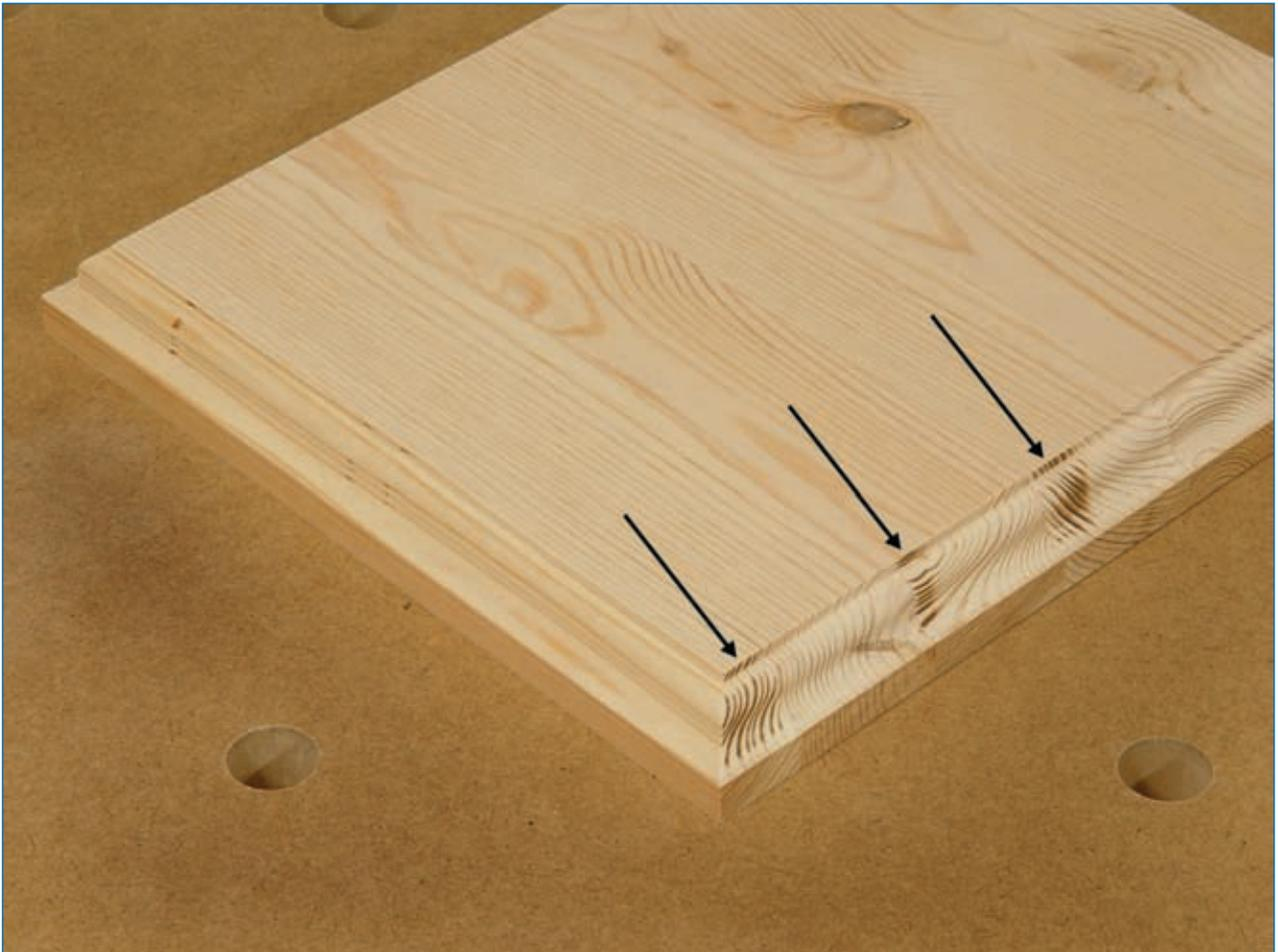
**Abb. 3.7.1:** Hier wurde die Oberfräse zu langsam über das Werkstück geführt. Die dunklen Stellen sind Brandflecken. Quelle [3]
