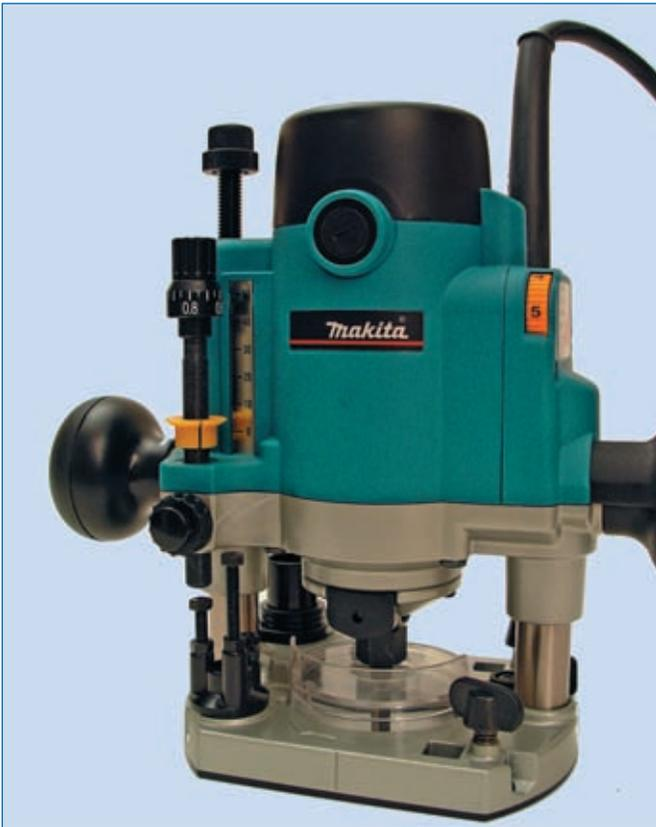
**Abb. 3.4.12:** Wenn der Tiefenanschlag auf die gewünschte Position gezogen wurde (hier 5 mm), wird er wieder arretiert.
