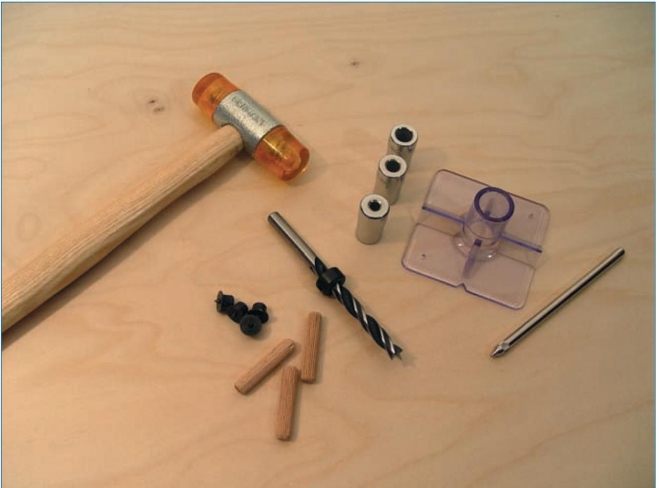
**Abb. 5.1.1:** Ein Kunststoffhammer, eine Bohrschablone mit Einsätzen in verschiedenen Durchmessern, ein Holzbohrer mit Tiefenanschlag und Dübelfixe sind wichtige Hilfsmittel beim Bau des Tisches.
