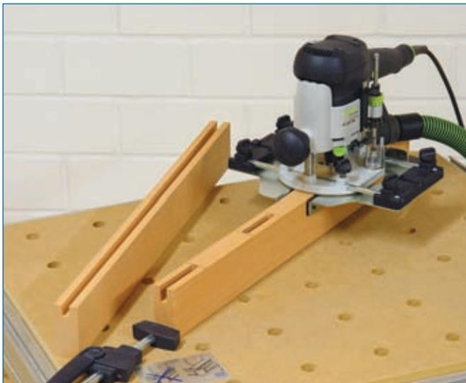
Über zwei Führungsstangen wird der Parallelanschlag mit der Oberfräse verbunden und dort an der Fußplatte üblicherweise mit zwei Flügelschrauben befestigt. Durch Verstellen der Einschubtiefe der Führungsstangen lässt sich der gewünschte Abstand problemlos einstellen.
