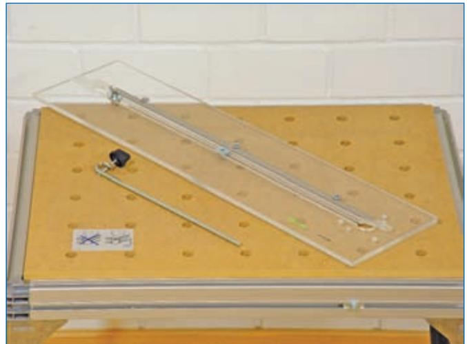
**Abb. 1.3.13:** Links ein so einfacher wie nützlicher Stangenzirkel, rechts ein Zirkel aus Acrylglas mit Maßskala. Quelle [3]
