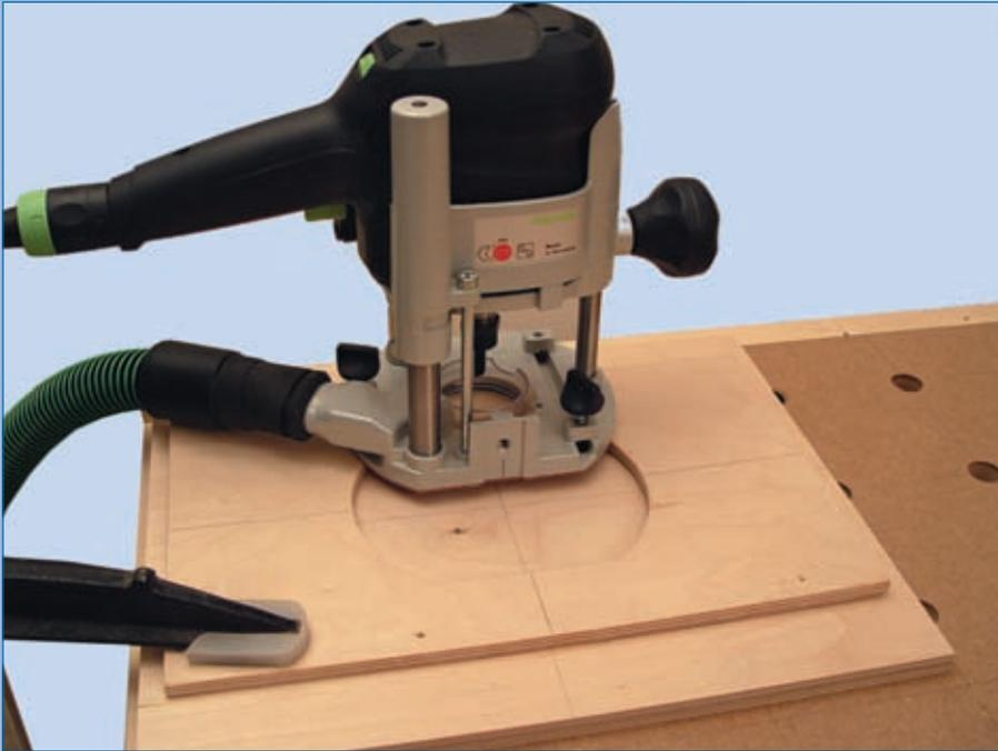
**Abb. 4.5.4:** Die einmal angefertigte Schablone kann man immer wieder verwenden.
