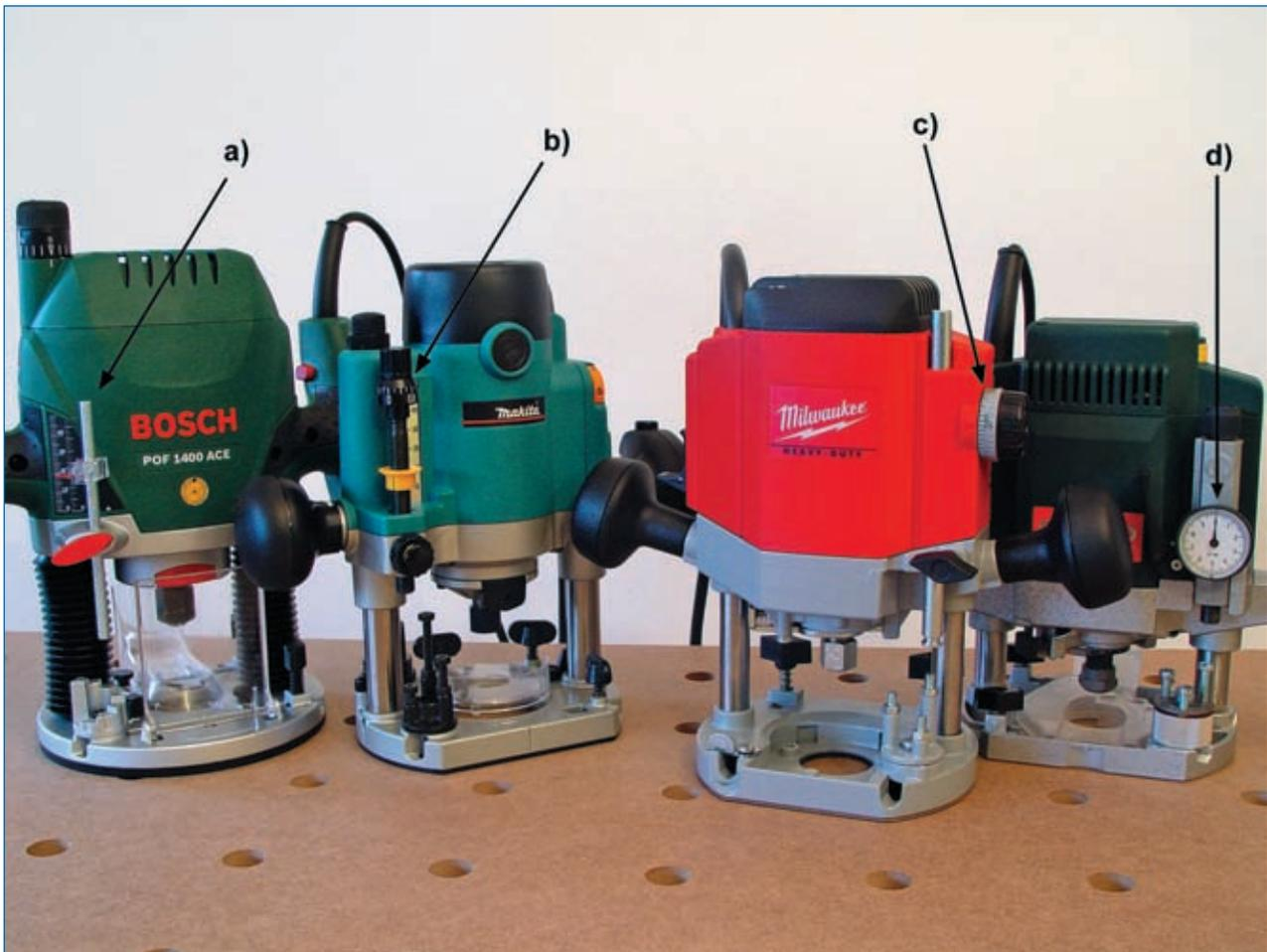
**Abb. 1.2.9:** Zum Einstellen der gewünschten Frästiefe bieten die verschiedenen Oberfräsen unterschiedliche Möglichkeiten: a) über einen verschiebbaren Stab an einer Tiefenskala, b) über einen Gewindestab, der sich durch Drehen an der Tiefenskala ausrichten lässt, c) mittels eines Einstellrads oder d) per Messuhr zur Feineinstellung.
