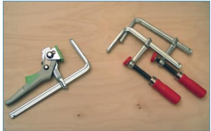
**Abb. 3.5.1:** Schraub- oder Schnellspannzwingen eignen sich zum sicheren Einspannen des Werkstücks.
