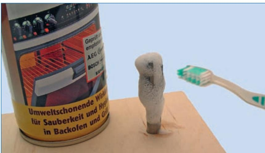
**Abb. 1.5.18:** Hartnäckige Verschmutzungen lassen sich mithilfe von Backofenreiniger mühelos entfernen. Sprühen Sie den Reinigungsschaum auf, lassen Sie ihn einwirken und entfernen Sie die Verschmutzungen dann mit einem Tuch.
