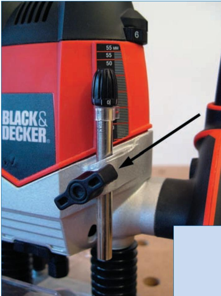
**Abb. 3.4.8:** Bei der Oberfräse von Black & Decker lässt sich die Anschlagstange über eine Flügelschraube lösen.
