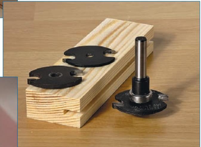
**Abb. 4.2.5:** Auch Scheibennutfräser sind in verschiedenen Stärken erhältlich. Quelle [3] Eine Nut, wie sie hier gezeigt wird ...
