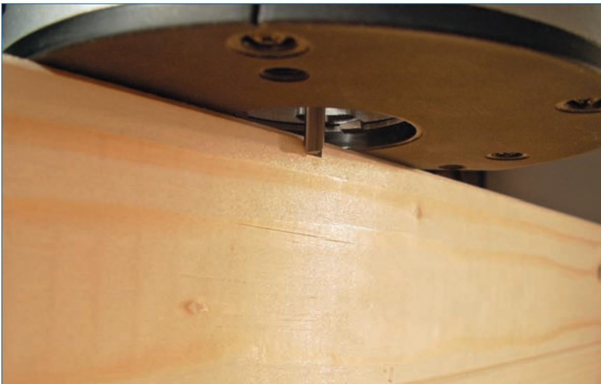
**Abb. 3.4.2:** An der Kante eines Werkstücks erkennt man ungefähr, wie tief der Fräser in das Holz schneiden wird.
