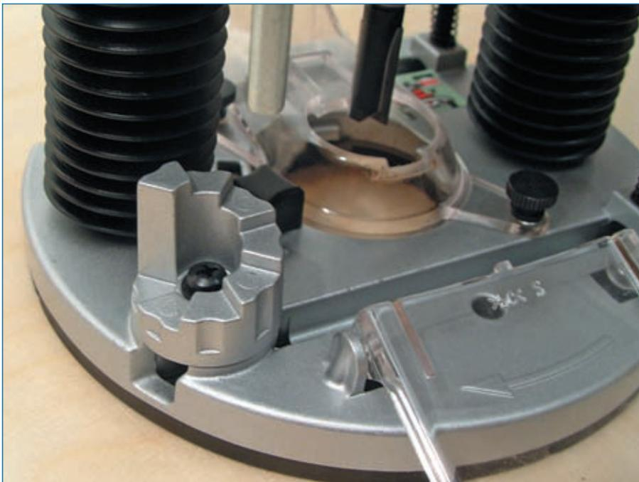
**Abb. 3.4.7:** Der Revolveranschlag der POF 1400ACE von Bosch ist ebenfalls drehbar, verfügt aber über feste Stufen und mehr als es sonst üblich ist.
