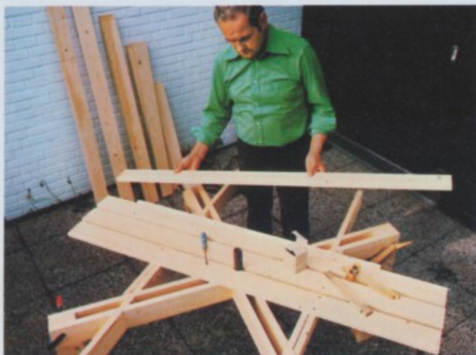
Het tafelblad wordt op de kant en klare onderbouw gemonteerd. De dwarsbalkjes met lijmtangen aan het onderstel bevestigen.
