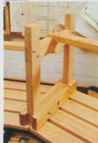
De combinatie van twee zitelementen tot een bank: één poot spaart men hier uit. De schoren afwisselend boven en onder bevestigen.
