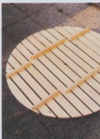
De onderkant van het tafelblad. De dwarsplankjes moeten in het onderstel grijpen. Men ziet dat het tafelblad uit drie delen bestaat.
