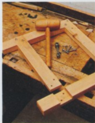
De konstruktie van het voetstuk van een zitelement. Men kan de lipverbindingen en de diagonaal geplaatste bouten duidelijk zien. Door de diagonale schroefverbinding wordt de konstruktie steviger.
