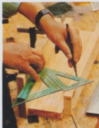
Een zelfgebouwde verstekbak helpt bij het in verstek zagen van de zitplanken. Met twee tekendriehoeken van 45^\circ en 30^\circ krijgt men een hoek van 75^\circ . Let er speciaal op, dat de verticale zaagsnede zuiver loodrecht is. Met het plotlood aantekenen.
