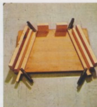
Een mal vergemakkelijkt de montage van de zitelementen. De binnenste aanlegbalkjes kan men verwijderen, wanneer het zitelement eruit gehaald moet worden.
