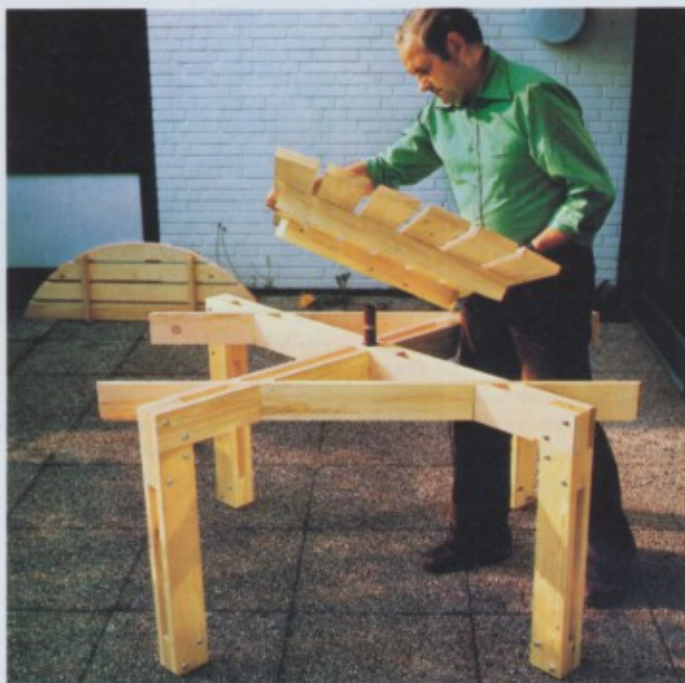
Het tafelblad wordt op de kant en klare onderbouw gemonteerd. De dwarsbalkjes met lijmtangen aan het onderstel bevestigen.
