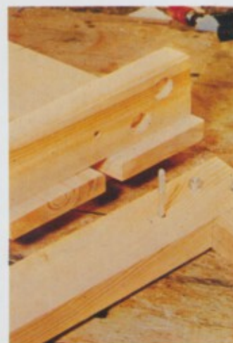
De verbinding van zitting met voetstuk. Blinde gaten in de dwarslatten nemen de uitstekende moeren op. Voor het impregneren het hout eerst met een natte spons bevochtigen, dan schuren.
