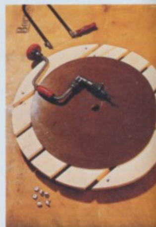
De draaibare schijf heeft van onderen een kunststof plaat. Deze draait op nylon glijstukken, die op het tafelblad worden gespijkerd.
