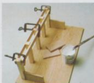
De afmetingen van de grondplaat: 50 x 35 cm. De bouw begint met de steunpilaren.
