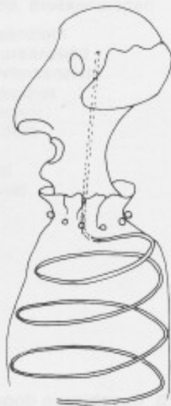
Afb. 73. De bevestiging van de veer in de duvelskop.
