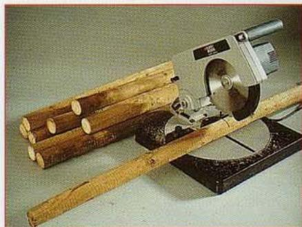
**1** Mesurez les rondins et taillez-les aux longueurs voulues et bien droit à l'aide d'une scie à onglet, éventuellement électrique.
