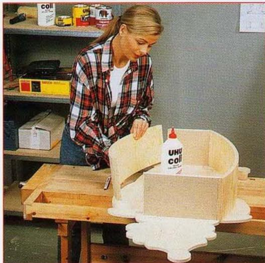
**3** Placez la porte face contre terre, à plat sur l'établi. Encollez les chants des petits côtés des panneaux B, C, D et positionnez-les sur la porte. Vérifiez qu'aucun ne dépasse de celle-ci.
