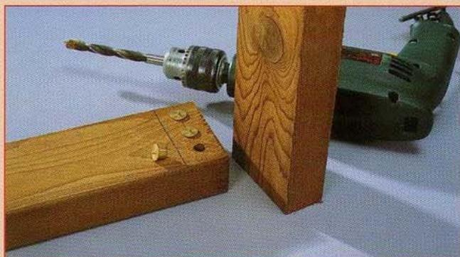
L'assemblage par tourillon est un système qui permet de remplacer les vis ou les clous pour rendre solidaires deux pièces entre elles et qu'utilisent beaucoup les menuisiers. Le tourillon est un cylindre de bois encollé (Ø 10 ou 12 mm) qui rentre des trous percés dans chacune des pièces à assembler. Des centreurs permettent de repérer sur chacun des éléments leur emplacement pour assurer leur parfaite correspondance. Repérez les longueurs des
