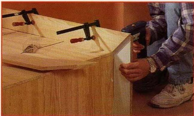
**5** Couchez le meuble sur le dos. Le repose-pieds **H** est divisé en trois éléments. Tracez et coupez à la scie à onglet les angles à 45°, soit les deux extrémités de l'élément central et 1 extrémité des éléments latéraux. Encollez, bloquez avec les serre-joints et vissez (vis 4 x 30) par la face inférieure du plateau **A**.
