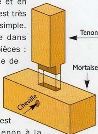
● La mortaise se trace à l'équerre au milieu du poteau. On utilise ensuite un foret pour effectuer une série de trous sur toute la longueur de la mortaise. Puis on rectifie les bords avec un ciseau à bois. Une mortaise traversante transperce toute l'épaisseur du poteau. Une mortaise borgne ne traverse pas entièrement le poteau ; il faut donc faire les trous en installant un guide de butée sur le foret.
