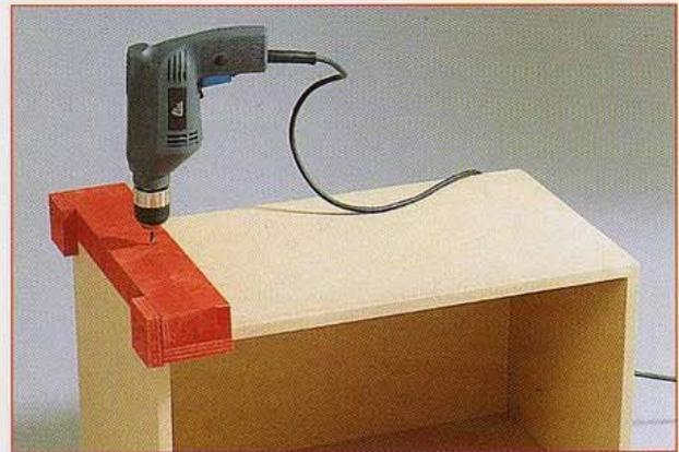
**5** Fabriquez un gabarit de perçage à partir d'un demi-chevron de 35 x 70 et de CTP de 16 (voir dessin verso fiche 1). Percé ( $\varnothing 8$ ) à 50 mm de son chant avant, il permet de repérer l'emplacement des fixations qui rendent les cubes solidaires par leurs dessus et dessous.
