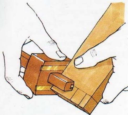
**16 Tracer les tenons** Marquez les mesures prises ci-dessus avec un trusquin et tracez les tenons sur les deux faces et le chant de la traverse, en partant des deux bords.
