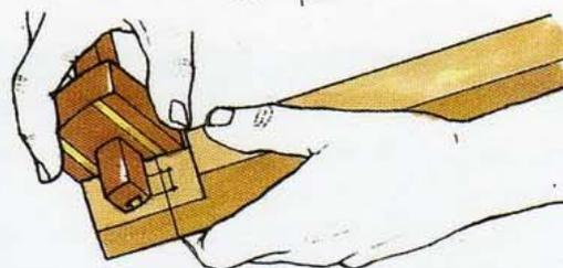
**42 Marquer la mortaise de la clé** Démontez l'assemblage et marquez la mortaise pour la clé coulissante sur le bord supérieur du tenon. Le fond de la mortaise doit être à environ 3 mm à l'intérieur de la ligne qui marque l'épaisseur du montant.
