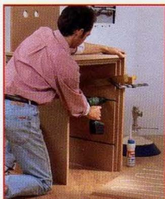
**9** Encollez (colle vinylique) chacun des côtés extérieurs **D**. Maintenez avec les serre-joints et les cales. Vissez (vis agglo diam. 3,5 x 35) par les avant-trous préparés dans les rainures.
