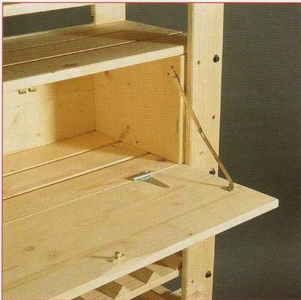
**8** L'abattant n'est pas non plus fixé sur les montants, mais en partie basse sur la tablette inférieure (au moyen de deux pentures anglaises de 75 mm) et en partie haute, sur les côtés grâce à deux compas à grenouillère (vis  $\varnothing 3 \times 15$ ).
