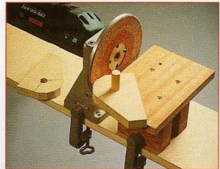
**8** Découpés à la scie sauteuse, les flasques (I et L) doivent recevoir un ponçage de finition. L'idéal est de fixer la perceuse (équipée d'un disque abrasif fin) sur un support d'établi et de disposer d'un autre support (lui-aussi fixé sur l'établi) pour y appuyer la pièce à rectifier.
