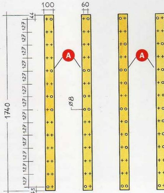
**Perçage et assemblage des montants et des tasseaux supports de tablettes**
