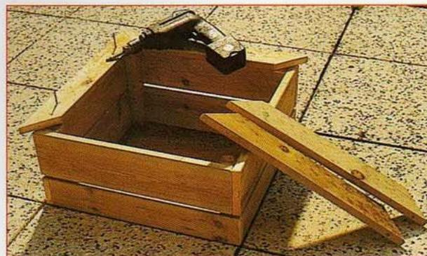
**4** Une fois la caisse assemblée et mise d'aplomb (au niveau à bulle), préparez les planches coiffant ses côtés : repérez (à l'équerre) leurs découpes d'extrémité à 45° et exécutez-les à la scie égoïne. Là encore, percez deux avant-trous par planche et vissez-les avec des vis aggro  $\varnothing 4 \times 40$ .
