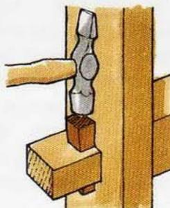
**44 Terminer l'assemblage** Coupez la mortaise de la clé et évasez l'extrémité au ciseau à bois. Assemblez et enfoncez la clé à petits coups de marteau, jusqu'à ce qu'elle soit bloquée.
