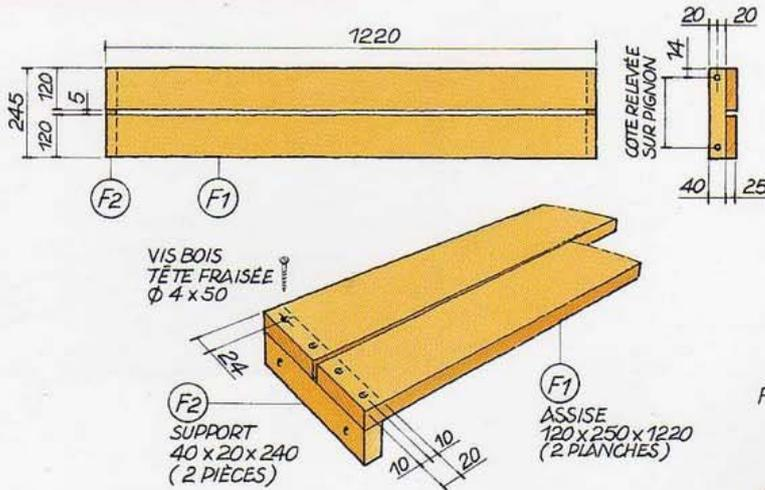
une assise à 320 mm du sol) dans les façades au niveau des colombages afin qu'il y ait assez d'épaisseur et que les écrous ne risquent pas de s'arracher. Pour être sûr que les trous correspondent, il est recommandé de percer ensemble les trous dans les façades et les supports du banc en maintenant, le temps du perçage, le banc et la façade avec un serre-joint.
