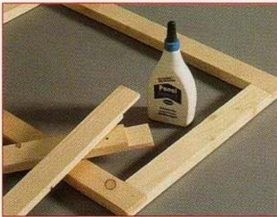
**1** Assemblez à mi-bois les montants et traverses constituant les cadres des portes du « garde-manger ». Pour ce faire, repérez les coupes à l'équerre et taillez-les à l'égoïne ou à la scie à dos sur la moitié de leur épaisseur. Un établi pliant ne sera pas superflu pour maintenir les pièces. Encollez-les ensuite et mettez sous presse.
