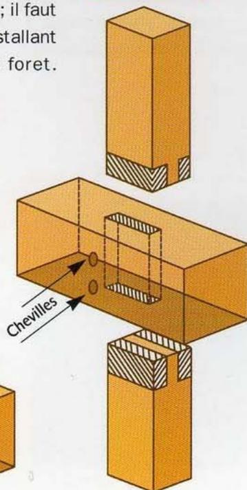
● Le tenon se réalise au bout du poteau. Il faut d'abord en faire le tracé à l'équerre sur les 4 côtés du poteau et sur son extrémité. La longueur d'un tenon est toujours légèrement inférieure à la profondeur de la mortaise. On découpe (avec une scie égoïne à dents fines) d'abord sur l'extrémité, puis d'un côté et de l'autre du tenon. Un coup de râpe sur les arêtes du tenon facilite l'emboîtement.
