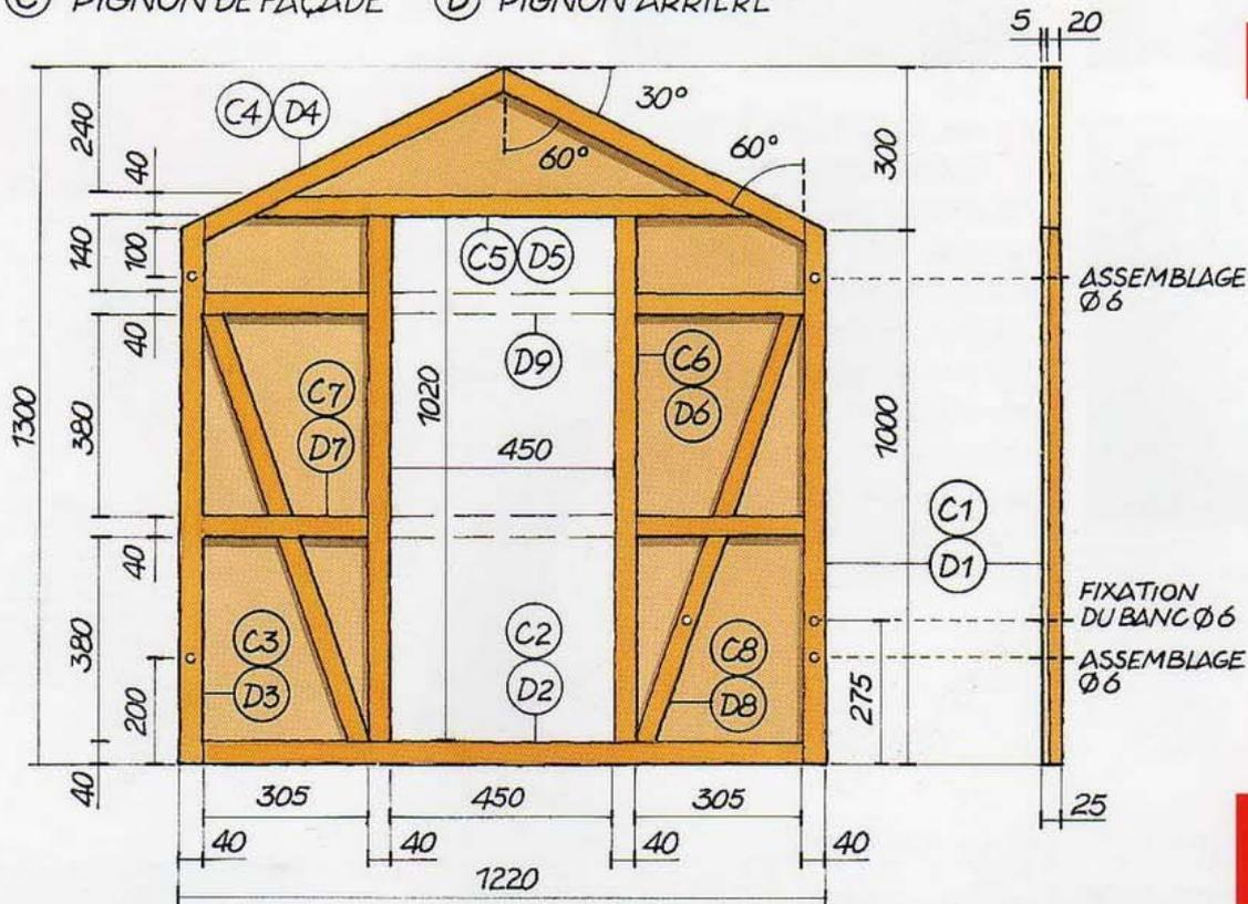
**1** Tracez avec une fausse-équerre le haut des pignons suivant un angle de 30° par rapport à l'horizontale (voir dessin). Tracez également le contour des ouvertures et percez chaque coin d'un trou Ø 10 mm. Joignez-les ensuite à la scie sauteuse.
