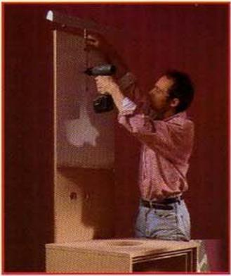
**11** Tracez au milieu haut du panneau **G** l'emplacement de la tige de fixation de l'applique à tableau. Vissez la tige (vis agglo Ø 3 x 20). Mesurez et tracez l'emplacement du miroir sur la façade arrière **G**. Recouvrez cette surface d'une couche de peinture d'accrochage.
