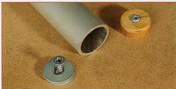
**6** Pour soutenir les cubes latéralement par deux tubes-supports, ces derniers s'embôtent sur une série de trois ou quatre rondelles ou bien une section de bois ronde ( $\varnothing$  ext. 25), traversées par des vis agglo  $\varnothing 3 \times 20$ .
