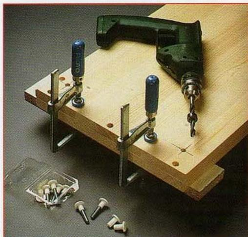
**2** Superposez et alignez parfaitement deux des côtés (A) avant de les mettre sous presse. Repérez à l'équerre les perçages (traversants) des vis de liaison et effectuez ces derniers en plaçant une planche martyre sous les deux éléments.
