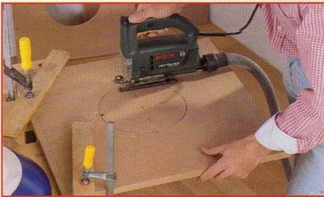
**4** Repérez le centre des plateaux **A**, **B**, **C** sur leur face intérieure. Reportez le gabarit de découpe de la vasque sur le plateau supérieur **A**. Tracez et découpez à la scie-sauteuse. (Faites le trou d'amorce avec la perceuse et une mèche à bois diam. 6.) Positionnez précisément le plateau **A** sur le plateau **B** : reportez ainsi la découpe de **B** par l'intérieur du cercle découpé sur **A**. Coupez. Procédez de même pour le plateau **C**.
