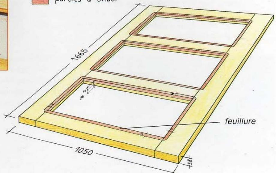
**2** Après séchage, feuillez (10 x 10 mm) les chants intérieurs du cadre du plateau de table avec une défonceuse et la fraise correspondante (voir outils). Une fois réalisées, ces feuilures accueillent les panneaux de lames.
