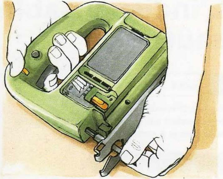
On fixe la lame, selon le modèle de scie, soit en déplaçant un levier de blocage, soit en desserrant et en serrant des vis, soit à l'aide d'une clé. Il suffit de lire attentivement la notice qui accompagne l'outil. Si votre scie sauteuse est équipée d'un galet de guidage, vérifiez que ce guidage est ajusté de telle sorte que la roulette soit en contact avec le dos de la lame au moment de l'utilisation.
