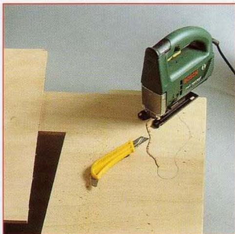
**1** Tracez au crayon les contours des autres découpes et repassez-les au cutter. Percez ensuite un trou  $\varnothing$  10 à n'importe quel endroit du tracé afin d'y introduire la lame de votre scie sauteuse.
