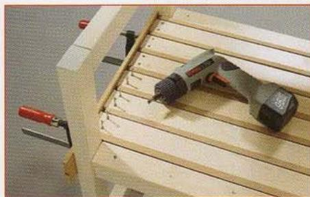
**9** Une fois la structure du siège bien sèche, vissez les lattes de l'assise avec des vis agglo  $\varnothing 3,5 \times 30$ . Percées de deux avant-trous ( $\varnothing 3,5$ ) à leurs extrémités, les lattes s'alignent contre un tasseau maintenu par deux serre-joints le long d'une des traverses latérales de l'assise. De petites cales de 12,2 mm de large (voir plan) disposées entre les lattes, garantissent leur espacement constant.
