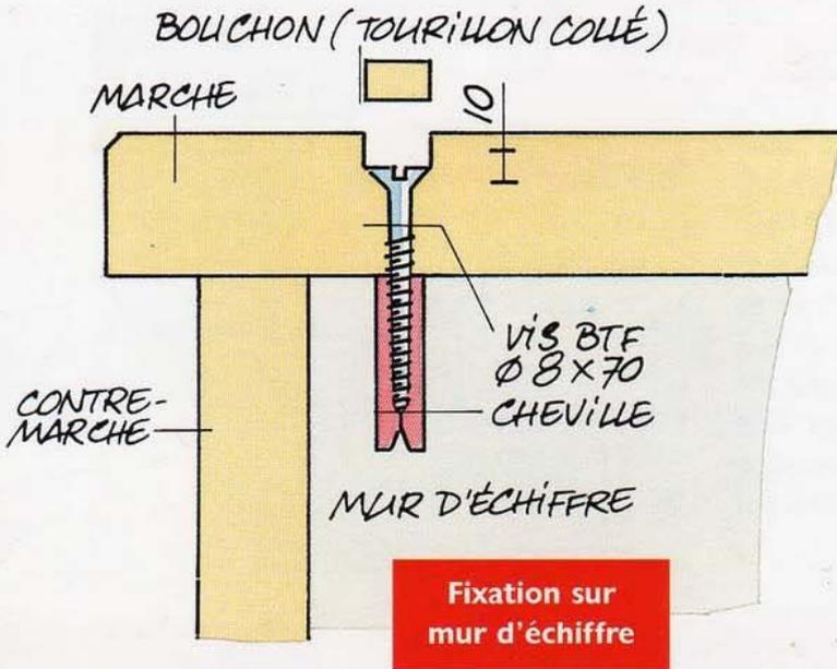
**3** Marche et contre-marche sont assemblées par un joint de colle époxy déposé sur le chant supérieur de cette dernière. On peut aussi assembler ces éléments avec des chevilles plates mais l'ajustage par rapport à la maçonnerie risque d'être plus délicat.
