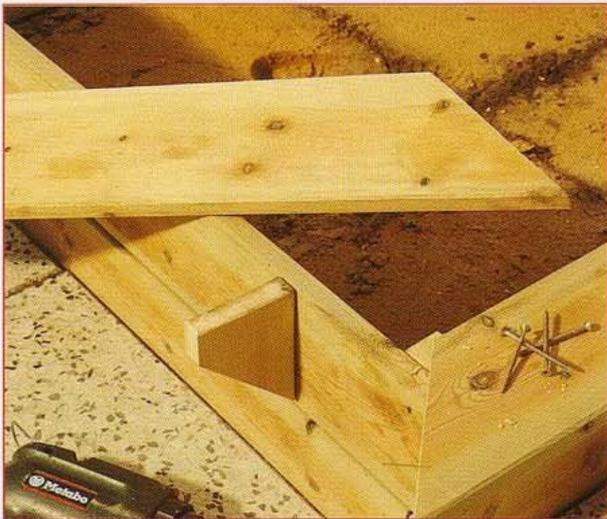
**6** et 6 bis. Tracez à l'équerre des triangles rectangles et taillez-les dans les chutes des planches. Percez deux avant-trous superposés Ø 4 (repérés à l'équerre dans le sens vertical) dans le haut des côtés de la caisse. Retournez celle-ci en la posant sur un sol bien plat. Présentez les renforts en contact avec le sol et le côté puis, vissez-les par l'intérieur (vis agglo Ø 4 x 40).
