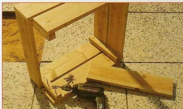
**3** Juxtaposez deux planches et alignez-les avec les extrémités de deux tasseaux. Décalez ensuite légèrement les planches sur le côté, l'une par rapport à l'autre (voir dessin). Ces jonctions décalées offrent plus de rigidité. Vissez ensuite les tasseaux dans les planches (vis aggro  $\varnothing 4 \times 40$ ).
