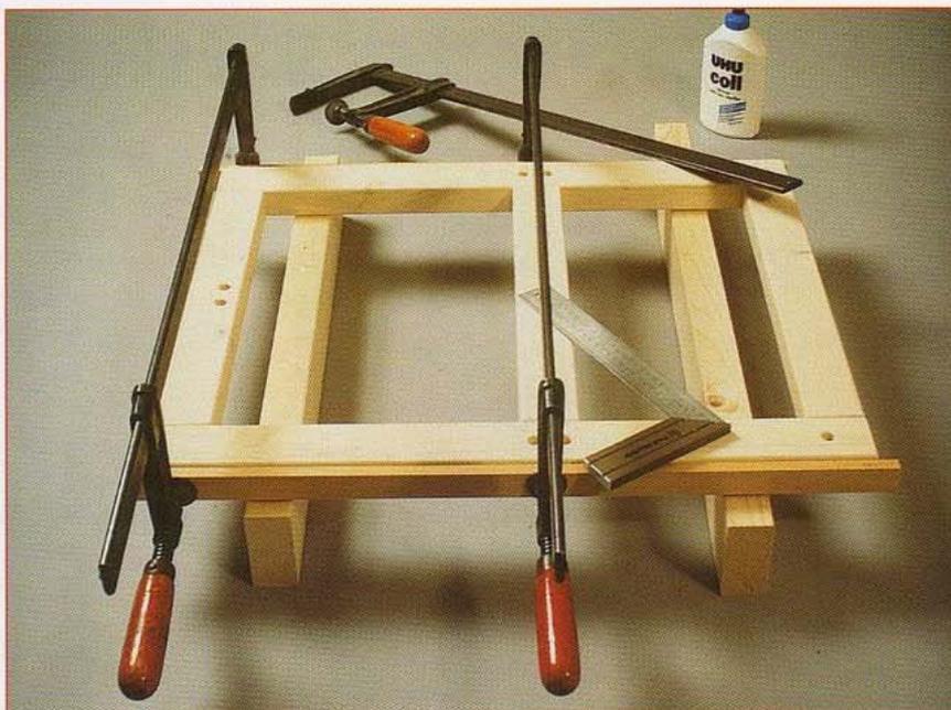
**8** Les deux côtés du siège étant secs, réunissez-les au moyen des traverses centrales et des deux éléments du dossier (préalablement assemblés par trois tourillons sur la longueur). N'encollez pas le tourillon enfoncé à chaque extrémité du dossier (voir plan d'assemblage). Ce qui lui permettra de pivoter sur lui-même et ainsi, d'être plus confortable. Assemblez et mettez sous presse en isolant les mors des serre-joints avec des cales.
