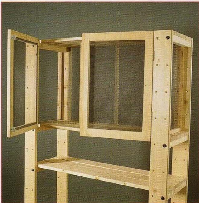
**4** Les côtés du « garde-manger » sont eux aussi garnis de panneaux à moustiquaires. La partie arrière est fermée par un panneau unique, renforcé par un montant central, assemblé à mi-bois ou avec des équerres de chaise de 30 x 30.
