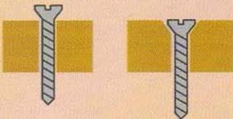
Pensez à fraiser systématiquement l'entrée des trous de vis pour pouvoir encastrer les têtes de vis dans l'épaisseur du bois.
