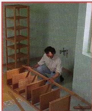
**1** Tracez les espacements entre étagères sur les huit montants **D**. Percez en série tous les trous ( $\varnothing 8$ ) sur chaque montant, sur le chant des tablettes intermédiaires **F** et sur les deux côtés des tablettes à bordure **E1**, **E2**, **E3**. Assemblez (colle vinylique, maillet et cale) chaque colonne.
