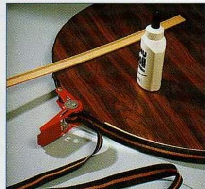
**3** Une sangle d'arrimage est parfaite pour maintenir une bande de chant autour d'un plateau. En cas de nécessité, placez un morceau de carton derrière son mécanisme pour qu'il n'endommage pas le chant.
