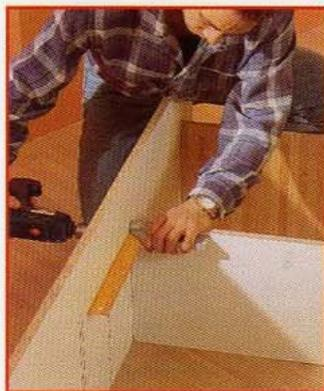
**1** Tracez sur l'envers du plateau **E** les deux cloisons intérieures **D** et les deux côtés **B** suivant les cotes de la perspective. Percez trois avant-trous (diam. 3) pour chaque élément à fixer. Collez et vissez (vis 4 x 30) les éléments **E** et **B**. L'équerre sert à maintenir chaque panneau à 90° du plateau **E**.
