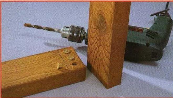
Chaque trou se coiffe d'un centreur du même diamètre : c'est un petit bouchon circulaire doté d'une pointe en son centre. Les deux pièces à assembler sont mises en contact et frappées au maillet avec une cale interposée pour ne pas abîmer le bois. Cette pointe laisse une marque de repérage pour les trous correspondants. Il ne reste plus qu'à percer le trou dans le deuxième panneau.
