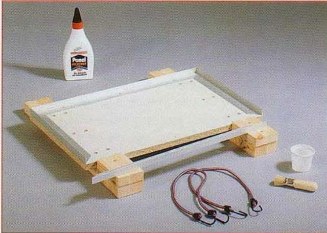
**1** Le plateau du gabarit d'assemblage des côtés et dos des cubes est vissé et collé sur deux tasseaux transversaux. À leurs extrémités sont vissées et collées deux butées de même section, de 120 mm de long (voir dessin). Vissez sur le plateau (vis agglo Ø 3 x 15 et 3 x 25) quatre cornières d'aluminium pré-perçées et coupées à 45° avec une boîte à onglet et une scie à métaux.
