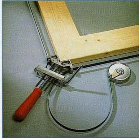
**5** Variante de la presse à cadre, cette presse est la vraie presse à feuillard. Son ruban d'acier, tendu en tournant la poignée sur elle-même, permet un serrage très puissant. Des coins (en 90°, 120° ou autres) permettent de protéger les angles fragiles lors du serrage.
