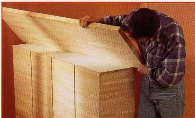
**4** Tracez le débord du plateau supérieur **G** de chaque côté de la face inférieure, soit 74 mm de part et d'autre. Percez une série d'avant-trous fraisés diam. 4 à travers le plateau intermédiaire **E**. Vissez (vis 4 x 40) le plateau supérieur **G** par l'intérieur du plateau **E**. Émoussez les arêtes du plateau au rabot. Tenez le rabot incliné et passez-le légèrement sur les angles. Terminez ce travail à l'abrasif pour une bonne finition.
