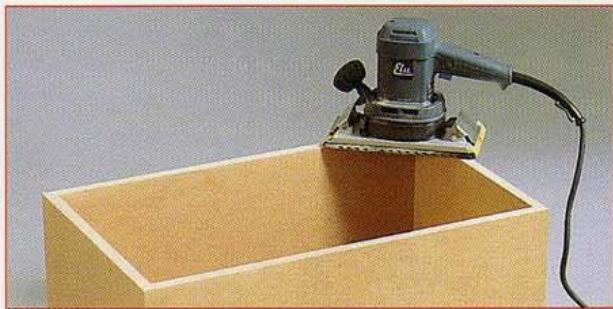
**4** Poncez les chants avant à l'aide d'une ponceuse vibrante et d'un abrasif à grain fin.
