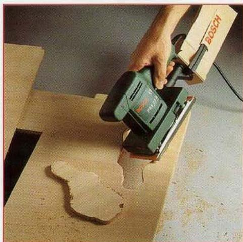
**2** Poncez ensuite légèrement les arêtes des découpes avec une ponceuse vibrante. Dans les courbes, il sera plus commode d'utiliser une râpe demi-ronde fine. Cette étape est importante car les bords des découpes ne doivent présenter aucun risque de blessure lorsqu'un enfant y passe sa main et la retire vivement.
