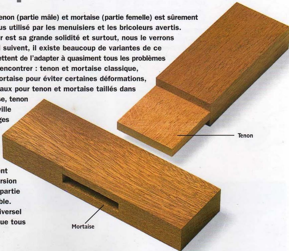
On utilise souvent l'assemblage à tenon et mortaise visible (tenon passant) dans des constructions de toutes sortes. Le chant du tenon restant visible, avec parfois des coins pour l'écarter, il s'agit d'un assemblage esthétique et pratique. Coupez toujours la mortaise en premier – il est plus facile d'adapter le tenon que l'inverse. Il est
