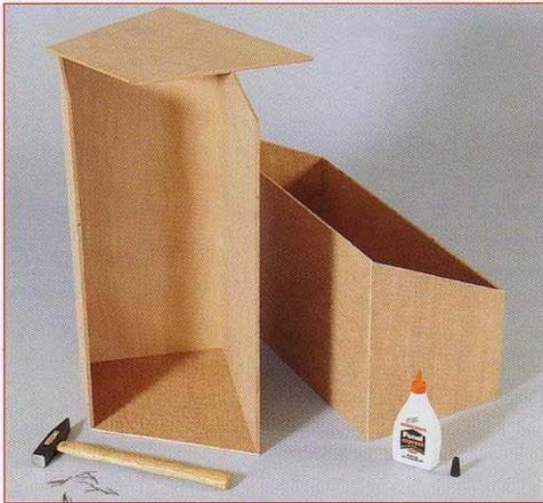
**2** Assemblez les compartiments en encollant au préalable les chants de leurs panneaux. L'aide d'une autre personne sera nécessaire pour clouer les côtés sur les chants latéraux des faces avant, dessous et dos car vu leur finesse, ils ne peuvent être tenus par des serre-joints. Utilisez des pointes à tête plate de 1,3 x 16.
