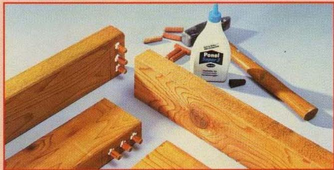
Si vous ne disposez pas de centreur, utilisez une bille de métal fixée sur un ruban adhésif double face. En positionnant le ruban adhésif entre les deux pièces à assembler et en frappant au maillet, vous obtiendrez de part et d'autre une trace qui vous permettra de repérer la position exacte des percements.
