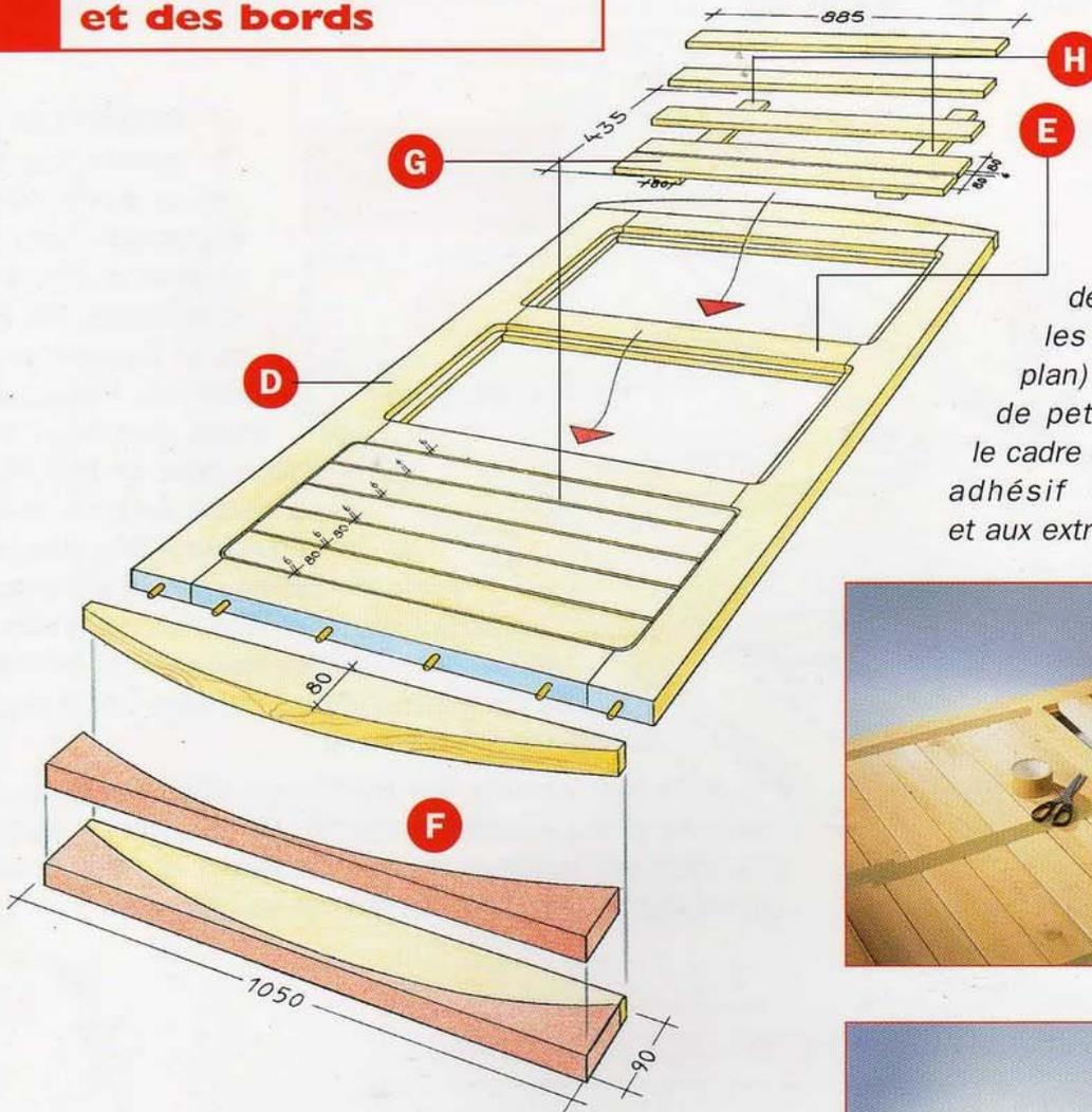
**3** Répartissez les lames sur la largeur des ouvertures à couvrir, en les espaçant de 6 mm (voir plan) ; éventuellement à l'aide de petites cales. Fixez-les sur le cadre avec des bandes de ruban adhésif appliquées au centre et aux extrémités.
