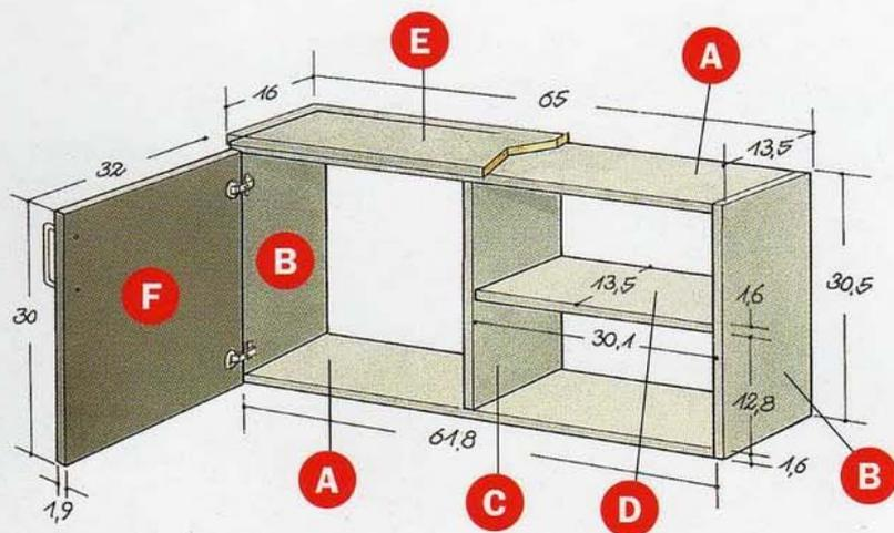
**4** Une fois les chants des portes habillés, vissez les moitiés de charnières côté portes, puis les platines correspondantes à l'intérieur des côtés. Le repérage de l'emplacement exact est précisé sur l'emballage des charnières. Pour terminer, percez des avant-trous dans le dessus et vissez par l'intérieur le panneau décoratif avec des vis de 3,5 x 30. Les mesures du dessin sont indicatives.
