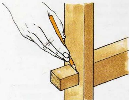
**41 Assemblage** Coupez le tenon et la mortaise, mais arrangez-vous pour que l'assemblage soit coulissant. Assemblez et marquez l'épaisseur du montant sur la partie saillante du tenon.
