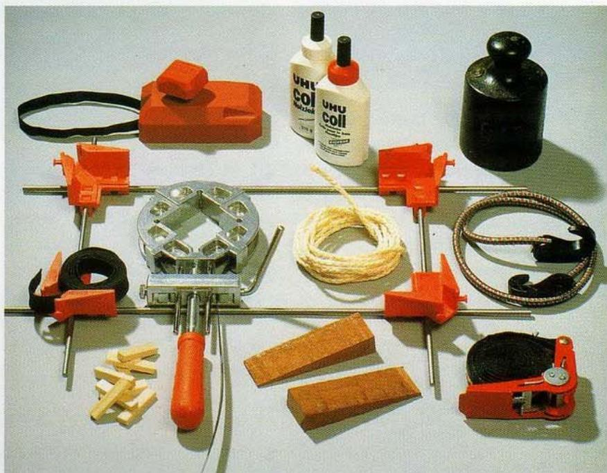
**Il faut s'assurer pour tout serrage que le système ne risque pas de glisser ou d'endommager lors de la pression certaines parties fragiles. Il est donc intéressant de pouvoir doser cette pression (par vis, coins ou poids...) exercée, de façon à ne jamais endommager les pièces maintenues.**
