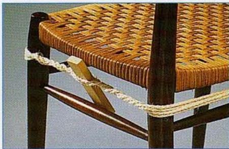
**7** Utilisée de toute éternité par les menuisiers, la ficelle nouée autour d'un objet, roulée sur elle-même et bloquée par une cale permet un bon serrage sans risque d'endommager le meuble.
