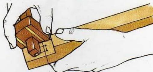
**43 Marquer l'extrémité évasée** Ajustez l'équerre coulissante à un angle de 1:6, à partir du trait qui marque l'extrémité de la mortaise de la clé ; tracez un autre trait du côté du tenon, en utilisant l'équerre. Tracez ce trait à l'équerre le long du bas du tenon, puis marquez les côtés de la mortaise de la clé jusqu'au trait.
