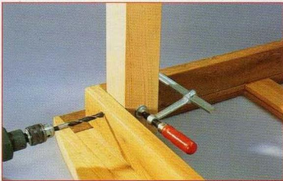
**10** Retournez le plateau à l'envers et serrez chaque pied en vérifiant son équerage. Percez-le de part en part ( $\varnothing 10$ ) à travers le bâti, en tenant compte du futur emplacement du deuxième perçage (voir photo suivante).
