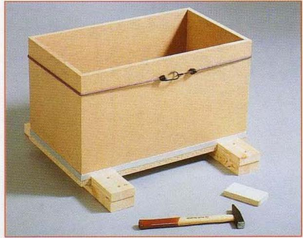
**3** Mettez sous presse en utilisant une paire de tendeurs ou une presse à cadre. Une fois le séchage terminé, soulevez doucement le cube. S'il résiste, c'est qu'un peu de colle est passée sous le dos. Retournez alors l'ensemble et séparez le gabarit en frappant à petits coups sous ses extrémités avec le plat de la main ou un marteau. Nettoyez ensuite le gabarit.
