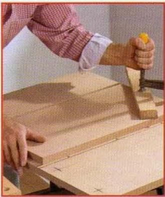
**2** Placez chaque panneau **E** face intérieure vers le haut et positionnez les côtés intérieurs **F1**, **F2**, **F3** sur le côté **E**. Encollez (colle vinylique). Maintenez avec les serre-joints et les cales de bois tendre.
