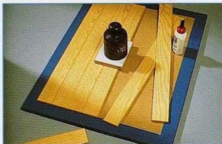
**10** Un poids, posé sur une cale répartissant sa pression, facilite un collage de surface où on ne peut utiliser de serre-joint.
