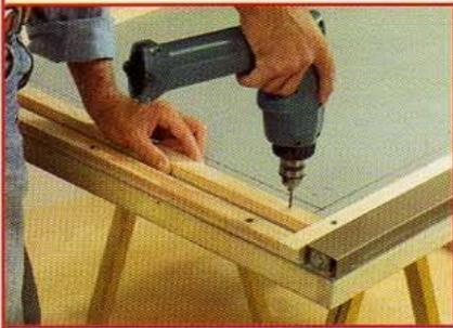
**2** Faites de même pour fixer les autres tasseaux **B** et **C**. Maintenez l'extrémité grâce au serre-joint. Vérifiez que tous les tasseaux sont bien au même nu.
