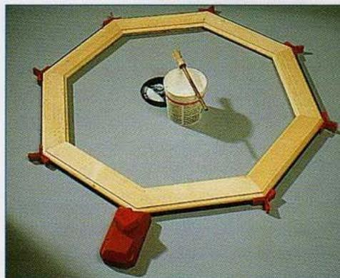
**2** Plus rapide à mettre en place qu'une ficelle, la presse à cadre se compose d'une sangle de Nylon que l'on déroule et tend autour de l'objet en tournant la molette carrée. Elle se complète de petites cales d'angle à 90°, 120° ou 135° comme ici.
