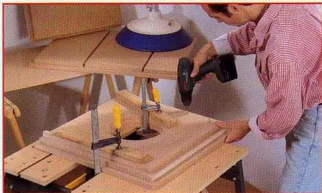
**5** Encollez (colle vinylique) et superposez les plateaux **A, B, C** face intérieure vers le haut en alignant bien les découpes de la vasque. Maintenez les trois avec les serre-joints et les cales. Percez deux séries d'avant-trous fraisés (diam. 5) le long des chants des côtés du panneau **C**. Vissez (vis agglo diam. 5 x 60) ensemble les trois plateaux. Posez la vasque dans la découpe : vérifiez le bon encastrement. Si nécessaire, ajustez la découpe (scie ou râpe).
