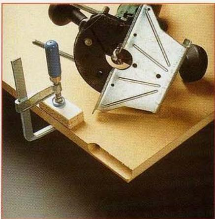
**5** Une défonceuse et une fraise à demi-gorge ( $r = 9,5$ ) sont nécessaires pour fraiser le haut du chant gauche de la porte inférieure (v. dessin). Ce fraisage remplace une poignée.
