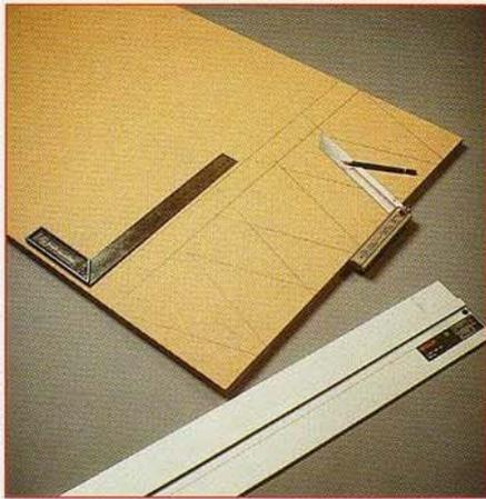
**4** En haut de la porte supérieure, tracez les pointes des crayons, soit avec une fausse-équerre soit grâce à des repères décalés sur deux rangées. Effectuez les découpes avec une scie circulaire et son rail-guide ou à la rigueur, à la scie sauteuse.
