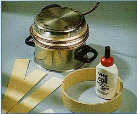
**4** Pour coller une bande de bois mince (1 mm) sur elle-même et lui donner une forme circulaire, on l'enroule autour d'un ustensile de cuisine du diamètre requis et on l'immobilise par un élastique tubulaire ou un tendeur.
