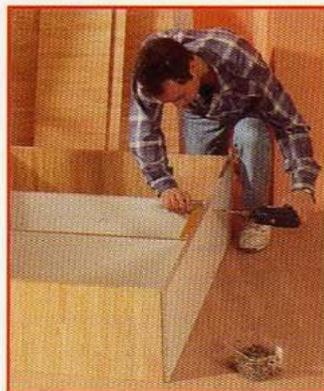
**2** Fixez de la même façon le plateau inférieur **A** : colle vinylique et vis 4 x 30.
