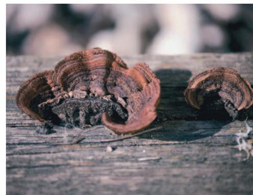
Wenn sich der Pilzkörper des Blättlings an der Oberfläche zeigt, ist das Innere des Bauteils bereits zerstört und zerfällt in braune Würfel.
