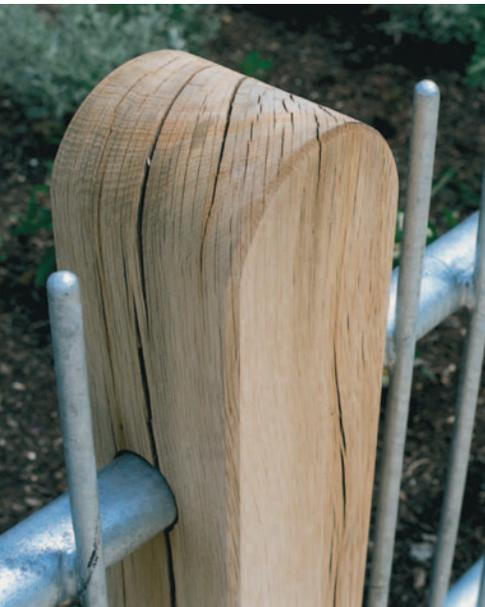
*Obwohl Eichenholz stark reißt, kann es aufgrund seines hohen Gehaltes an Gerbsäure und seiner Härte auch ohne zusätzliche chemische Schutzmaßnahmen für Pfosten in direktem Erdkontakt verwendet werden.*
