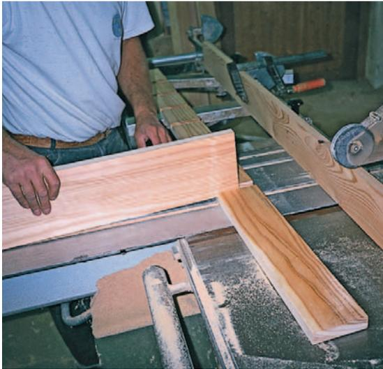
◀ 1 In Bretter, die bereits auf die geforderte Stärke vorgehobelt wurden, werden die Aussparungen für die Verblattung der Spalierhölzer eingefräst.
