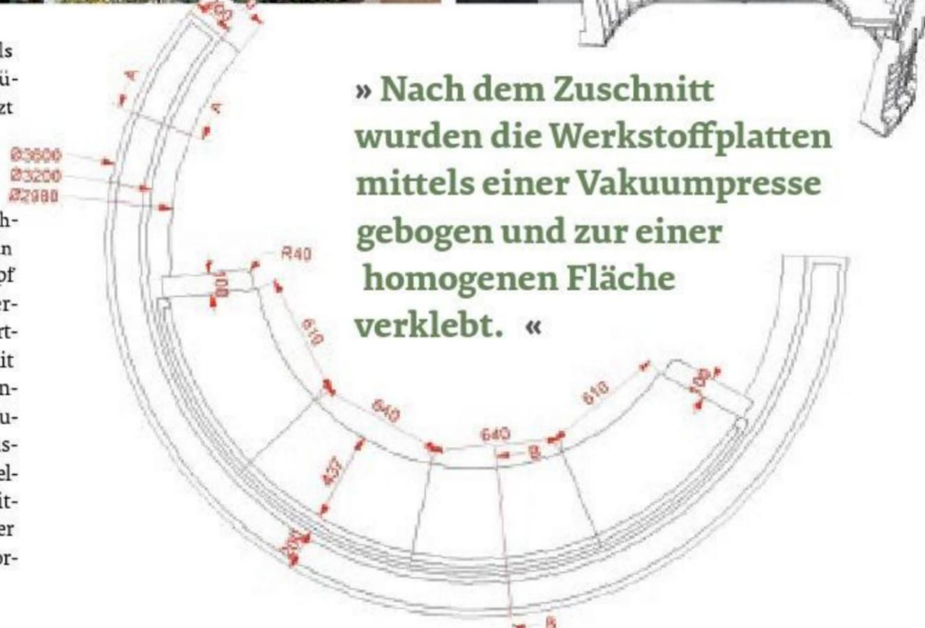
» Nach dem Zuschnitt wurden die Werkstoffplatten mittels einer Vakuumpresse gebogen und zur einer homogenen Fläche verklebt. «
