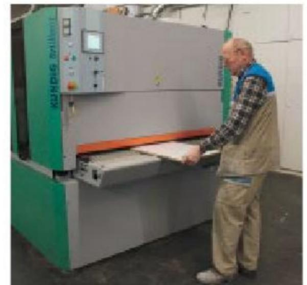
tung von Corian gehört ebenso dazu wie das Schleifen von Hochglanzoberflächen mit besonders feiner 1500er-Körnung oder auch das Kalibrieren von Compactplatten. Für ein spezielles Muster in einer Bibliotheksrückwand frästen Wielachs Mitarbeiter zuerst die Form auf der CNC bis knapp unter die Deckschicht. Die letzten zwei Millimeter wurden dann mit der Kündig weggeschliffen.
