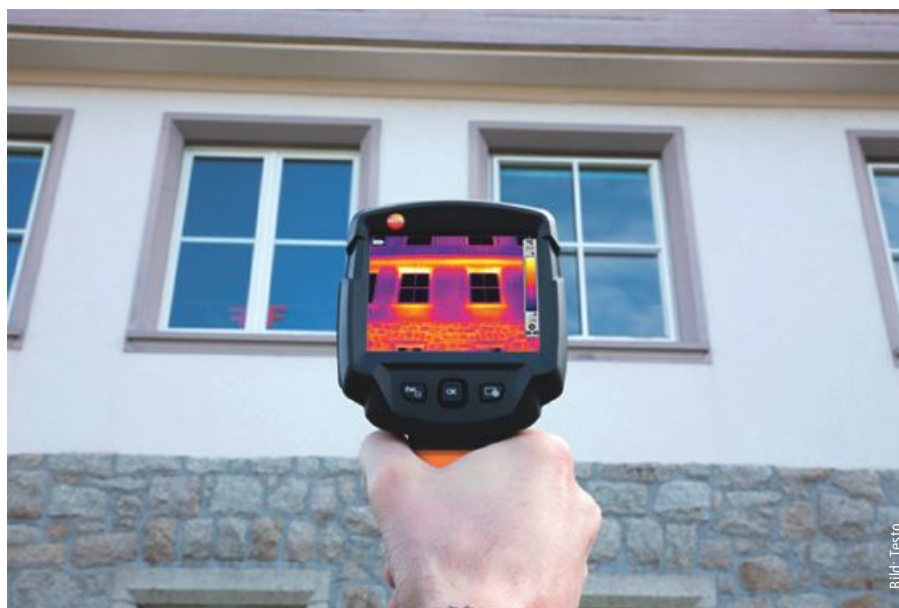
Kompaktkameras ermöglichen eine Vorablokalisierung von Wärmebrücken, Leckagen oder undichten Fenstern. Um die Ergebnisse richtig deuten zu können, sind Fachwissen und Erfahrung erforderlich.
