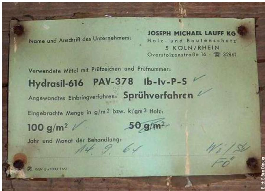
Bild 3: Foto einer alten Dachkarte über die Behandlung des Dachstuhls mit dem Holzschutzmittel Hydrasil-616
