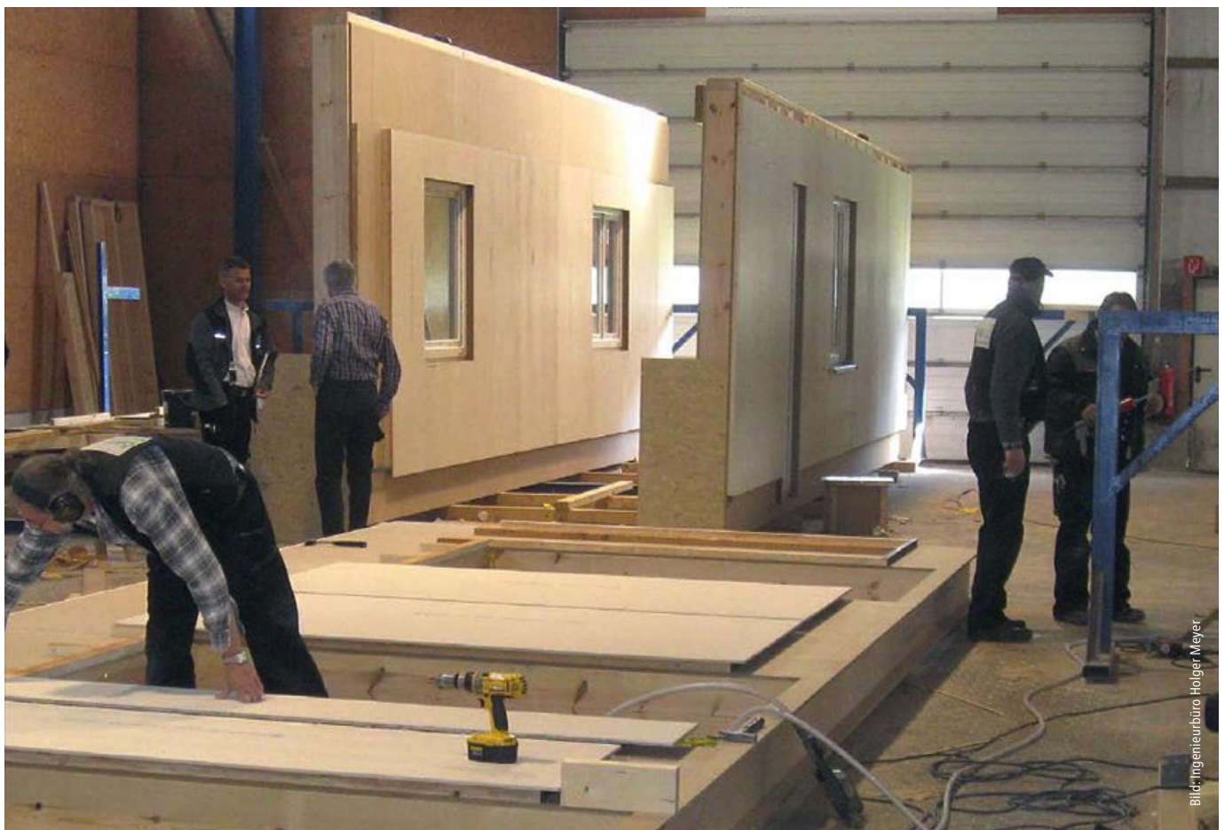
Fertigungsstufen 3 und 4: Im Vordergrund wird eine Fassade aus hinterlüfteten Putzträgerplatten montiert. Im Hintergrund ist die Fenstermontage im stehenden Element bereits erfolgt.
