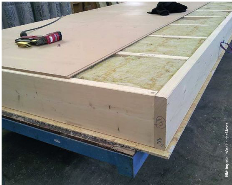
Fertigungsstufe 2: Nach dem Wenden des Elements wird der Dämmstoff eingebaut und die Unterdeckung aus Holzfaserplatten hergestellt.
