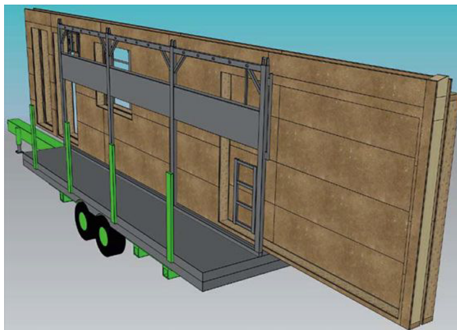
5 | Gegenüber einem Anhänger mit Mittelrungen gibt es nur einen minimalen Verlust an Ladefläche, weil die Stege im Bock hochklappbar sind und somit im Innenraum des „H-Bocks“ auch Wände transportiert werden können. Im Betrieb sollten die für den Innenraum des Bocks vorgesehenen Wände erst nach den anderen (hier nicht dargestellt) verladen werden, da der Steg danach nicht mehr zur Verfügung steht. Das Entladen erfolgt umgekehrt.
