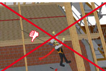
12 | Deshalb nicht! Ein Pendelsturz kann sehr schmerzhaft enden, weil das HSG die Horizontalbeschleunigung nicht verhindern kann.
