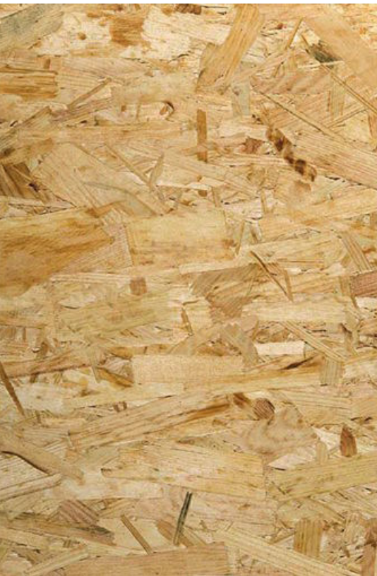
Die typische Plattenstruktur von OSB entsteht durch die in drei Lagen längs, dann quer und wieder längs aufgetragenen Späne.
