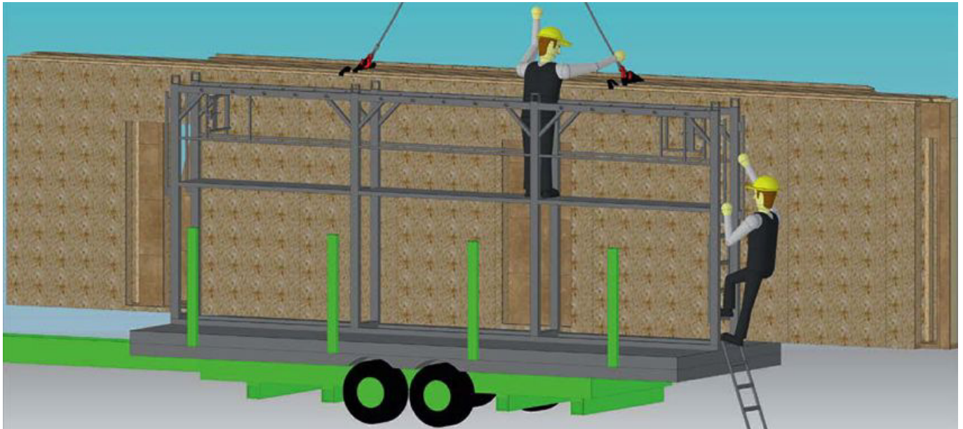
4 | Mit dem „H-Bock“ hat der Anhängerhersteller Auwärter eine technische Maßnahme geschaffen, die ein sicheres Be- und Entladen von Wänden ermöglicht. Der Anschläger hält sich dabei auf einem Steg in der Mitte der Ladung auf und muss nicht mehr in den Bereich mit Absturzgefahr oben auf den Wänden steigen. Leitern für den Aufstieg sind in den Bock integriert. Selbstschließende Klapptüren verhindern, dass der Anschläger beim Rückwärtsgehen versehentlich das Ende des Stegs erreicht.
