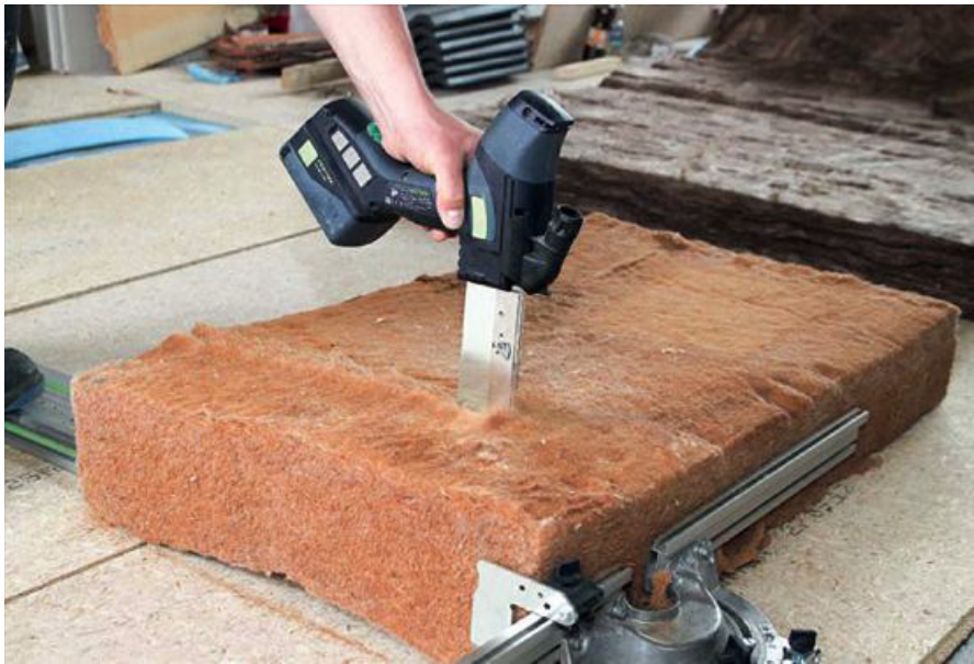
Die Zimmerei Linhart beschriftet die Sägeblätter für abrasive Dämmstoffe wie Stein- und Glaswolle und für Holzfaserstoffe. Mit dem werkzeuglosen Sägeblattwechsel ist im Nu gewechselt und man kann insgesamt so viele Laufmeter schneiden.
