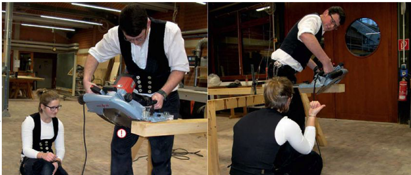
1+2 | Gelegentlich sieht man noch die umständliche Ermittlung des Maschinenwinkels für einen Schifterschnitt durch Einfluchten der Sägeneigung. (Mit Auszubildenden nachgestellt.) Achtung! Bei eingezogener Schutzhaube liegt das Sägeblatt frei! Finger weg vom Schalter! Das geht besser und sicherer!
