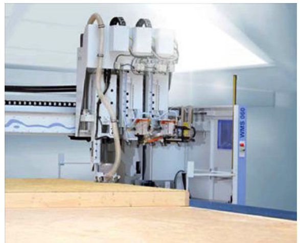
Mit der Zimmermeisterbrücke sollen Elemente in Holzrahmenbauweise effizient und genau gefertigt werden können.
