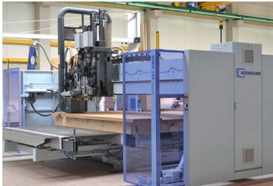
Holzfaserplatten werden mit der Multifunktionsbrücke vollautomatisch bearbeitet.
