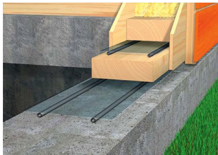
Die Dichtung besteht aus einer PE-Folie mit zwei aufgebrachten Dichtungsschläuchen. Sie wird unter anderem zwischen Fundament und Wandelement eingesetzt.
