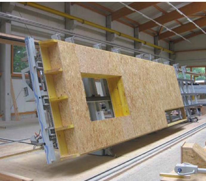
Auch Dach-Decken-Elemente oder Sonder-Elemente werden mit der CNC-Technologie vollautomatisch hergestellt.
