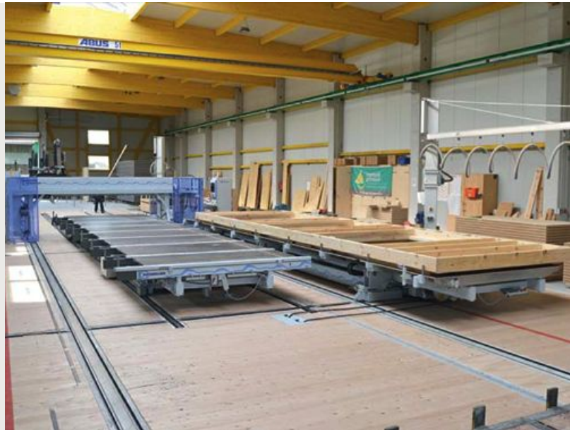
Die Engelhardt & Geissbauer GmbH fertigt alle Elemente mit der Kompaktanlage auf 34 \times 9 \text{ m}^2 .
