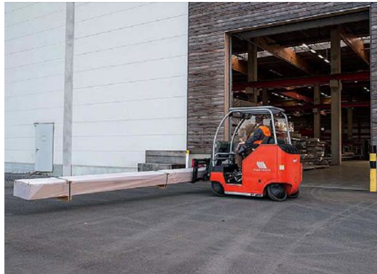
Dank des patentierten Radsystems fährt der Stapler in jede Himmelsrichtung und eignet sich für das Handling langer Güter in engen Räumen.
