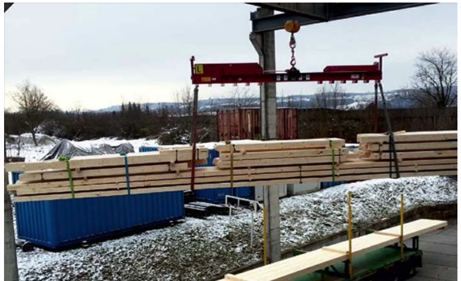
14 | Funktraverse Ludwig Simia Spreader im Einsatz beim Verladen von Lasten mit außermittig liegendem Schwerpunkt. Durch Verschieben des Anschlagpunktes mit einem Hydraulikstempel kann die Last exakt waagrecht ausgerichtet werden.
