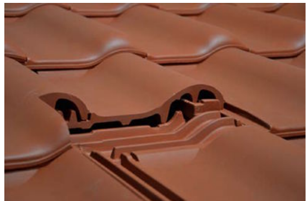
Die Dreifachverfaltung soll mit dafür sorgen, dass trotz sehr geringer Dachneigung kein Regenwasser in die Dachkonstruktion eindringt.
