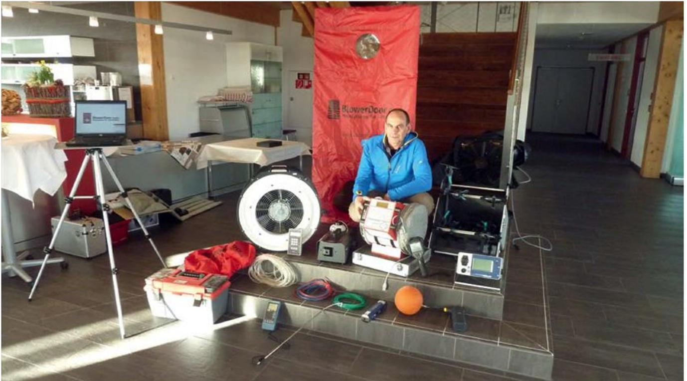
6 | Verschiedene Messeinrichtungen werden für die Luftdichtheitsprüfung benötigt. Die Anforderungen an die Volumenstrommesseinrichtungen sind in DIN EN 13829 dargestellt. Für die Luftdichtheitsmessung können auch andere Luftfördereinrichtungen eingesetzt werden.
