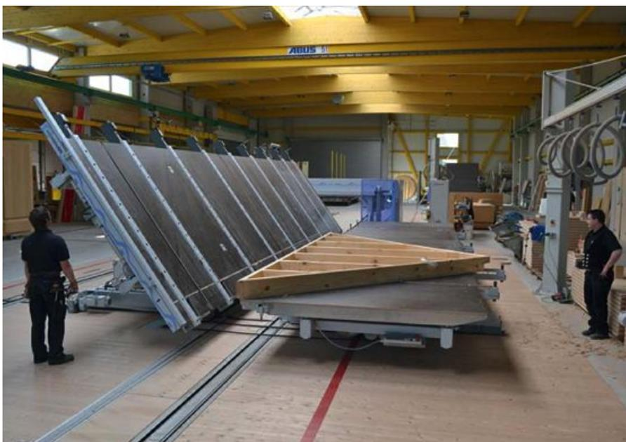
Auf nur 34 x 9 m<sup>2</sup> werden Wand-, Dach-, Decken- und Giebelelemente automatisiert hergestellt.
