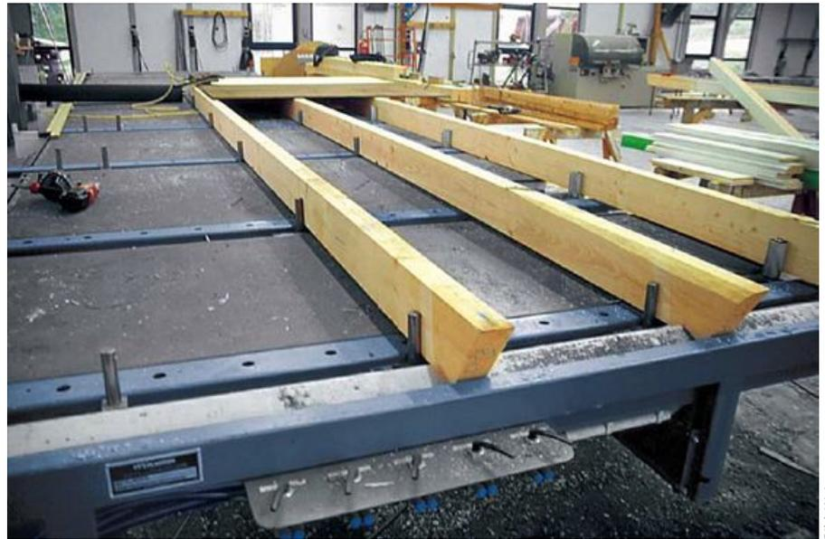
Dach- und Deckenspanner machen das Ausrichten der Deckenbalken wesentlich einfacher.
