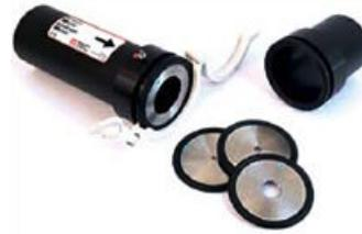
Mit einem Messbereich von 0,17–78,5 m<sup>3</sup>/h ist das MLM (oben) auch für Bauteilprüfungen und Messungen in kleinen und sehr dichten Reinräumen geeignet. Die 2014 patentierte Volumenstromhaube des FlowBlaster (unten) soll eine exakte Messung des Luftvolumenstroms gewährleisten, indem die für eine hohe Präzision erforderliche Strömungsgleichrichtung erzielt wird.
