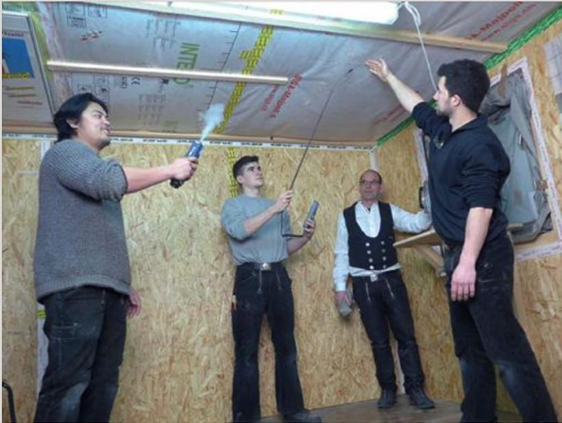
Im Kurs „Energieeffiziente Dachsanierung“ (MDB-Kurs 3. Lehrjahr) im Bildungszentrum Baden-Württemberg in Biberach ist die Luftdichtheitsmessung Bestandteil der Kursinhalte. Hier werden Grundlagen vermittelt zwischen Luftdichtheitstest und Luftdichtheitsprüfung. Die praktische Umsetzung erfolgt im eigens erstellten Prüfraum. Dort wird den Auszubildenden anhand vieler Einbauteile sowie verschiede-
