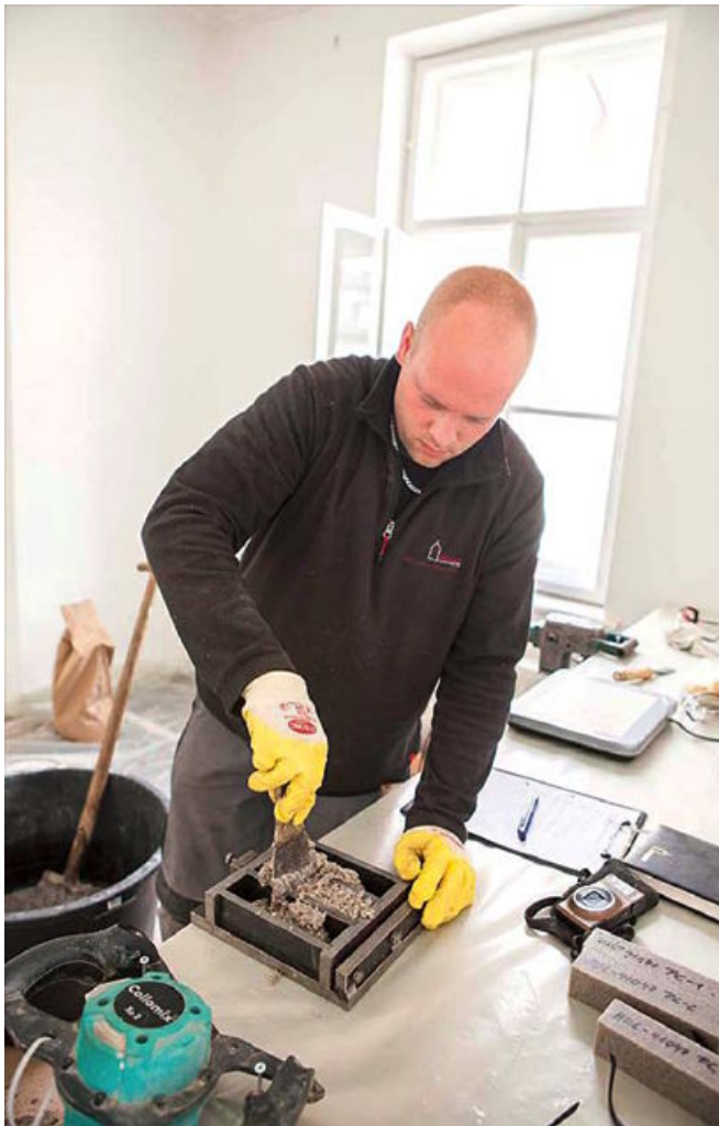
Die unabhängige Qualitätskontrolle erfolgt für jedes Bauprojekt durch Prüfkörper, die an die externe Überwachungsstelle versandt werden.
