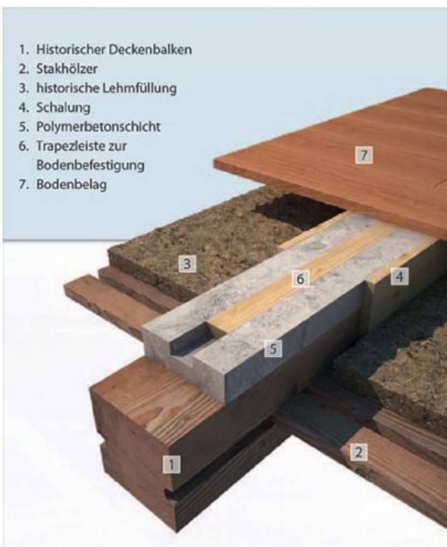
Die Grafik zeigt den Aufbau historischer Balkendecken, nach einer Sanierung mit Polymerbeton.
