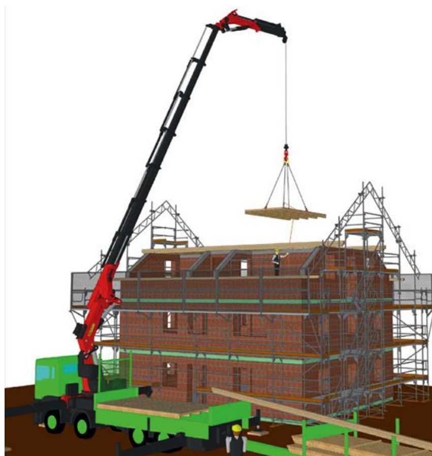
7 | Wenn der Kran für die komplette Kehlbalckenlage zu schwach ist, werden einzelne, im Betrieb vorgefertigte Kehlbalckenelemente zwischen die bereits montierten Mittelpfetten gelegt. (Bei unter den Mittelpfetten liegender Kehlbalckenlage ergibt sich ein abweichender Montageablauf.)
