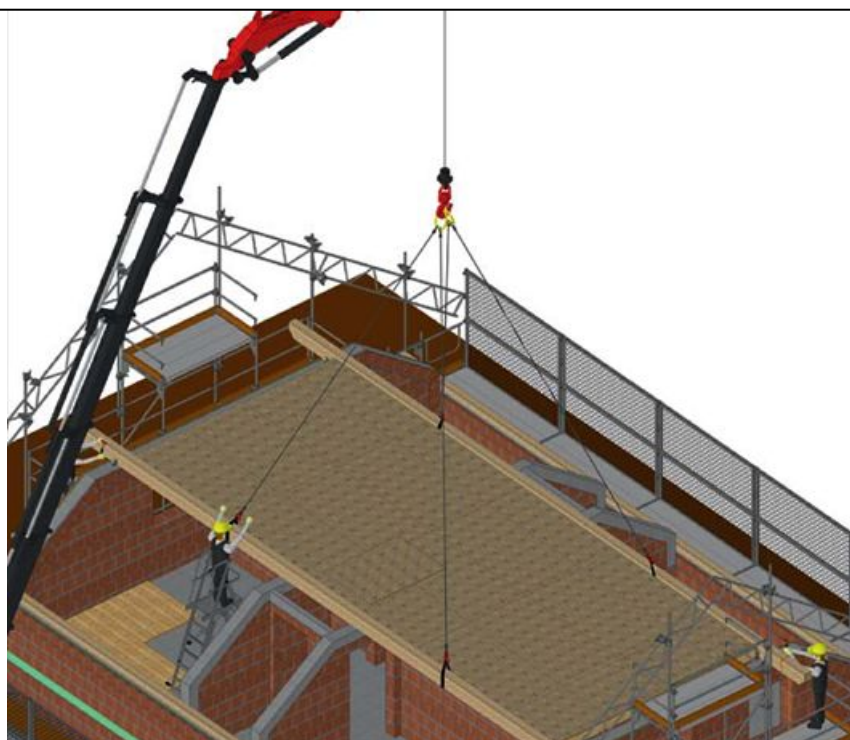
6 | Geschafft! Das Element ist auf den DG-Wänden abgesetzt. Die Öffnung der Bodentreppe ist abgedeckt. Absturzkanten stellen jetzt nur noch die Längsaußenkanten der Mittelpfetten dar.
