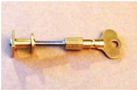
2 The Staufer neck screw – 'Halsschraube'
