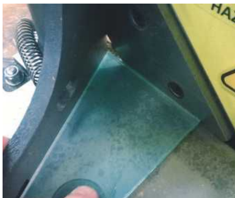
4 Setting up the mitre trimmer angle
