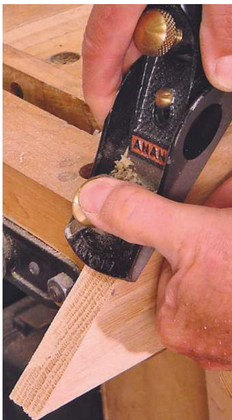
4 I cleaned up the top edge mitre...
