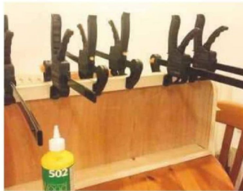
17 Clamping the lid hinge rail
