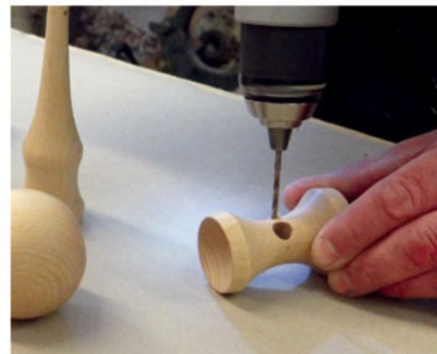
▲ Drilling the sarado.
