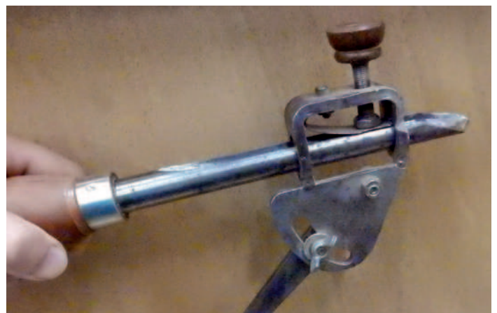
Bowl gouge in Vari-Grind jig
