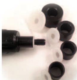
UM Mandrel using Bushings!
