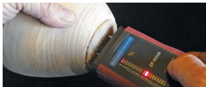
Checking the moisture content using a moisture meter
