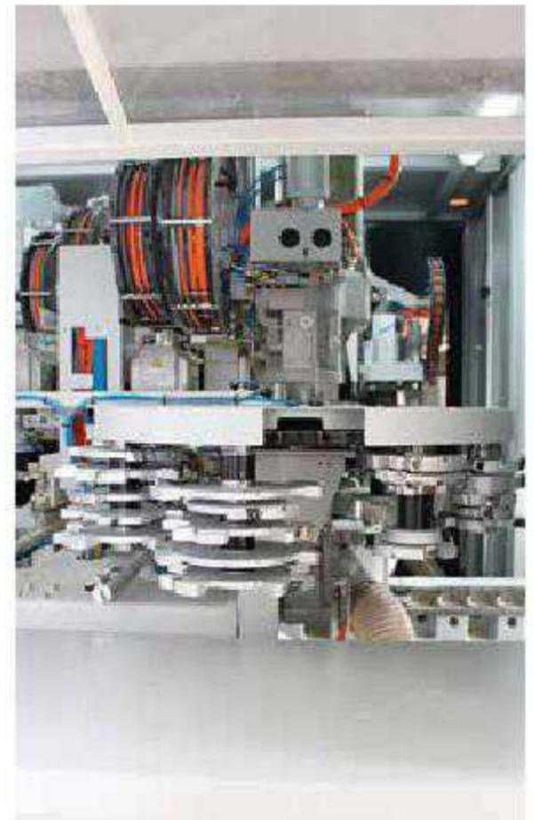
Bei der stirn- und der längsseitigen Bearbeitung der Fensterhölzer kommen die Hybrid-Werkzeuge von Oertli zum Einsatz.
