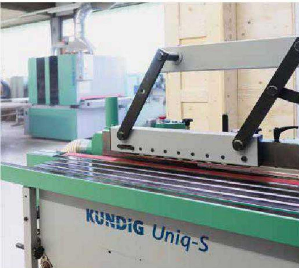
**Der Betrieb hat gleich zwei der Schweizer Präzisionsschleifmaschinen – eine Breitband- und eine Kantenschleifmaschine.**
