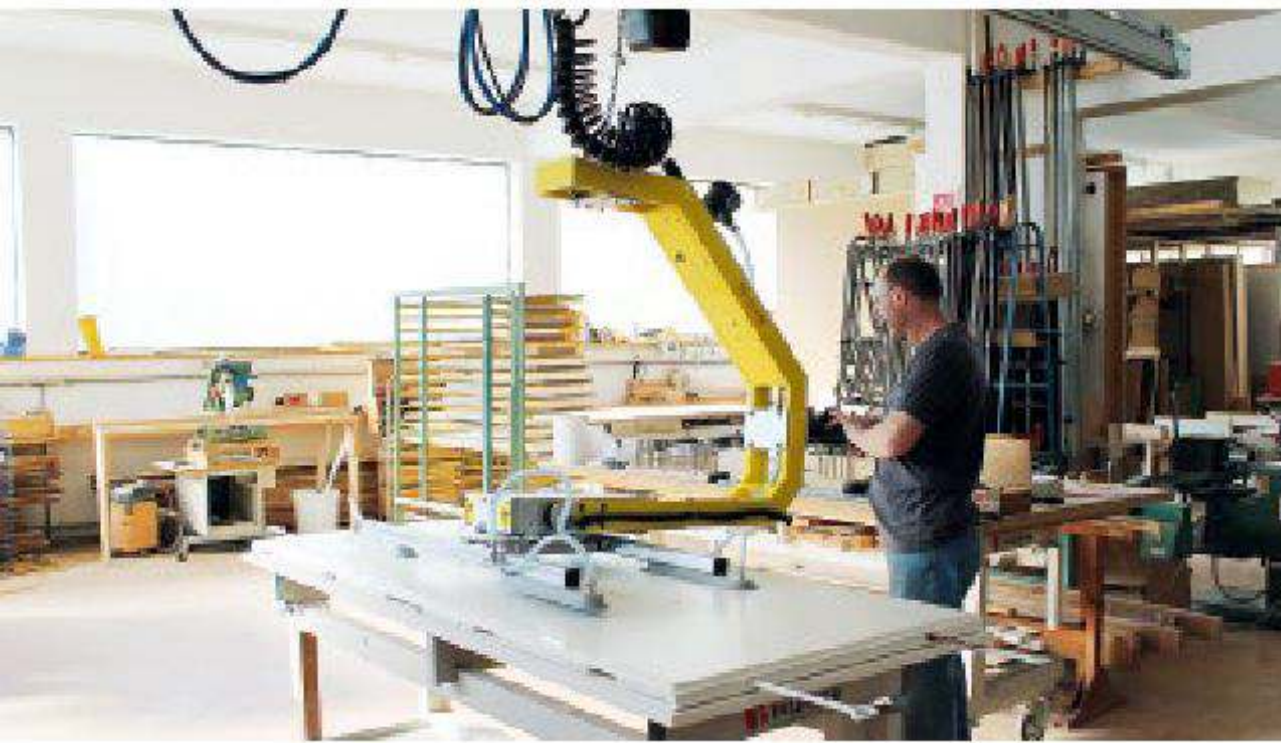
Eine der jüngsten Anschaffungen: Ein Hebekran, mit dem sich auch die bis zu 80 Kilogramm schweren Türflügel heben und wenden lassen.
