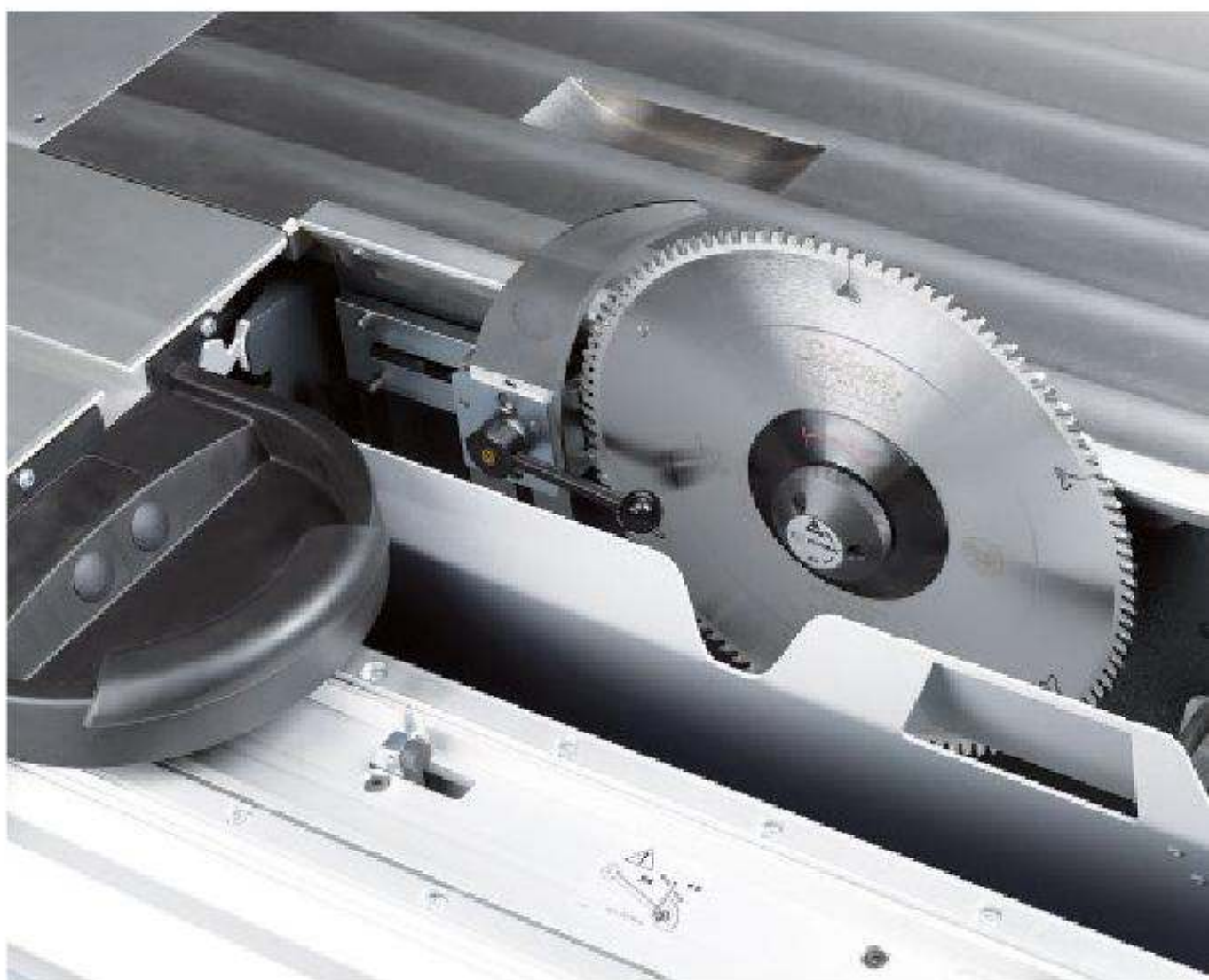
Felder hat das innovative Format-4-Sägeblatt-Schnellwechselsystem „Easy-Lock“ wieder weiterentwickelt.
