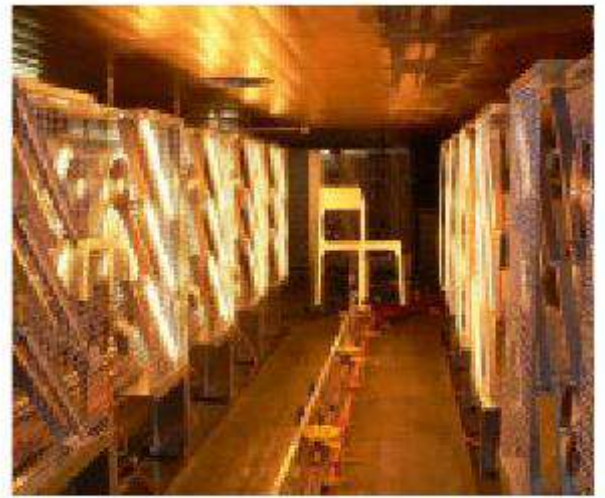
Infrarottrocknung im Einsatz: Die anspruchsvolle Teilgeometrie der lackierten Stühle stellt für die Technologie kein Problem dar.
