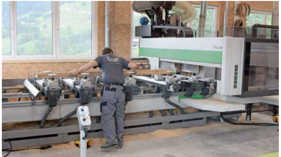
Auf der CNC kann der Betrieb auch Stock-Kantel bearbeiten, die Maschine ist mit automatischem Rüsttisch ausgestattet.
