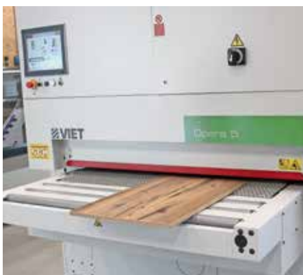
Mit dem neuen Schleifzentrum Viet Opera A können die Tischler jetzt längs und quer schleifen.
