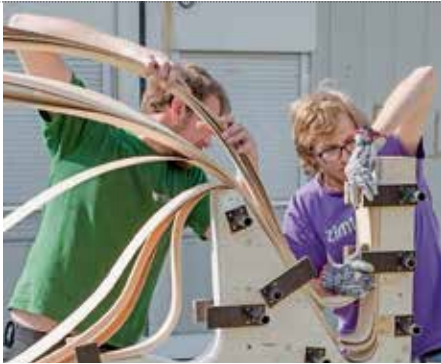
Schwinge und Holm wurden aus elf Schichten verleimtem Eschenfurnier in Form gebracht.
