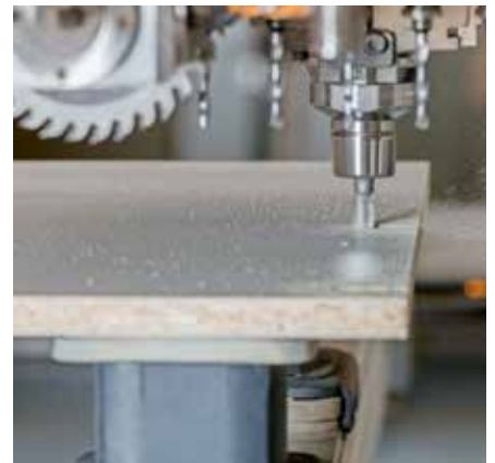
Die Bearbeitung für den Cabineo-Verbinder kann mit allen CNC-Maschinen erfolgen.
