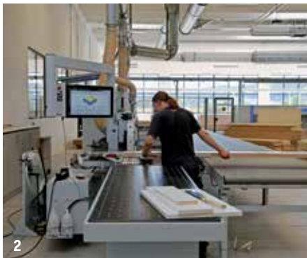
1: Für die Bearbeitung der 3D-Elemente hat man sich auch eine Fünf-Achs-CNC von Homag zugelegt.
