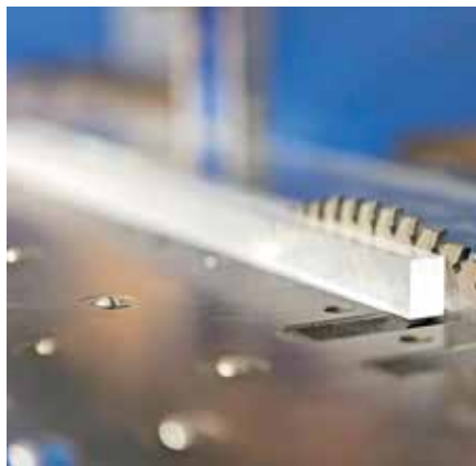
BrillianceCut-Sägeblatt von Leitz für die Bearbeitung von transparenten Kunststoffen
