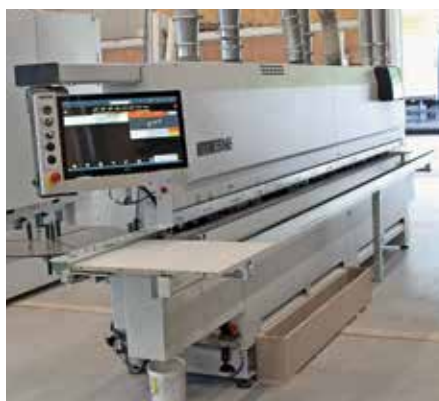
Die Kantenanleimmaschine Akron 1400 ermöglicht dank des Wechselleimbeckens die Verarbeitung von EVA- oder PUR-Kleber.
