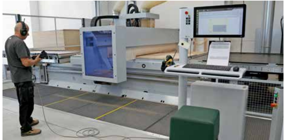
Mit der Homag BHP 200 Nestingmaschine werden die flächigen Teile bearbeitet.
