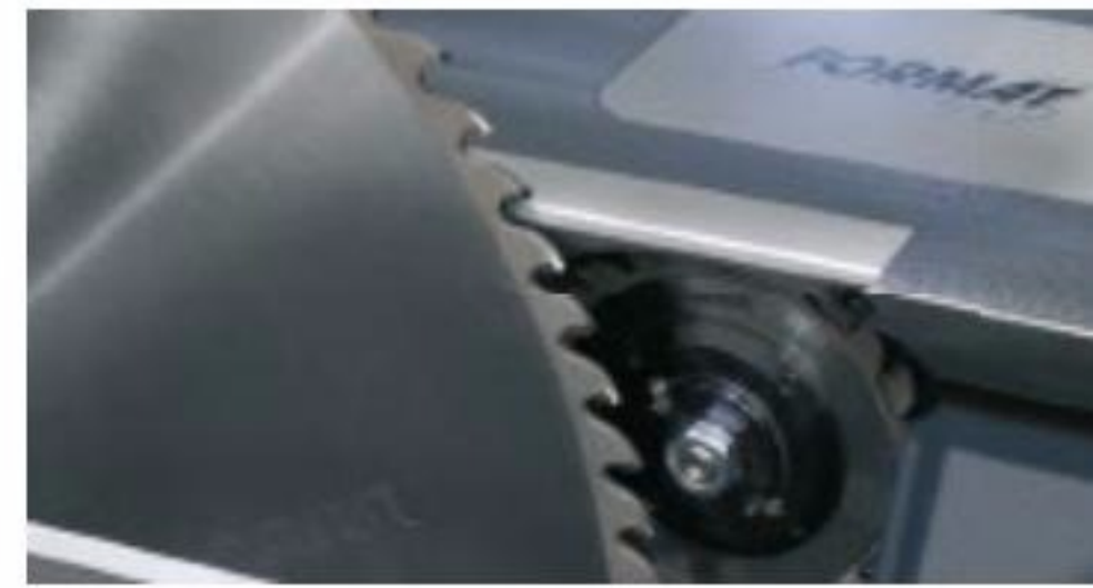
Vorritzer-Parkposition - Nie mehr Vorritzer ausbauen
