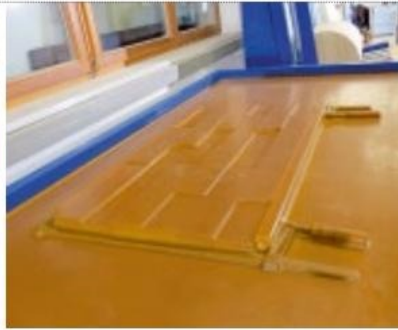
Die Schraubzwingen werden einfach unter der Membran mit eingespannt.
