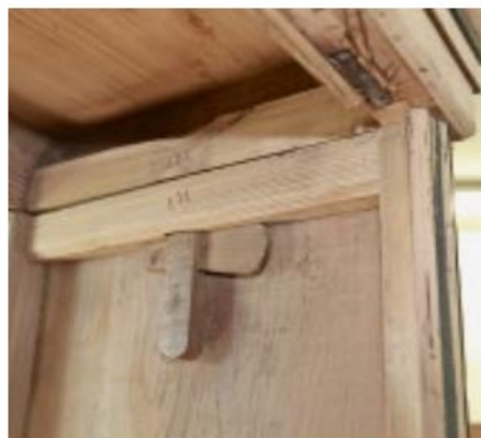
Steckverbindungen sorgen dafür, dass der Kasten auch wieder zerlegt werden kann.
