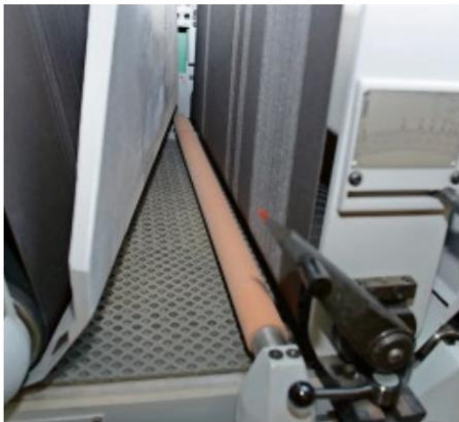
Das schräg gestellte Diagonalaggregat eignet sich gut zum Schleifen quer furnierter Teile.
