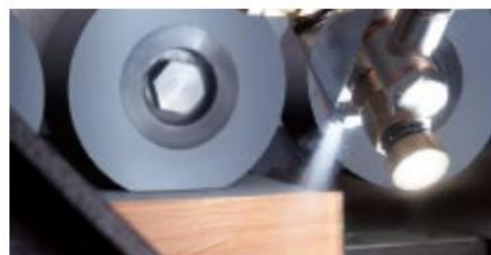
Sprüheinheit für perfektes Finish
