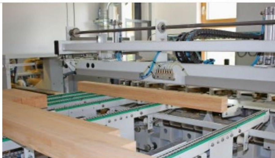
Die CNC-Fensteranlage Conturex Compact verarbeitet Rohkanteln bis maximal 4,5 Meter.
