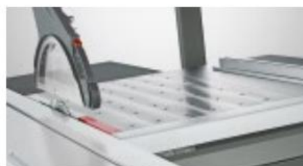
Der optionale Luftkissentisch reduziert den Reibungswiderstand zwischen Material und Maschinentisch.
