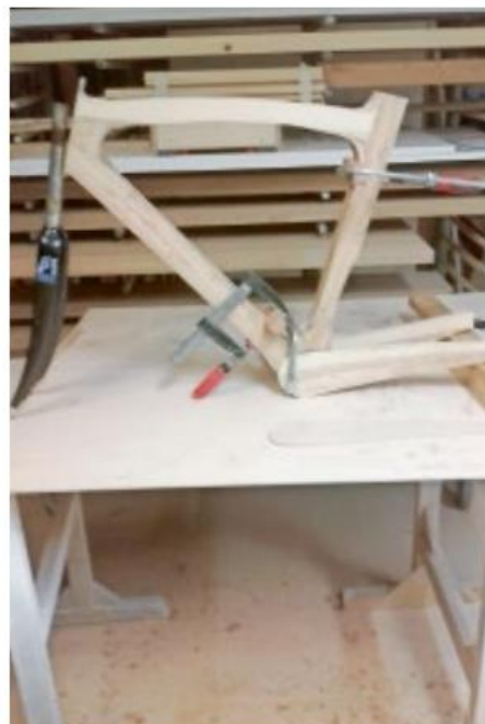
Insgesamt benötigte er für die Fertigung des Holzfahrrades über 140 Arbeitsstunden. Das Gesamtgewicht des Rades beträgt 10,9 kg.
