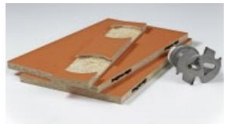
Mit dem Clamex-Paket lassen sich die horizontalen und vertikalen Taschen für das Lamello-P-System fräsen.
