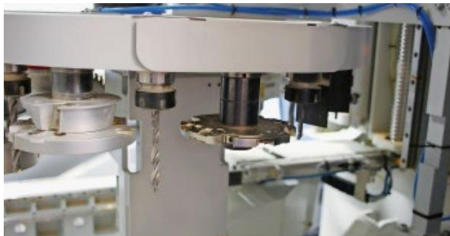
Im Werkzeugwechsler ist Platz für 70 Werkzeuge zum Fräsen, Bohren und Profilieren.
