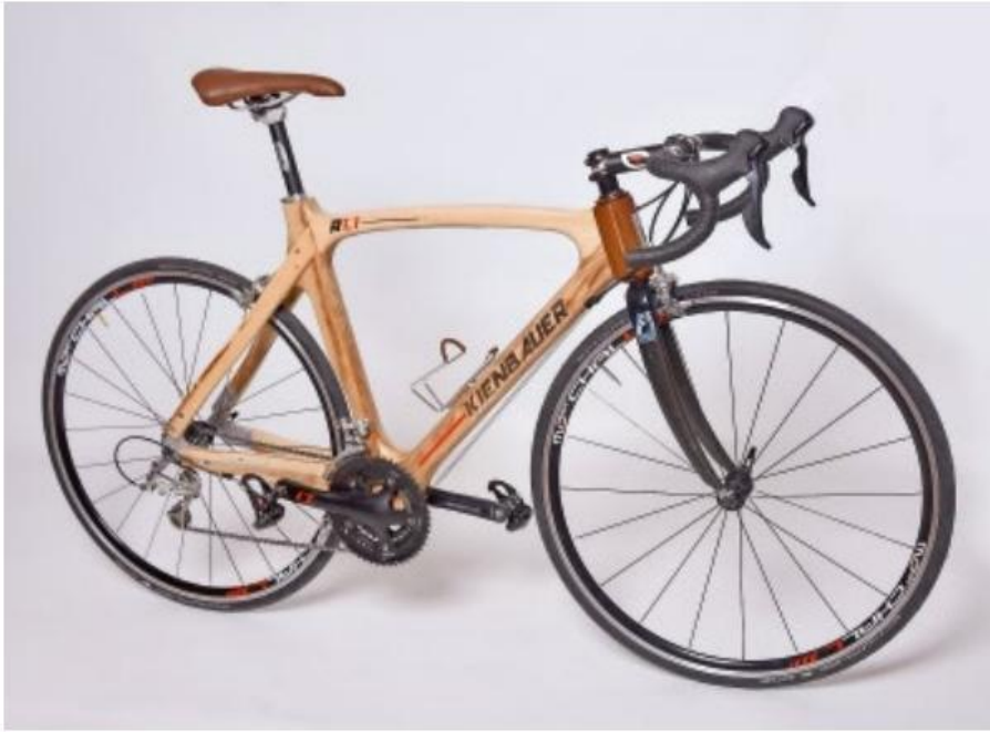
Für den Rahmen verleimte der Tischlermeister 2,5 mm starkes Furnier und schnitt daraus die benötigten Teile heraus.
