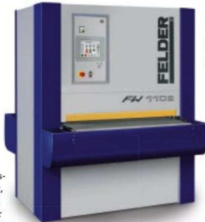
Felder bietet seine Breitbandschleifmaschinen als Baureihe an. Das Modell FW1102 bietet etwa auch ein Kontaktwalzenaggregat zum Kalibrieren.
