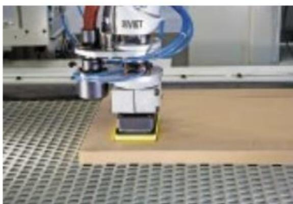
Robotergesteuerte Schleifmaschine von Biesse.
