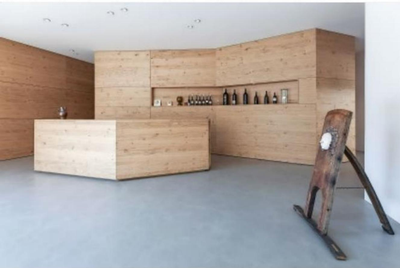
Die Pultmöbel wurden analog zu den Wänden mit Kaindl-Furnierplatten in Eiche astig realisiert, die oberste Ablage ist in Eiche massiv ausgeführt.
