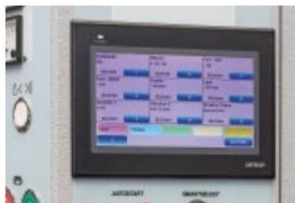
Die Touchpad-Steuerung wie hier bei Kündig ermöglicht das bedarfsgerechte Abarbeiten von bereits erstellten Schleifrezepten.
