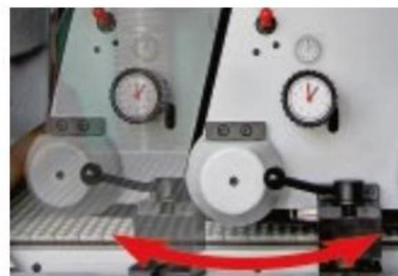
Durch die Schrägstellung des Schleifaggregates bei Kündig-Maschinen verändert sich das Schleifbild.
