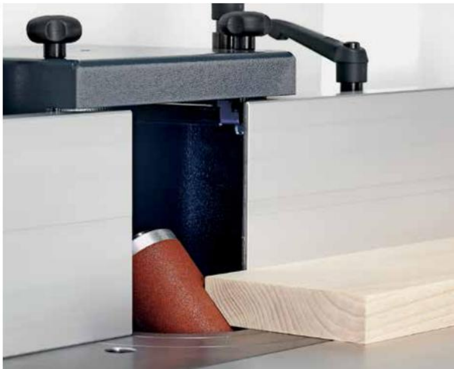
Schleifzylinder werden in den Durchmessern 30 bis 130 mm je nach Hersteller angeboten. Dazu kann handelsübliches Schleifpapier in unterschiedlichen Breiten verwendet werden.
