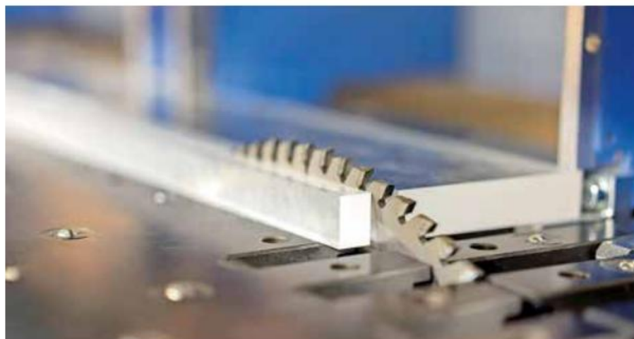
Das BrillianceCut-Sägeblatt liefert dank spezieller Geometrie vor allem in der Bearbeitung von Acrylglas oder Platten aus Polycarbonat gute Ergebnisse.
