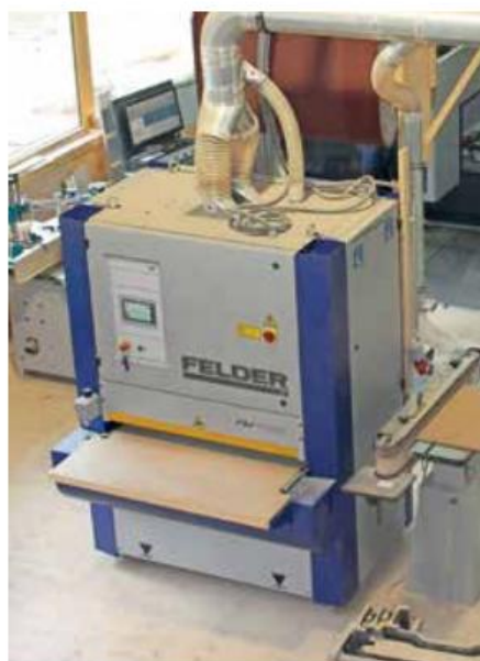
Vor- und Feinschliff erfolgen auf der Breitbandschleifmaschine FW 1102 in einem einzigen Arbeitsschritt.
