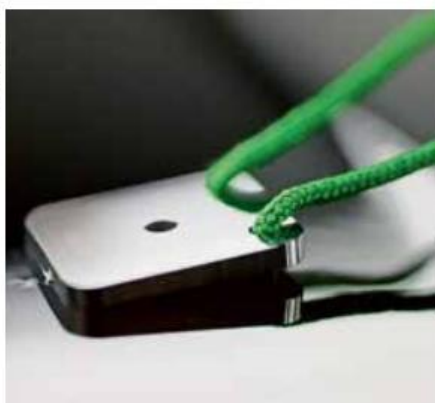
Der Durchmesser der Kordel dieser Lackziehklinge ist so bemessen, dass der Schnittwinkel zur Fläche bestmöglich und ohne Schäden zu verursachen eingehalten werden kann.
