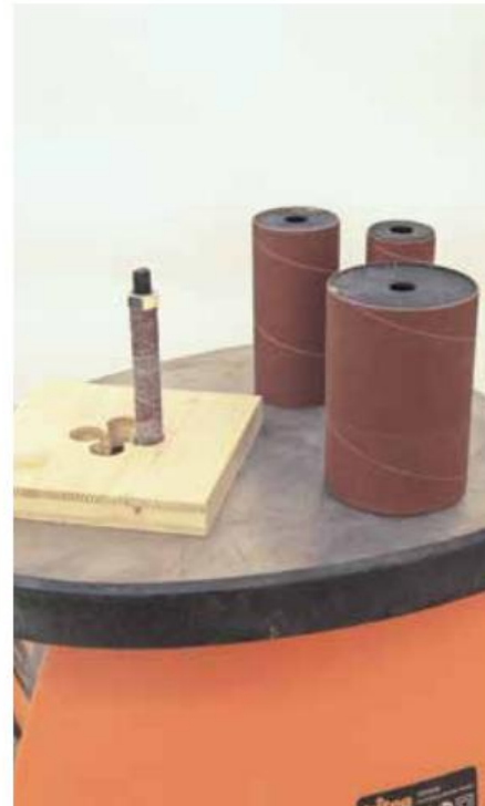
Mit Spindelschleifmaschinen (hier im Einsatz: Triton Tools) lassen sich selbst kleinste Radien schleifen. Die Oszillation verhindert ein Verbrennen des Schleifmittels.
