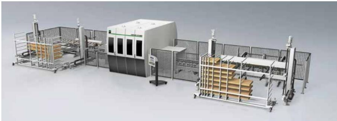
Neu beim Conturex C 125 Vario sind die Einlaufmechanisierung mit Parallelbeschickung, die vier Vario-Einzelzangentische sowie die zwei interpolierenden Fünffachs-Köpfe.
