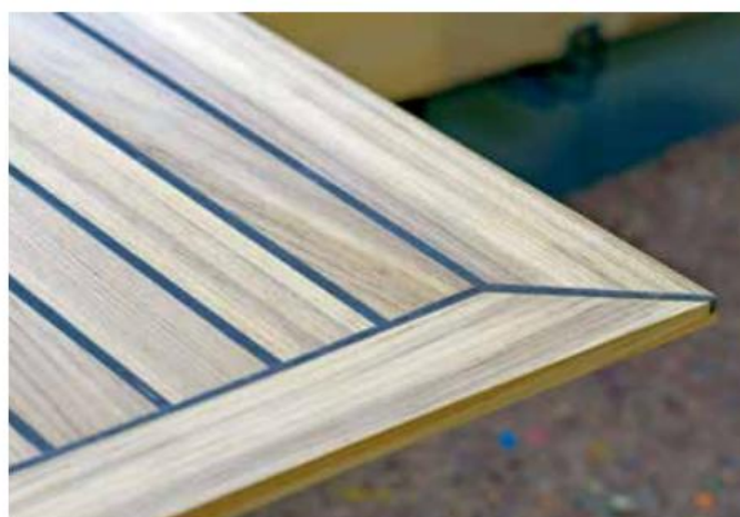
Das Diagonal-Schleifverfahren eignet sich gut, um auch quer zur Faser zu schleifen
