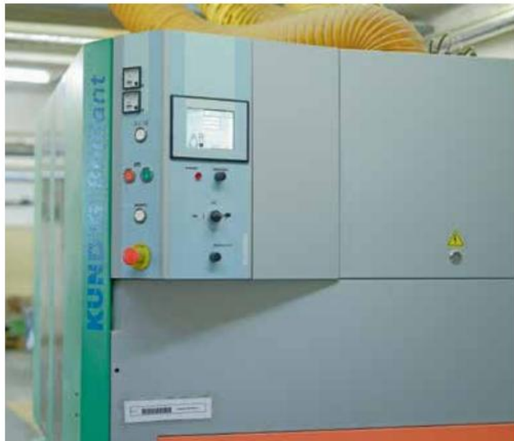
Häufig benötigte Schleifvorgänge hat man sich bei Lidauer als auf Knopfdruck abrufbare Programme hinterlegt.
