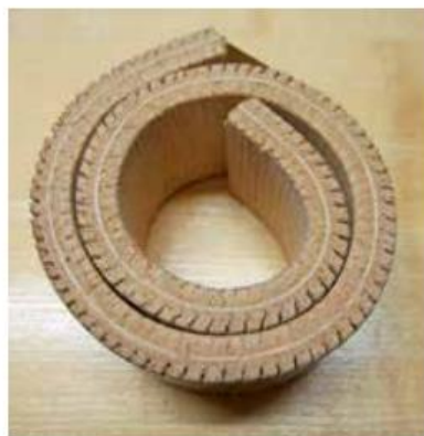
Das Biegesperrholz Flexipress ermöglicht die Umsetzung kleinster Biegeradien.
