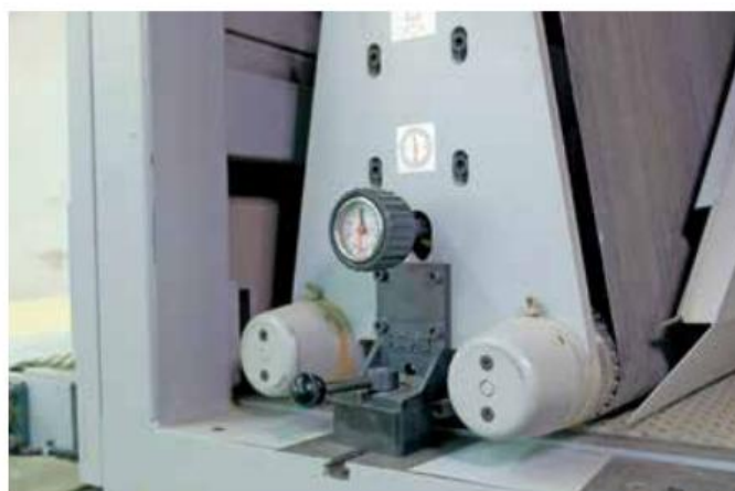
Das Diagonalschleifaggregat der Zweibandmaschine
