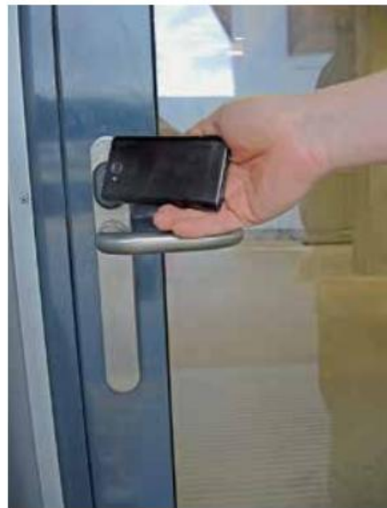
Immer mehr einbruchhemmende Türen werden mit mechatronischen Zutrittsystemen ausgerüstet. Hier (linkes Bild) öffnet ein Chip die Tür. Rechts: Zutrittsverwaltung per Smartphone. Vernetzte Systeme müssen vor Schadsoftware geschützt werden.
