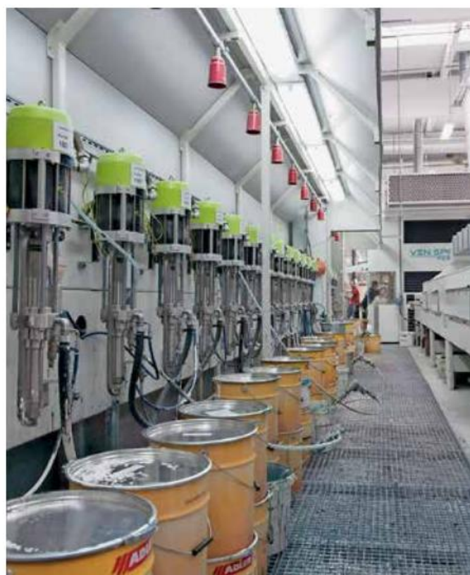
Verschiedene Lackarten werden im umweltfreundlichen, wasserbasierten Dual Cure-System mit UV-Trocknung hergestellt.
