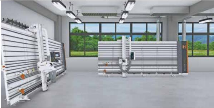
Mit den neuen vertikalen Plattensägen Sector 1255 und 1260 präsentiert Holz-Her kompakte Aufteiltechnik ab fünf Quadratmetern Aufstellfläche.
