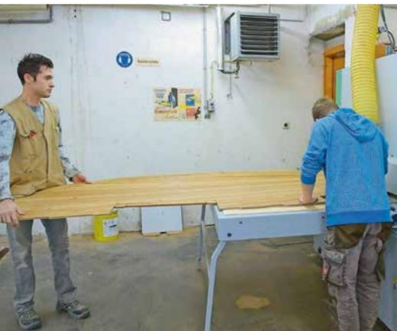
Die Segmente der Decksbeplankungen werden im Ganzen geschliffen.
