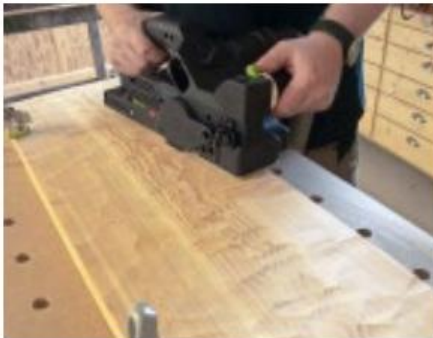
Durch punktuell aufsetzen des Hobelkopfes erhält man eine gehackte Struktur auf der Oberfläche.
