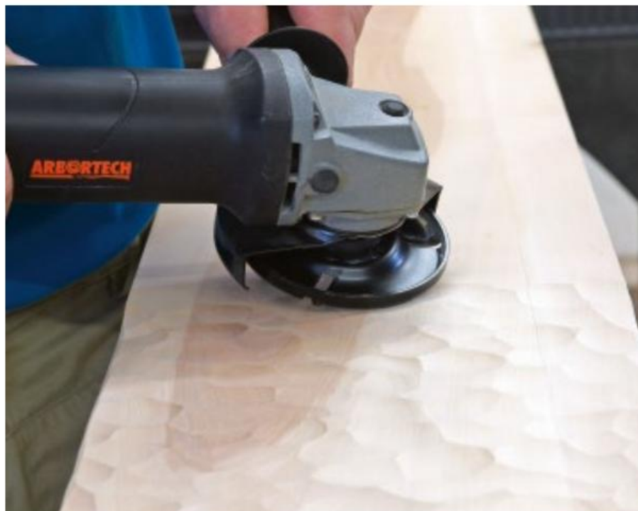
Mit der „Turboplane“-Frässscheibe gelingt das schnelle und freihändige Bearbeiten von Hart- und Weichholz. Durch ihre flächigen Schneiden ist die Scheibe gut kontrollierbar.
