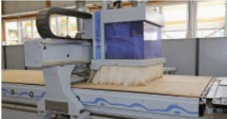
Das Schneiden, Fräsen und Bohren der Möbelteile wird in einem Arbeitsschritt auf einer Nesting-Maschine erledigt.
