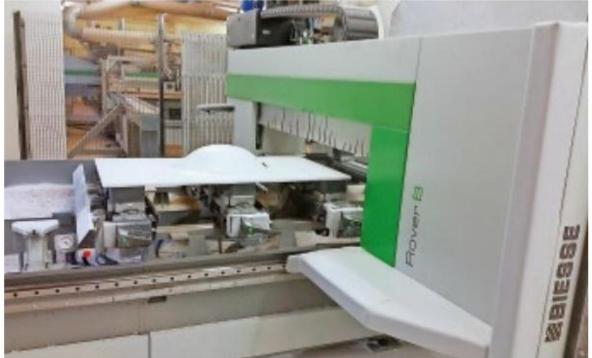
Die neue Rover B 1638 ist die dritte CNC-Maschine bei Standfest. Gefräst wird darauf vorwiegend Acrylstein für die Waschtische.
