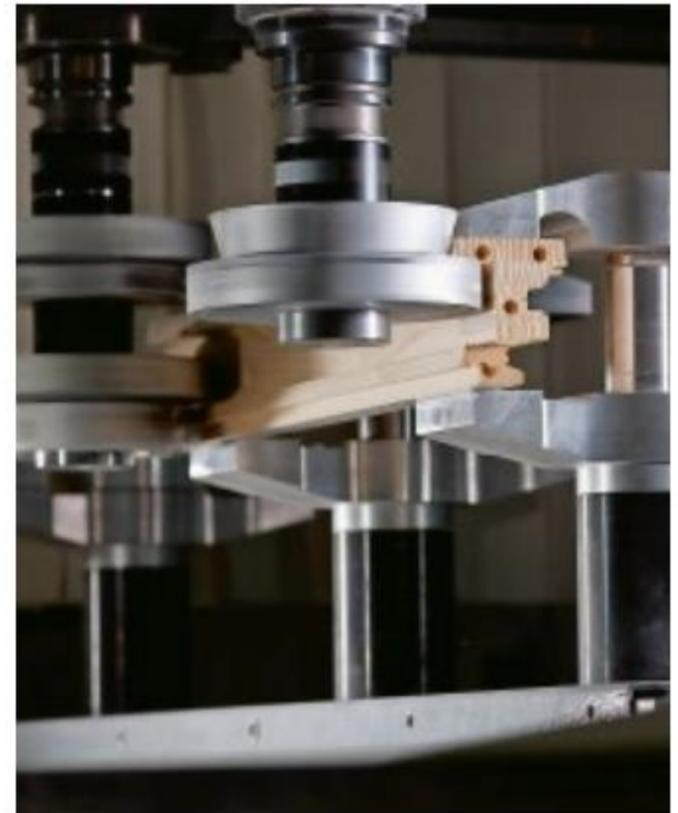
**Bei den neuen powerProfiler-Modellen können in einem Längsfräsdurchgang gleichzeitig zwei Profilfräser an einem Werkstück eingesetzt werden.**
