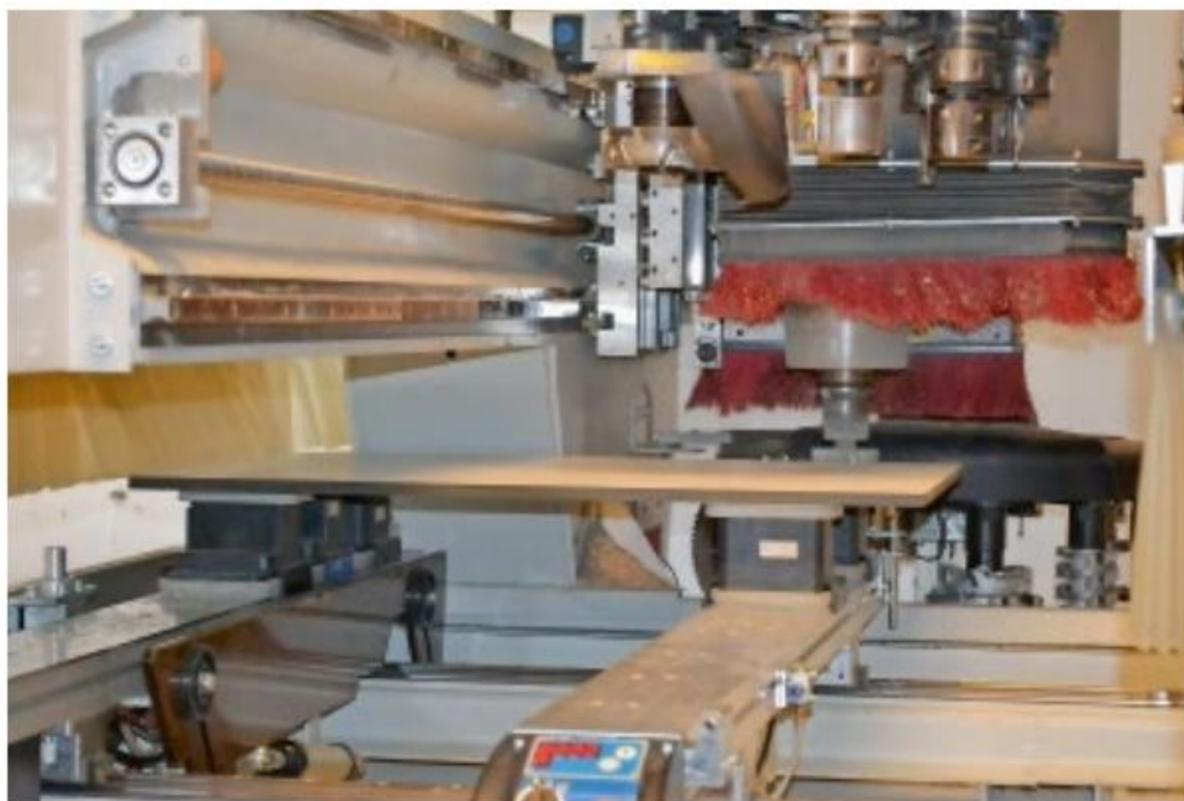
Für die Bearbeitung der Kompaktplatten kommen diamantbestückte Werkzeuge zum Einsatz.
